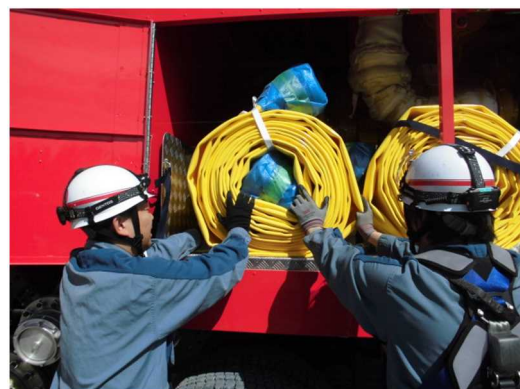
大容量送水車（原子炉建屋放水設備用）取水ポンプ用ホース
