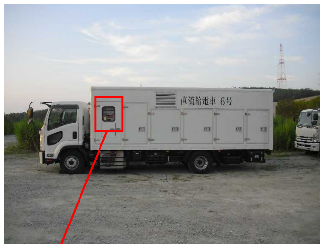
直流給電車操作部
