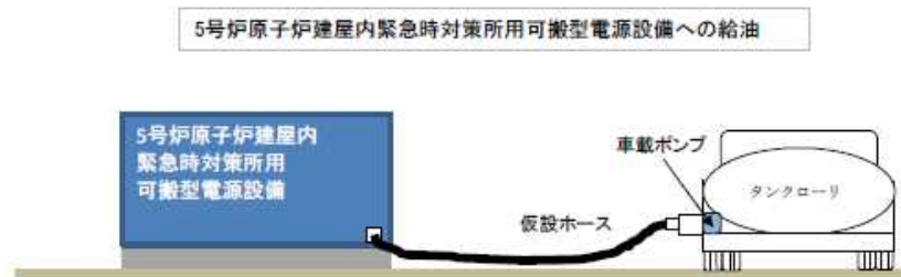
第 1.18.29 図 5号炉原子炉建屋内緊急時対策所用可搬型電源設備 への燃料給油概略系統図
