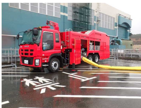
[海を水源とした場合] 大容量送水車 (海水取水用) (タービン建屋周辺)
