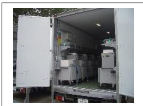
① 可搬型モニタリングポストの運搬
