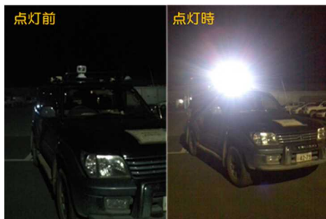
業務車両へのサーチライト設置 （福島第一原子力発電所）
