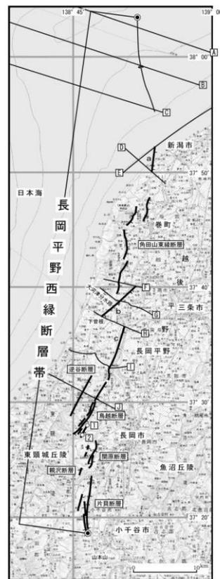
■ 一方、地震本部(2004)によると、長岡平野西縁断層帯は、北から、新潟市沖合と日本海沿岸付近の断層及び角田山東縁断層（角田・弥彦断層）、鳥越断層（気比ノ宮断層）、逆谷断層、関原断層（上富岡断層）、親沢断層及び片貝断層から構成され、その長さは約83kmとされている。
