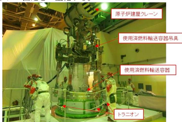
第1図 使用済燃料輸送容器吊具の現場での使用状況
