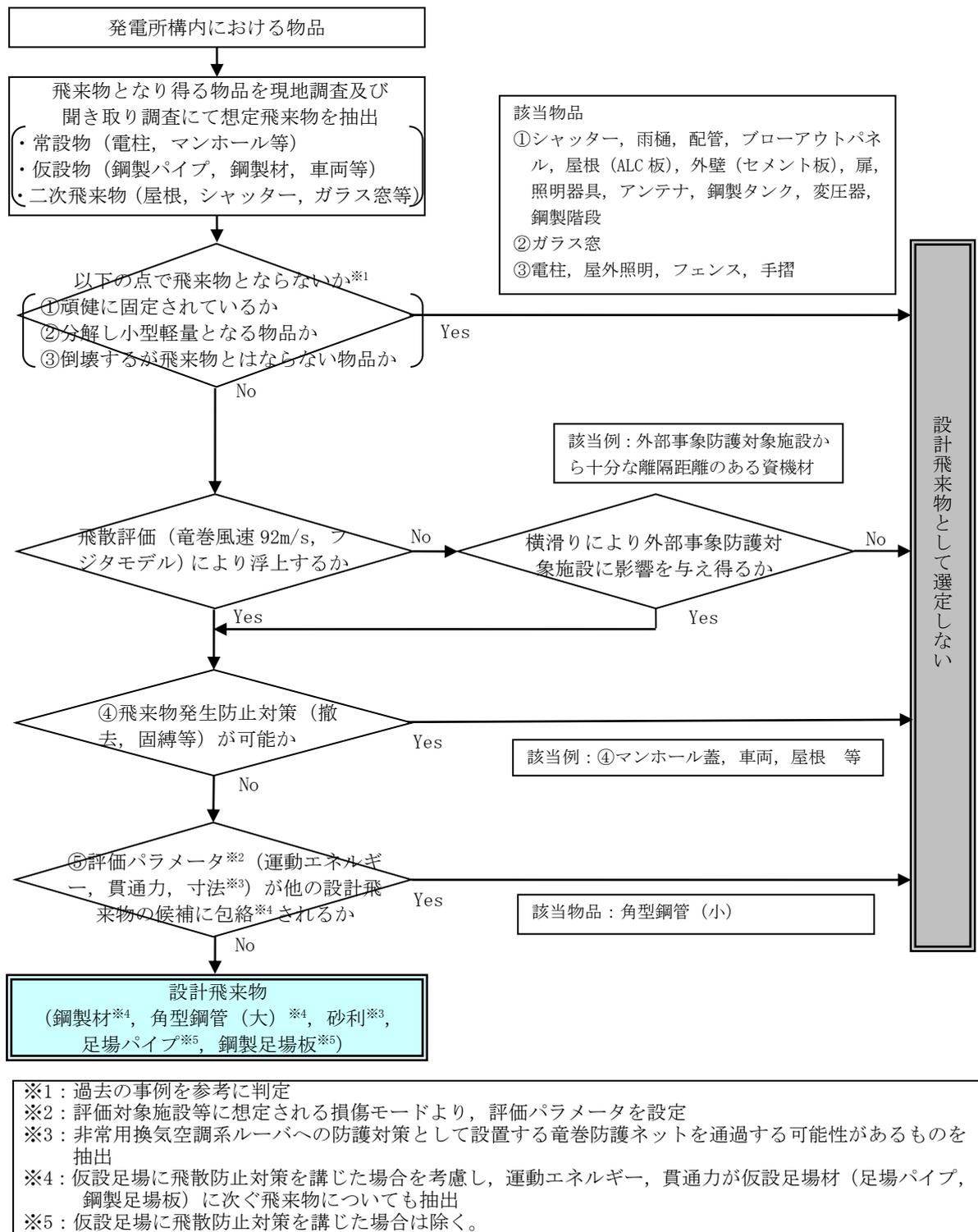
図 3.3.1.1 設計飛来物の選定フロー
