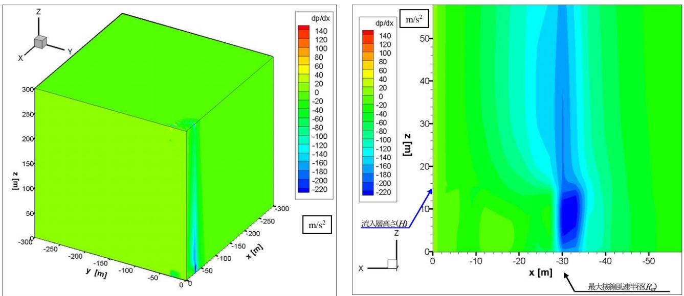
図4 最大接線風速  $V_{tm}=78\text{m/s}$  における Fujita モデルの圧力 (空気密度で除したもの) の x-方向空間微分値 (左: 全体図, 右: y 方向からの拡大図, 最大値  $163.3\text{m}/\text{s}^2$ , 最小値  $-240.2\text{m}/\text{s}^2$ )
