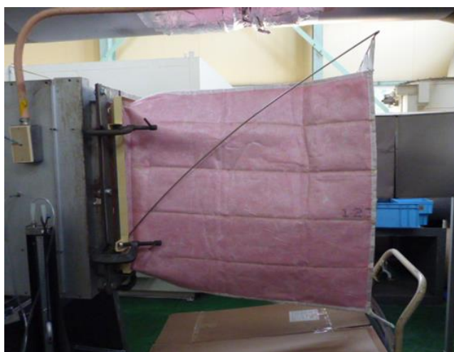
図7-2 バグフィルタの耐荷重試験の様子
