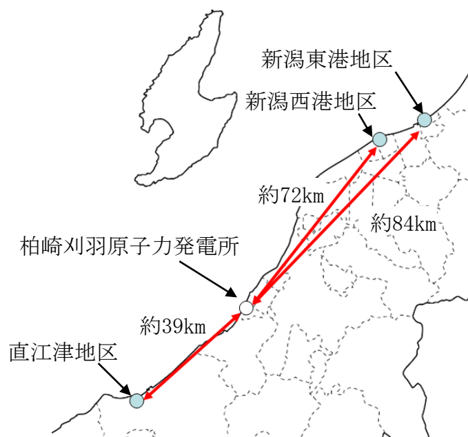
第 2.2.2.1-1 図 新潟県内の石油コンビナート等特別防災区域の位置と柏崎刈羽原子力発電所までの距離
