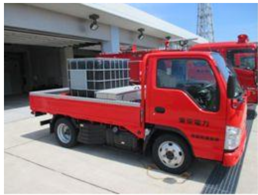
泡消火薬剤備蓄車
