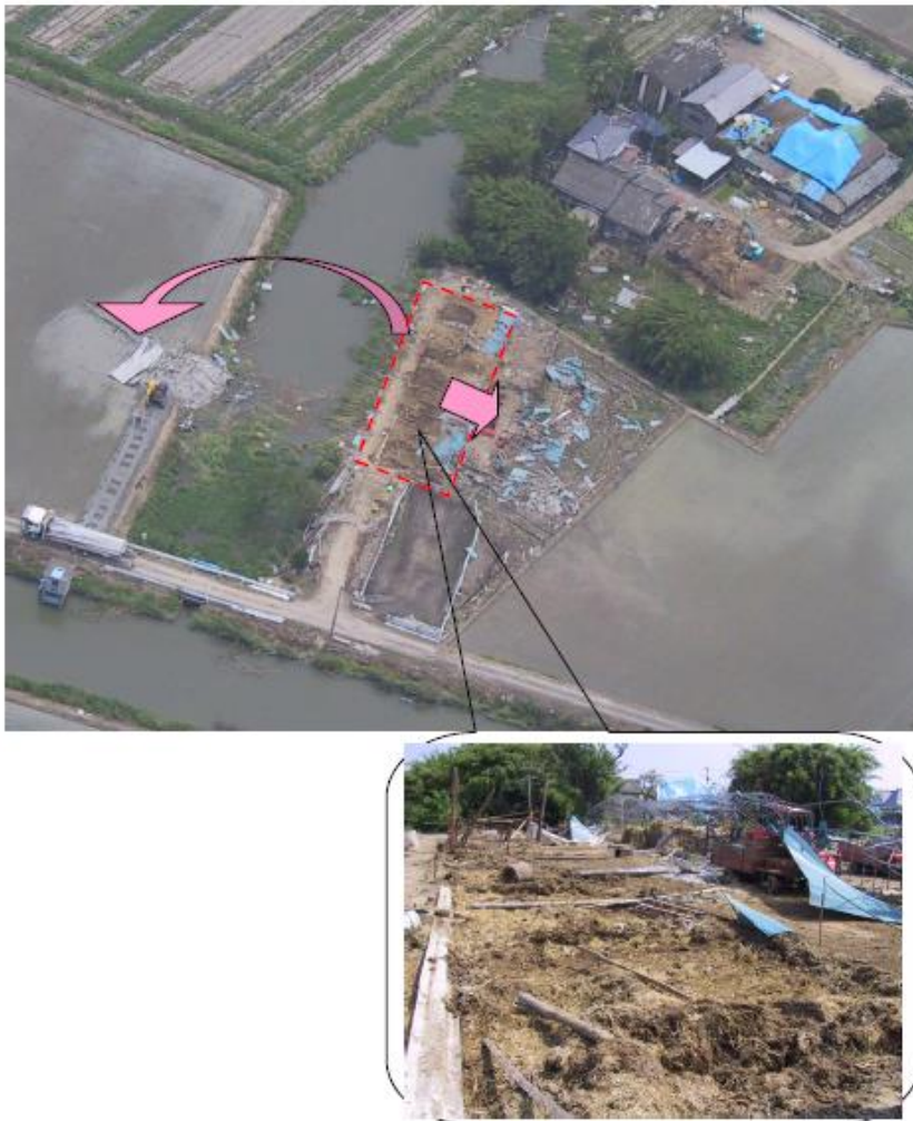
牛舎の屋根東方向，柱・トタン板は西方向に飛散している
