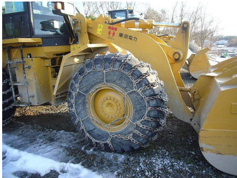
図 3-3 重機の凍結路面の滑り防止対策
