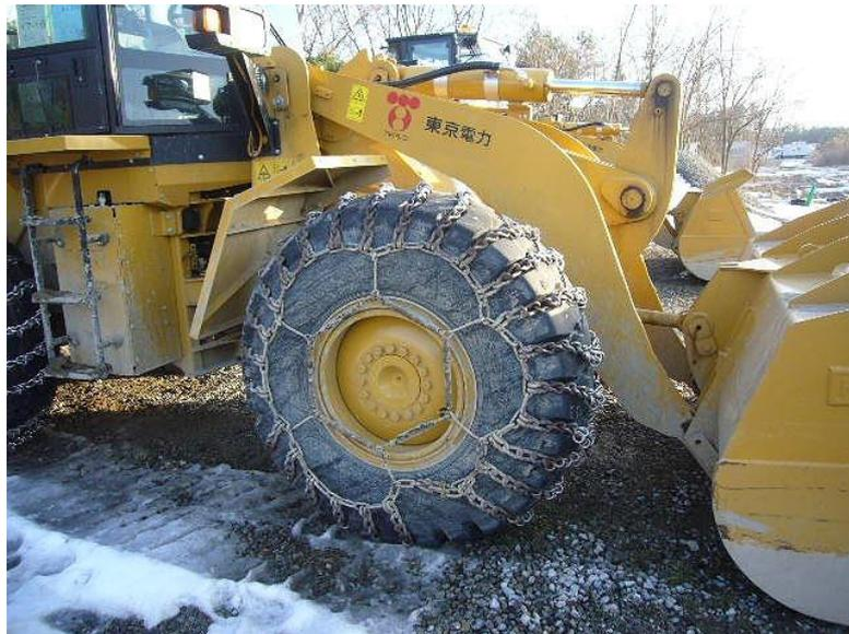
図 3-3 重機の凍結路面の滑り防止対策
