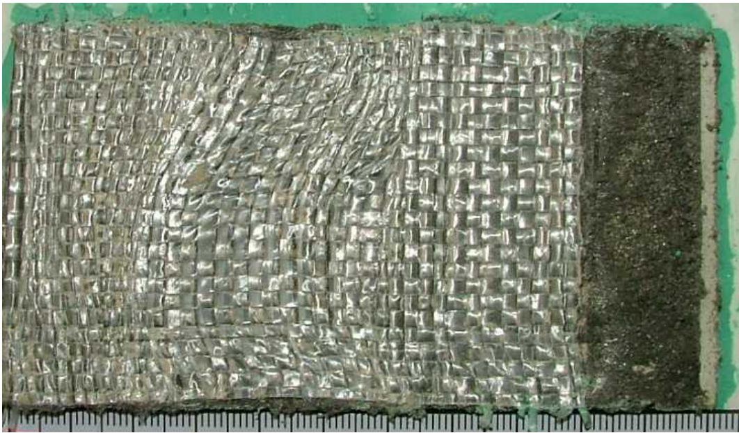
第 3.4.7 図 スケール影響試験後の供試体状況 ケース 2-3 (保護層表面)
