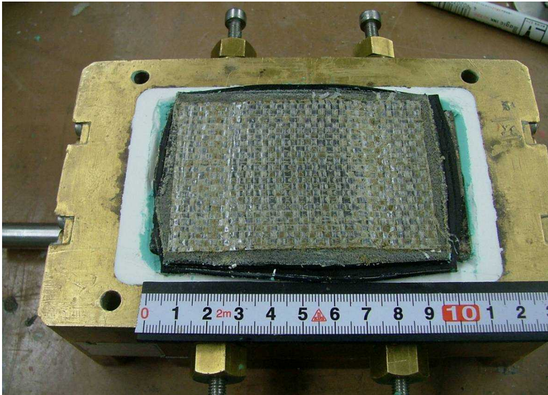
第 3.3.19 図 繰返し载荷試験後の供試体状況 ケース 1-8 (保護層表面)
