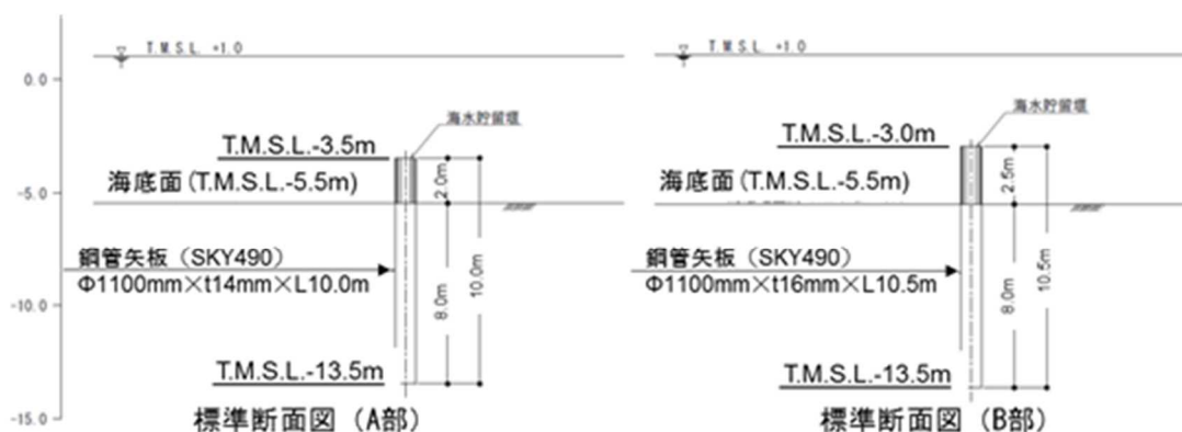
添付第 28-2 図 海水貯留堰の断面図
