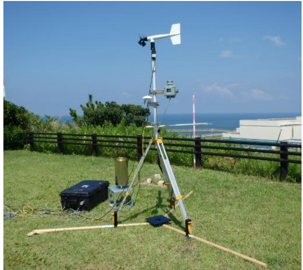
第 2.3.3-1 図 可搬型モニタリングポスト（左），可搬型気象観測装置（右）
