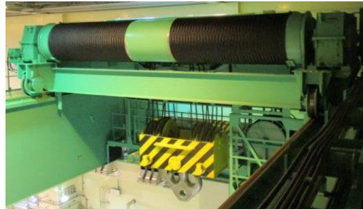
二重ドラム方式の巻上げ機
