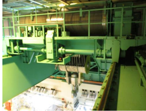
二重ドラム方式の巻上げ機
