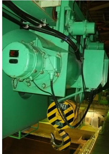
第 5.2.30 図 過巻防止用リミットスイッチ（補助ホイスト巻上装置）（6号炉）
