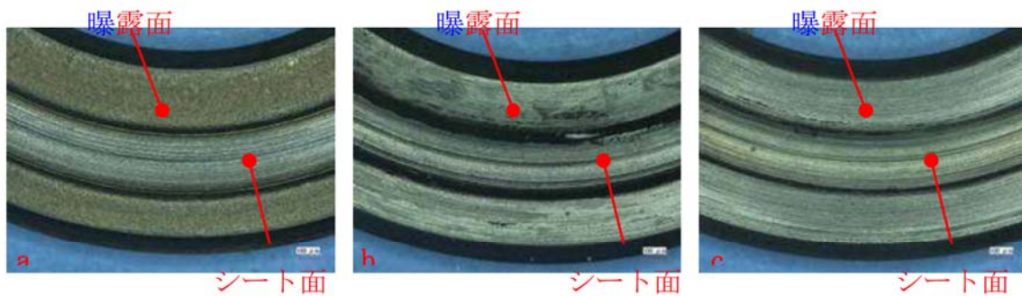
図7 試験後外観観察結果 (a: 乾熱 200°C, 168h, b, c: 蒸気 250°C, 168h)
