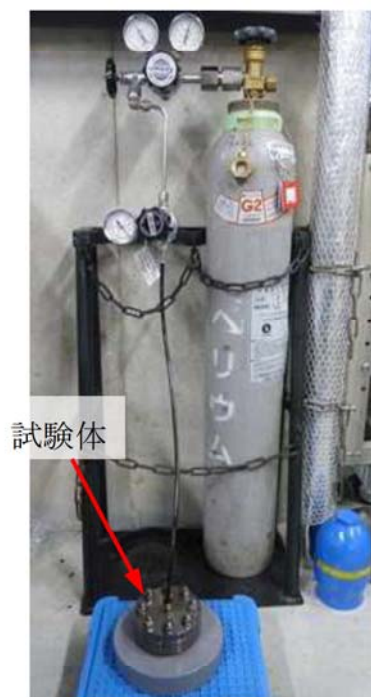
図5 He 気密確認試験状況
