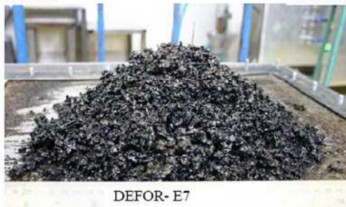
付図 3-6 DEFOR-E 実験後のデブリ状態 [16]
