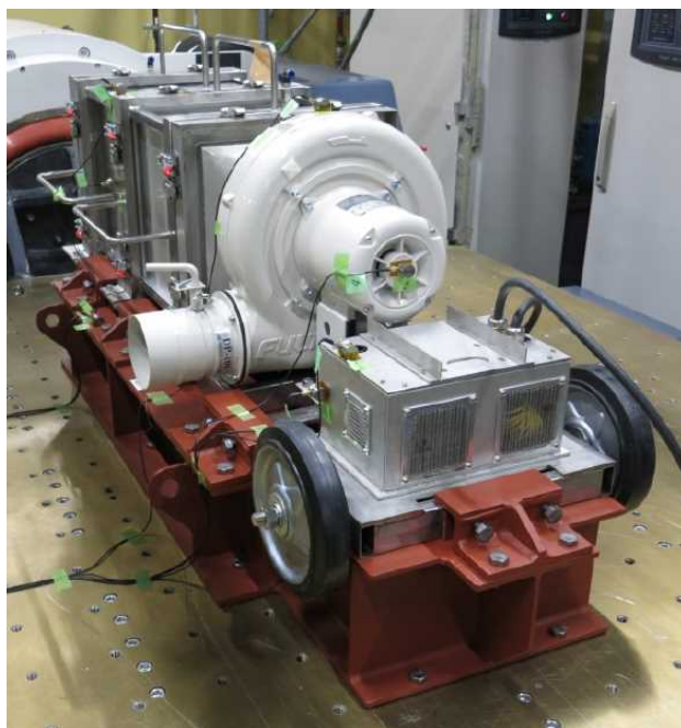
図4-3 5号炉原子炉建屋内緊急時対策所（対策本部）可搬型陽圧化空調機，可搬型外気取入送風機 設置状態外観 （可搬型外気取入送風機はフィルタユニット無し）
