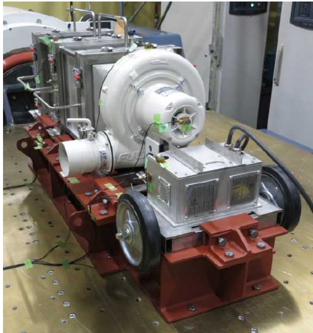
図 4-12 5号炉原子炉建屋内緊急時対策所（待機場所） 可搬型陽圧化空調機保管状態外観
