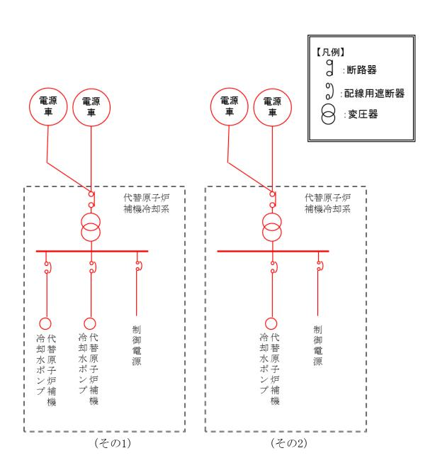
図3 代替原子炉補機冷却系 単線結線図 (6号炉 (7号炉も同じ))
