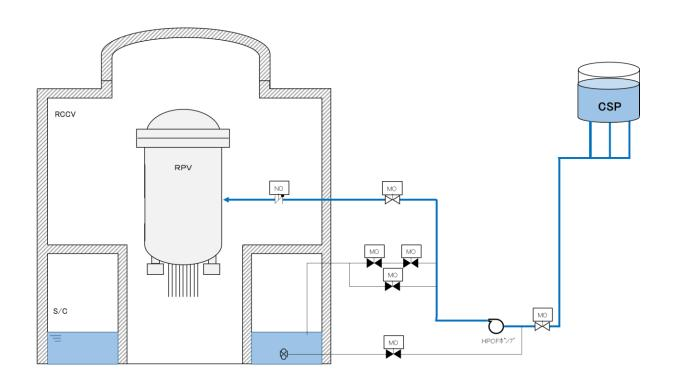
図4 高圧炉心注水系 設備概要 (柏崎刈羽原子力発電所7号炉の例)
