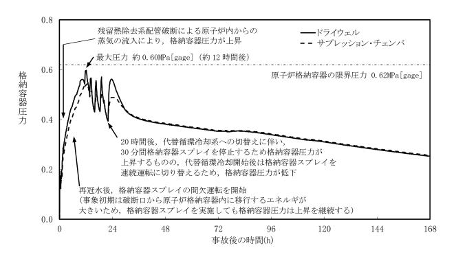
図 52-8-6 格納容器過圧・過温破損(代替循環冷却系を使用する場合) の格納容器内圧力の推移
