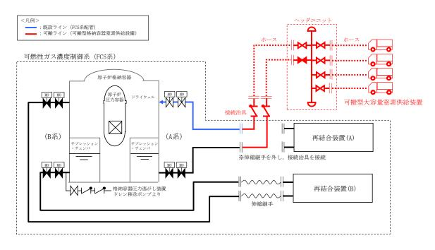
図 52-12-1 可搬型格納容器窒素供給設備 系統概要図
