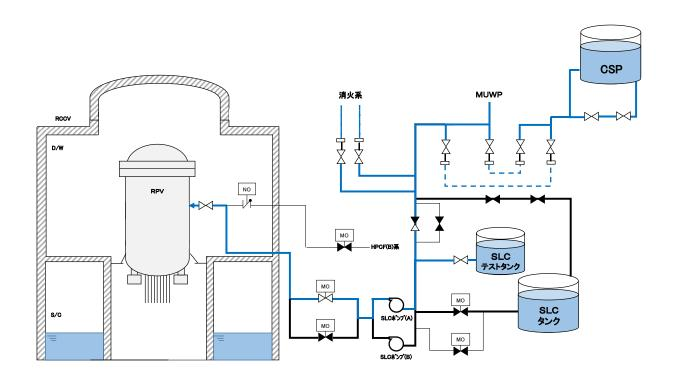
図 6 ほう酸水注入系ポンプによる原子炉圧力容器への注水 設備概要 (柏崎刈羽原子力発電所 7 号炉の例)
