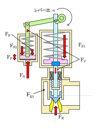
図2 逃がし安全弁 機構概要図
