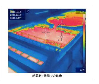
図 15 可視カメラと赤外線カメラの状態監視及び結露発生状態での状態監視
