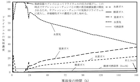
図 52-8-1 ドライウェルの 気相濃度の推移(ウェット条件)
