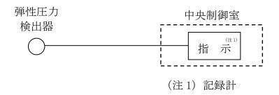
図 50-3-5 フィルタ装置出口圧力の概略構成図
