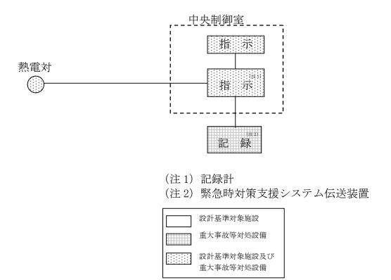
図1 使用済燃料貯蔵プール水位 (SA 広域) の概略構成図
