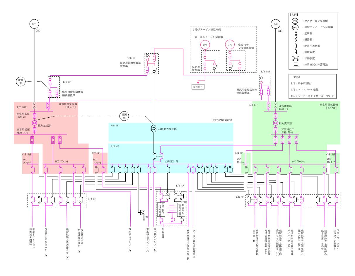
図 50-2-3 代替循環冷却系の単線結線図 (非常用電気設備経由で電源供給時)
