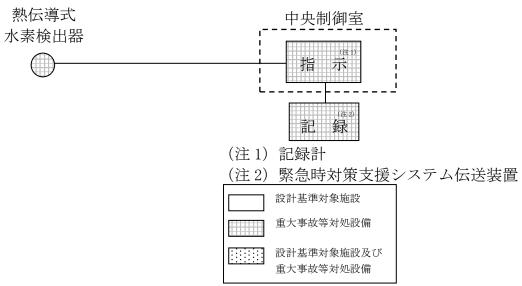
図3 原子炉建屋水素濃度の概略構成図
