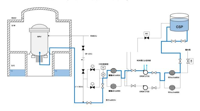
図 7 制御棒駆動水系ポンプによる原子炉圧力容器への注水 設備概要 (柏崎刈羽原子力発電所 7 号炉の例)
