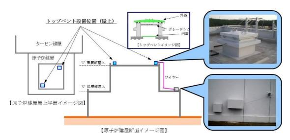
図3 原子炉建屋トップベント設備 概要図
