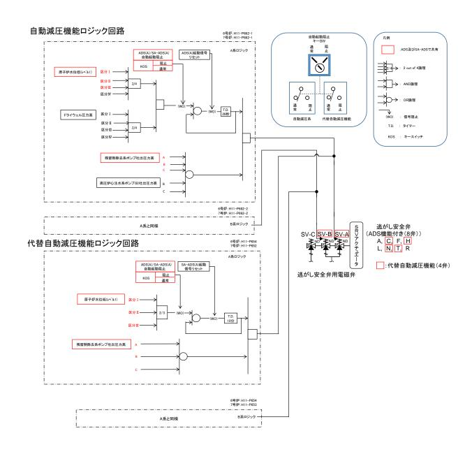
図1 自動減圧系及び代替自動減圧機能の論理回路
