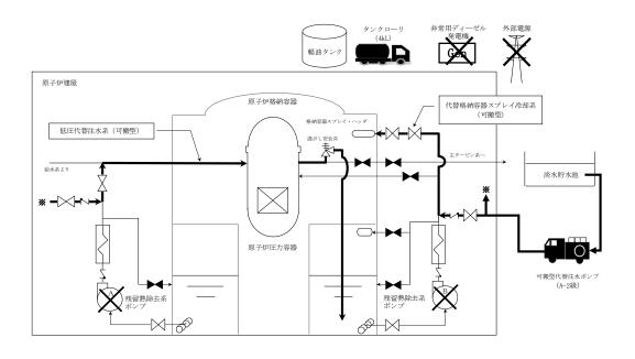
図1 「全交流動力電源喪失(外部電源喪失+DG 喪失)+SRV 再閉失敗」の 重大事故等対策の概略系統図 (原子炉注水及び原子炉格納容器冷却)
