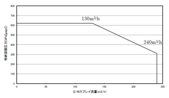
図4 ドライウェルスプレイ注水特性(ペデスタル 50m³/h 同時注水時)
