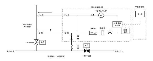
図 50-3-8 フィルタ装置水素濃度 システム概要図 (出口配管側も同様)
