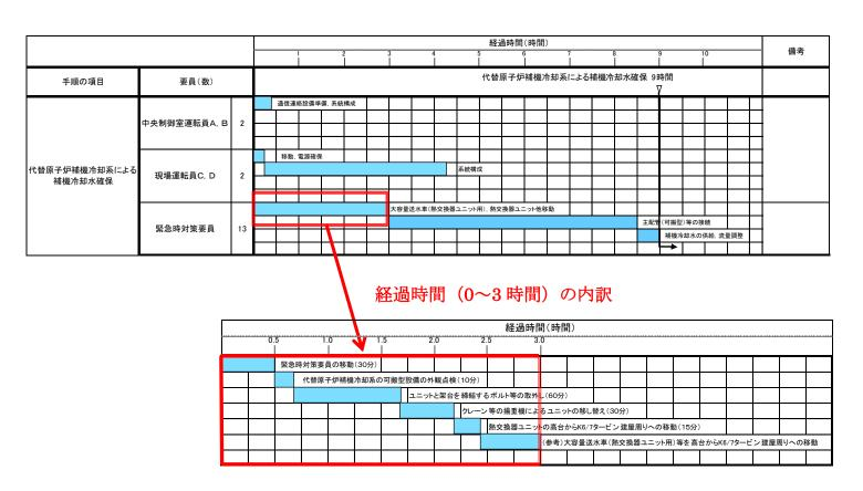
図 48-12-2 転倒防止措置を考慮したタイムチャート (代替原子炉補機 冷却系による補機冷却水確保)の内訳
