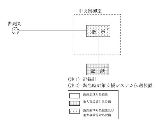
図 2 使用済燃料貯蔵プール温度 (SA 広域) の概略構成図
