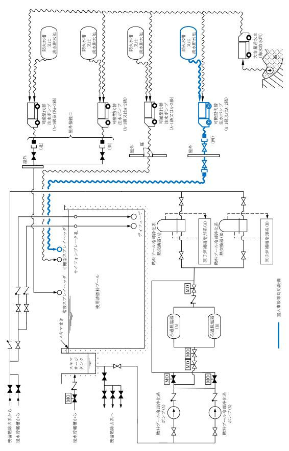
図1 燃料プール代替注水系 (可搬型スプレイヘッダ) 使用済燃料プールへ注水する場合の系統概要図
