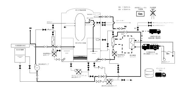
図3 格納容器破損モード「高圧溶融物放出/格納容器雰囲気直接加熱」時の 重大事故等対処設備の概略系統図 (代替循環冷却による溶融炉心冷却,原子炉格納容器除熱)
