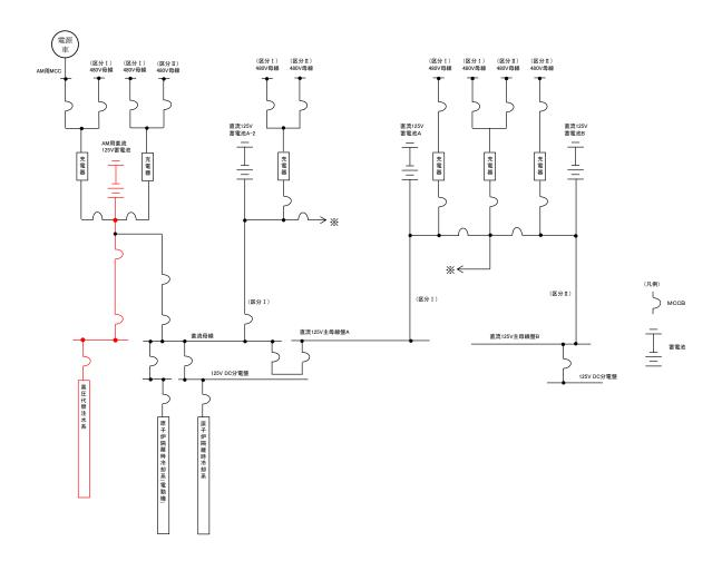
図3 7号炉 高圧代替注水系 単線結線図
