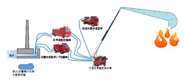
図 8-1 大型化学高所放水車による泡消火
