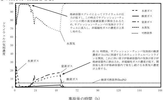
図 52-8-3 G 値を設計基準事故ベースとした場合のドライウェルの気相濃度の推移 (ウェット条件)
