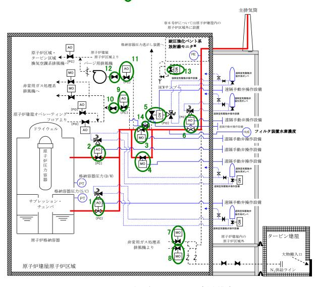
図 48-5-5 耐圧強化ベント系 概略構成図
