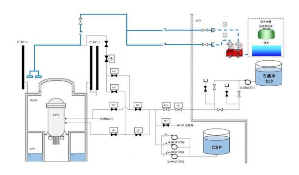
図1 格納容器頂部注水系 概要図
