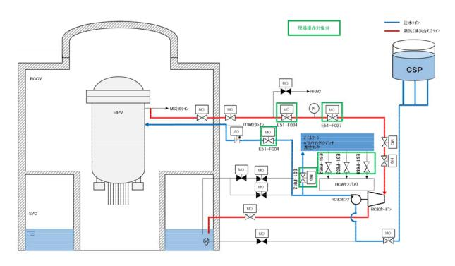
図2 原子炉隔離時冷却系(7号炉の例)系統概要
