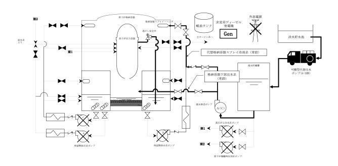
図 2 格納容器破損モード「高圧溶融物放出/格納容器雰囲気直接加熱」時の 重大事故等対処設備の概略系統図 (原子炉圧力容器の破損後の原子炉減圧,原子炉格納容器冷却及び 格納容器下部注水)
