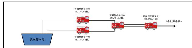
図2 燃料プール代替注水系(常設スプレイヘッダ)によるスプレイ 系統概要図
