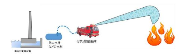
図8-2 化学消防自動車による泡消火
