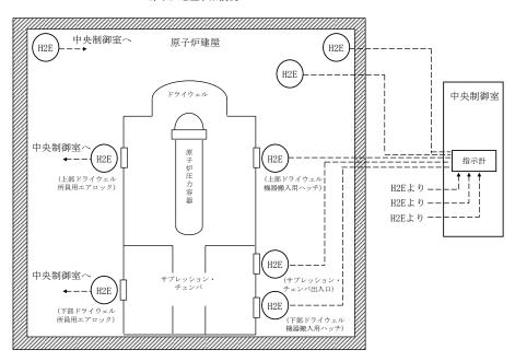
図2 原子炉建屋水素濃度の系統概要図
