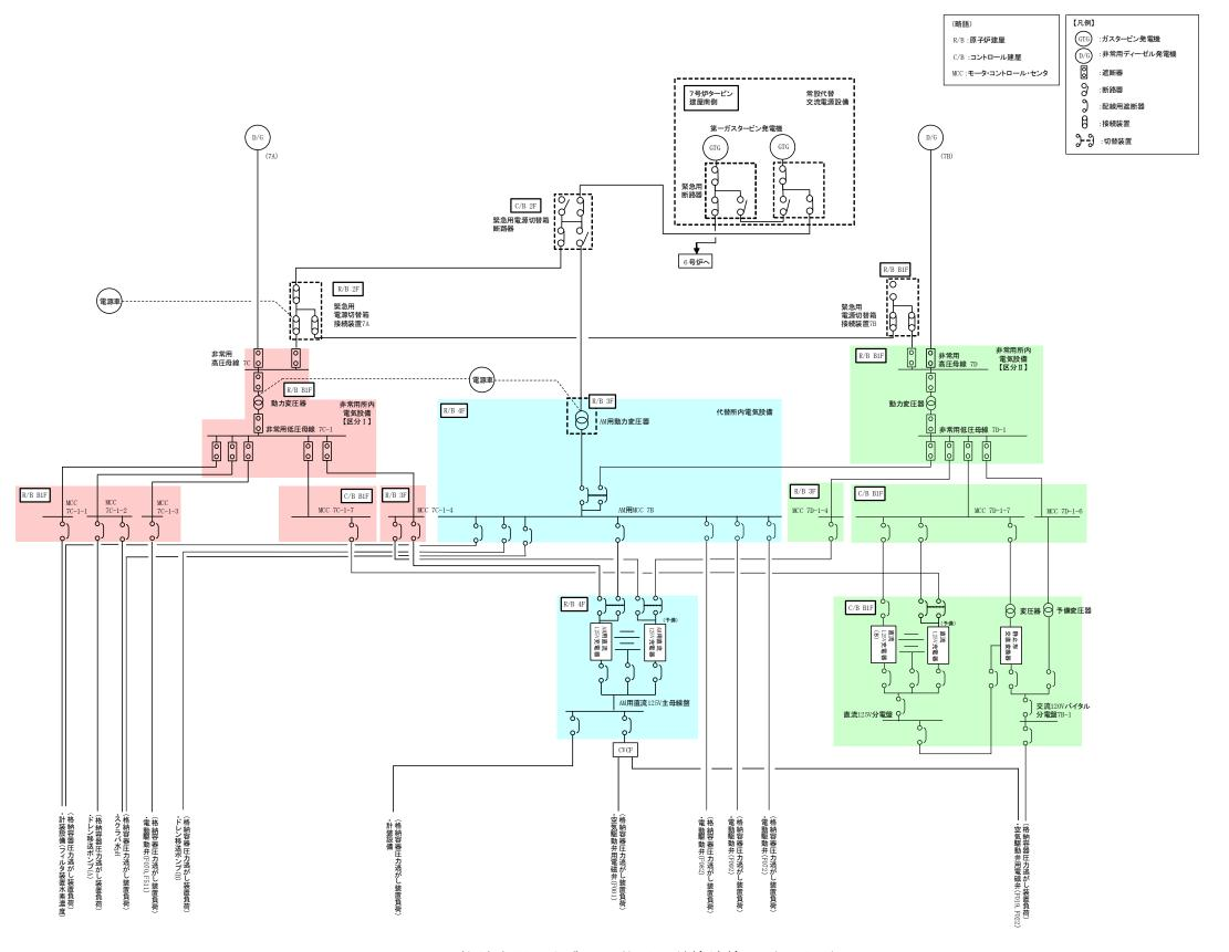
図 50-2-2 格納容器圧力逃がし装置 単線結線図 (7号炉)
