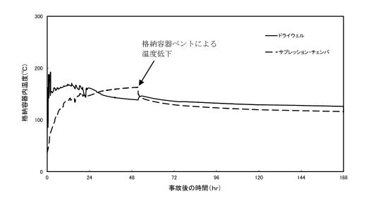
図 52-6-2 原子炉格納容器温度推移 (大 LOCA+SB0+全 ECCS 機能喪失, 代替循環冷却系使用)
