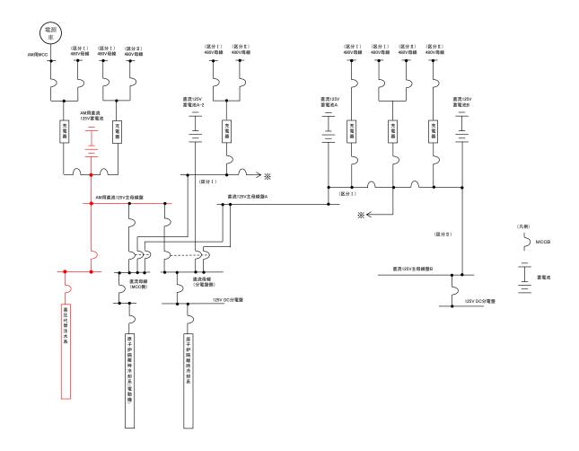
図1 6号炉 高圧代替注水系 単線結線図
