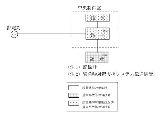
図 22 使用済燃料貯蔵プール水位(SA 広域)の概略構成図
