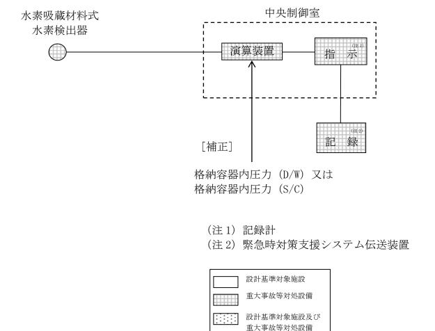
図 52-6-6 格納容器内水素濃度 (SA) の概略構成図
