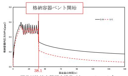
図 50-7-5 原子炉格納容器圧力推移(大 LOCA+SBO+全 ECCS 機能喪失)
