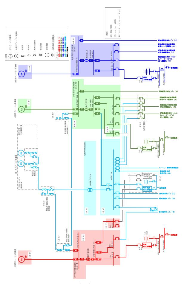
図1 単線結線図(6号炉)
