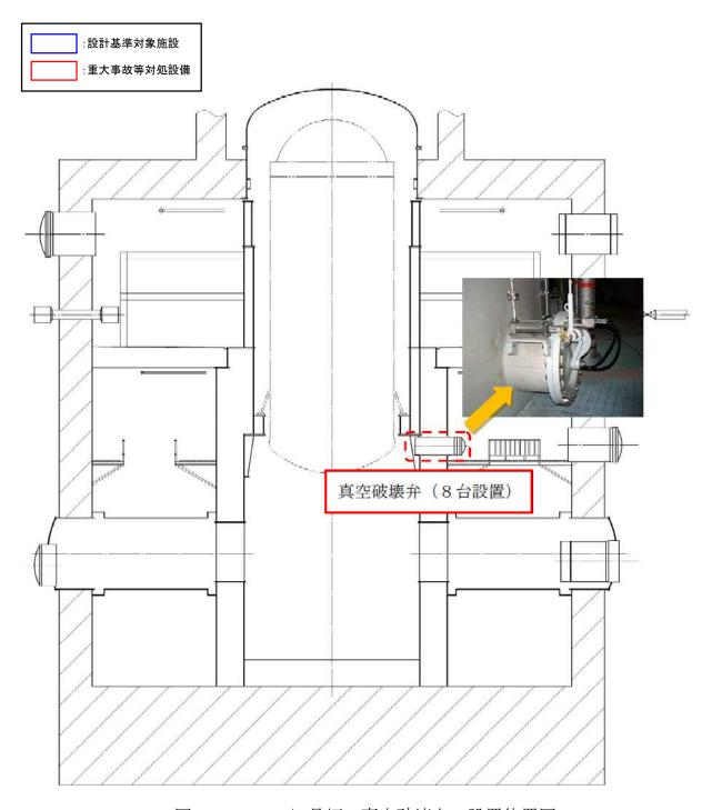
図 48-4-32 6/7 号炉 真空破壊弁 設置位置図
