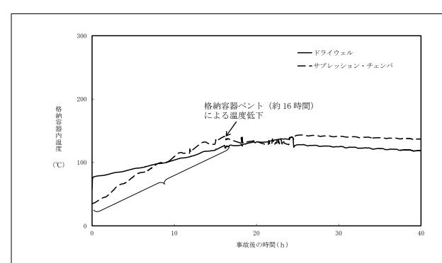
図 48-7-9 原子炉格納容器温度推移(全交流動力電源喪失)
