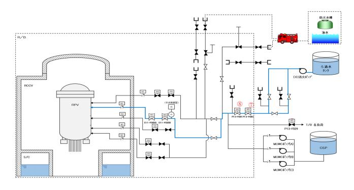
図4 消火系による原子炉圧力容器への注水 (残留熱除去系(B)注入配管使用) 手順の概要図 (7 号炉の例)
