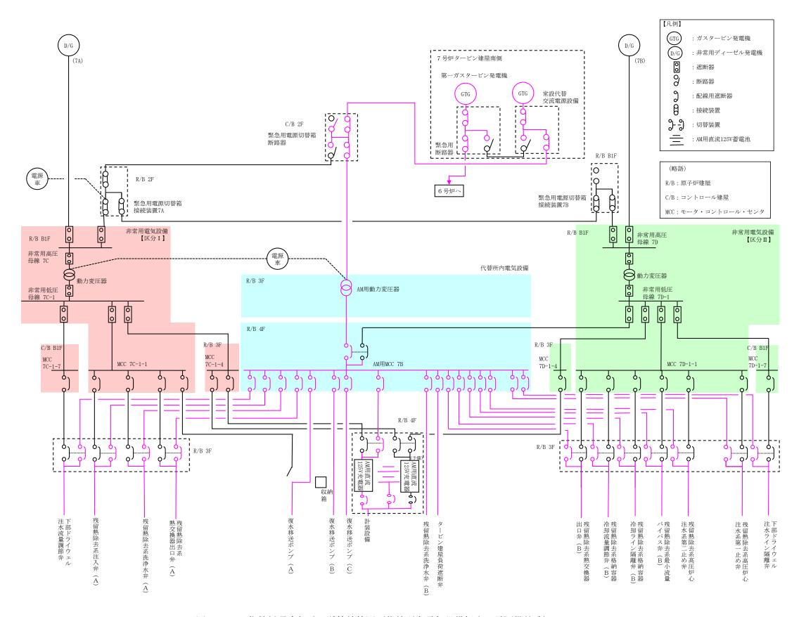
図 50-2-4 代替循環冷却系の単線結線図(代替所内電気設備経由で電源供給時)
