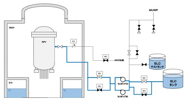
図5 ほう酸水注入系 設備概要 (柏崎刈羽原子力発電所7号炉の例)
