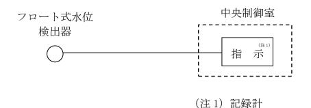
図 50-3-14 ドレンタンク水位の概略構成図
