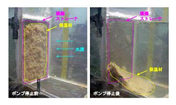
図 50-11-7 ポンプ停止により模擬ストレーナから試験体が剥がれ落ちた試験 (April 2004, LANL, GSI-191: Experimental Studies of Loss-of-Coolant-Accident-Generated Debris Accumulation and Head Loss with Emphasis on the Effects of Calcium Silicate Insulation)
