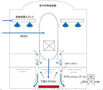
図 50-11-6 RPV 破損後の循環冷却による冷却の流れ
