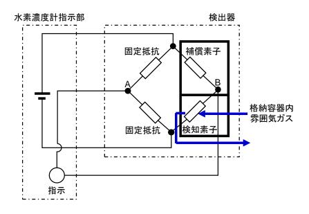
図 52-7-2 水素濃度計検出回路の概要図
