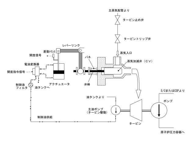
図1 原子炉隔離時冷却系蒸気加減弁廻り制御油系 系統概要
