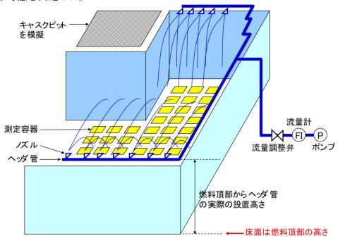
図 11 試験設備概要図
