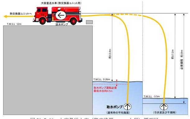
図 50-7-20 大容量送水車(熱交換器ユニット用)概要図
