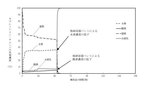
図 52-6-4 原子炉格納容器 (サプレッション・チェンバ) 気相濃度 (大 LOCA+SBO+全 ECCS 機能喪失, 代替循環冷却系使用)
