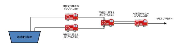
図 5 燃料プール代替注水系(常設スプレイヘッダ)によるスプレイ 系統概要図
