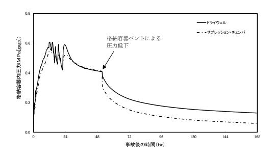
図 52-6-1 原子炉格納容器圧力推移 (大 LOCA+SBO+全 ECCS 機能喪失,代替循環冷却系使用)
