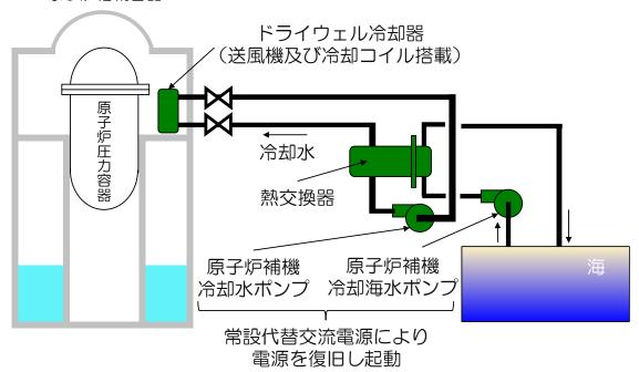
図2 ドライウェル冷却系による原子炉格納容器からの除熱 概略図
