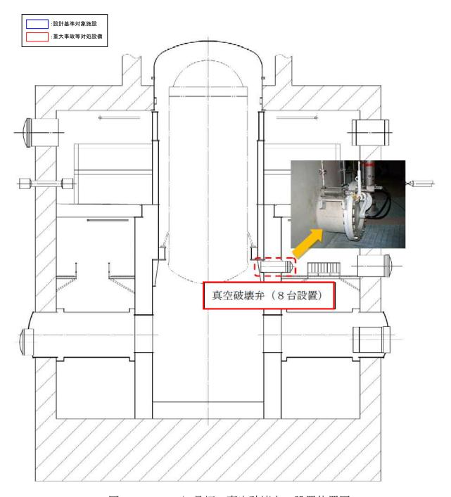
図 50-4-19 6/7 号炉 真空破壊弁 設置位置図
