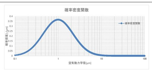
図 50-7-7 エアロゾル粒径分布(高圧・低圧注水機能喪失, D/W ベント)
