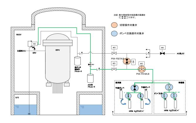
図4 高圧窒素ガス供給系系統概要図 (6号炉)
