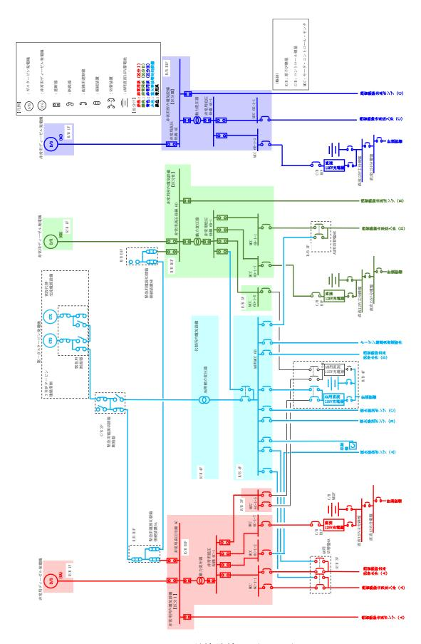
図1 単線結線図(6号炉)
