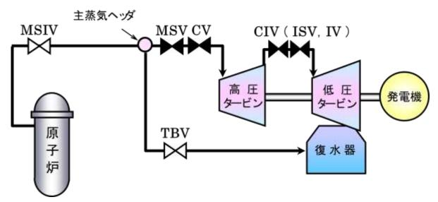
図1 タービン制御系 概要図
