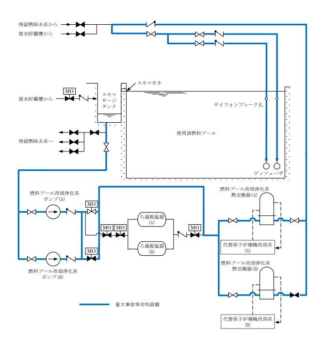
図 5 燃料プール冷却浄化系 系統概要図(A 系を使用した場合)
