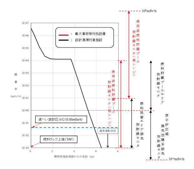
図11 水位と放射線線量率の関係(7号炉)
