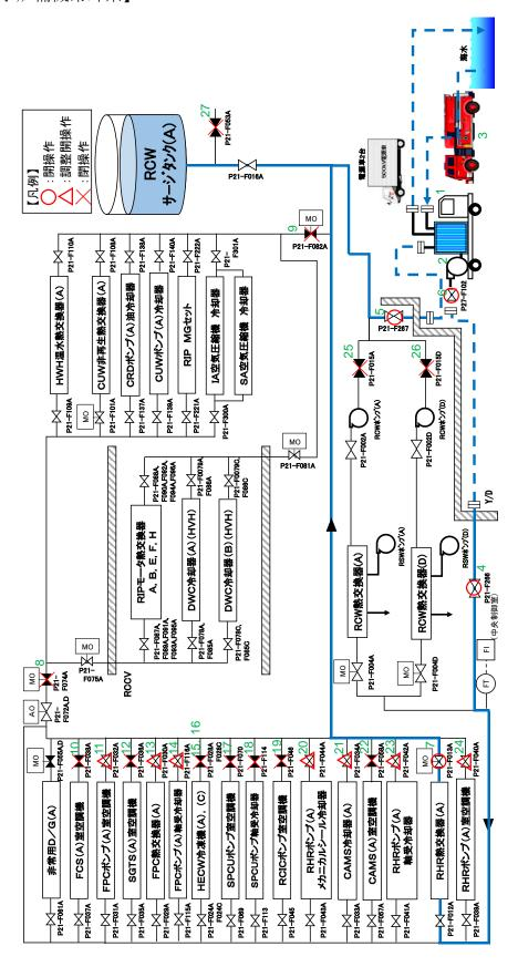
図 48-5-1 代替原子炉補機冷却系 系統概要図 (6 号炉 A 系)
