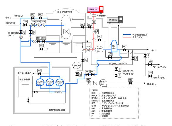
図 50-11-10 残留熱除去系吸込ストレーナ逆洗操作の系統構成について
