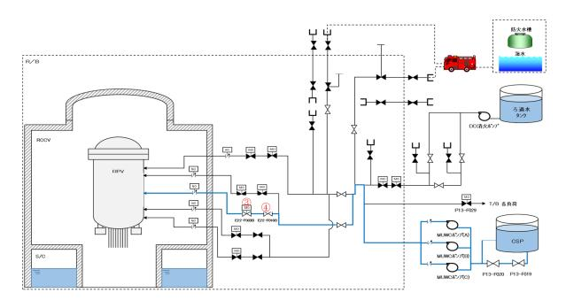
図2 低圧代替注水系(常設)による原子炉圧力容器への注水 (高圧炉心注水系(B)注入配管使用)手順の概要図(7号炉の例)
