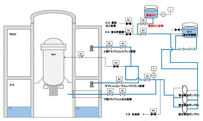
図 50-11-1 格納容器 pH 制御設備 系統概要図
