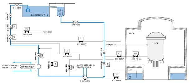
図2 残留熱除去系 (燃料プール冷却モード) 系統概要 (6 号炉の例)
