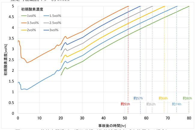
図 52-8-5 格納容器過圧・過温破損(代替循環冷却系を使用する場合) の格納容器内酸素濃度変化
