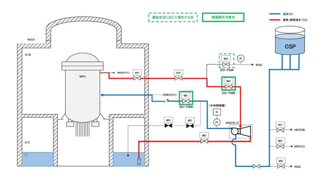
図1 高圧代替注水系(7号炉の例)系統概要
