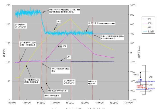
図2 高温状態の試験結果
