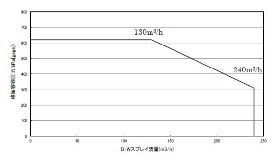
図3 ドライウェルスプレイ注水特性 (ペデスタル 50m³/h 同時注水時)
