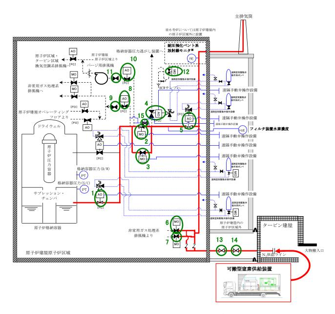
図 52-4-1 耐圧強化ベント系 系統概略図
