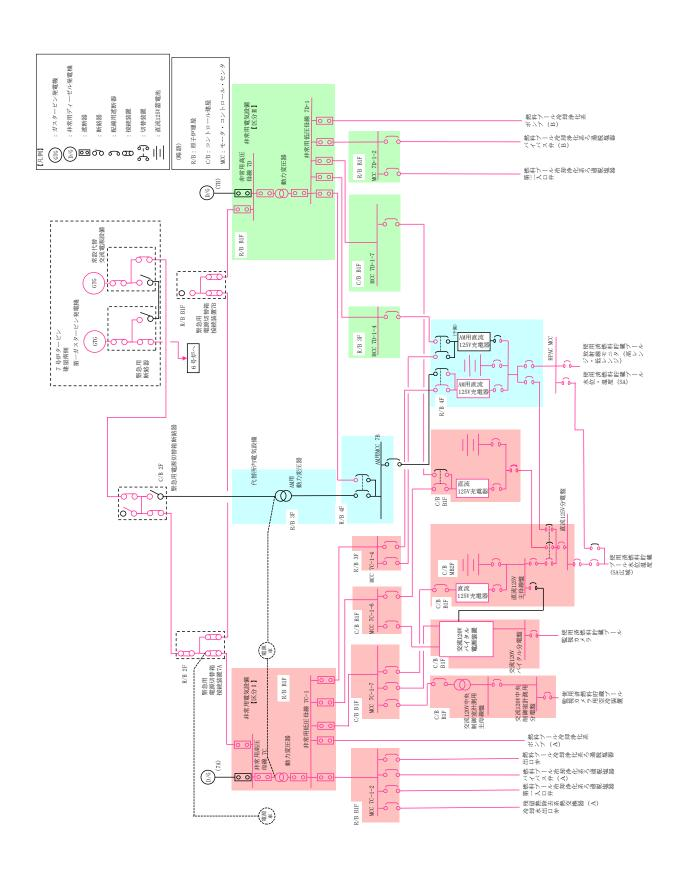
図2 使用済燃料プール監視設備 単線結線図 (7号炉)
