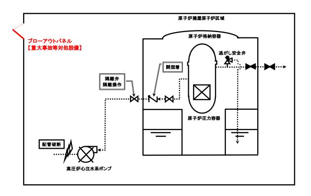
図 6 原子炉建屋ブローアウトパネルの概略系統図 (インターフェイスシステム LOCA 発生時)
