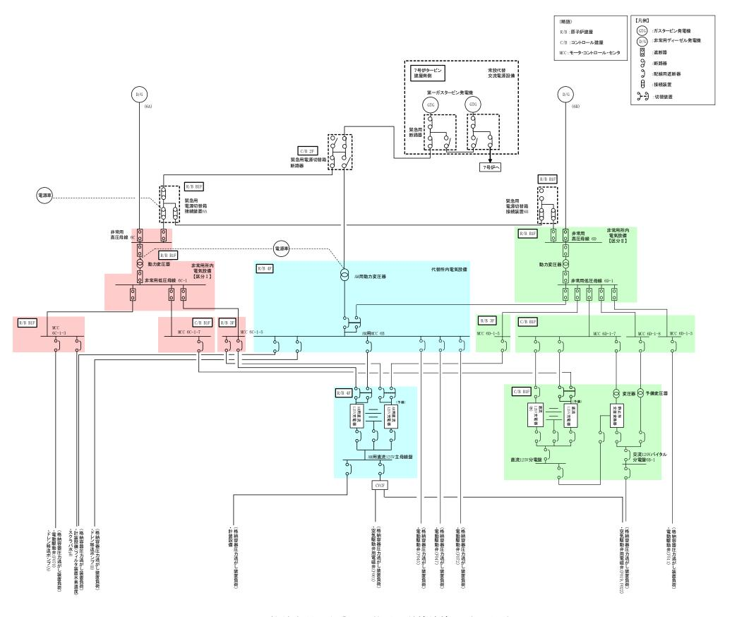
図 50-2-1 格納容器圧力逃がし装置 単線結線図 (6号炉)
