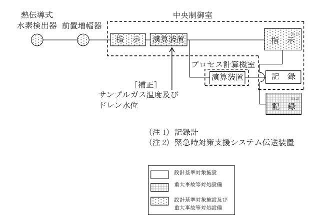
図 52-6-8 7 号炉格納容器内水素濃度の概略構成図
