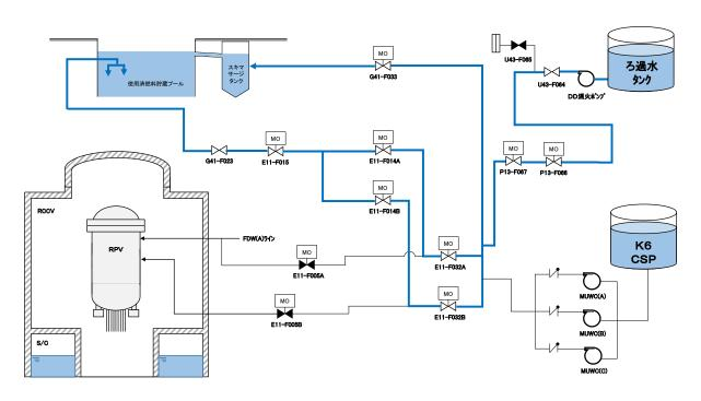
図3 消火系による燃料プール注水 系統概要 (6 号炉の例)
