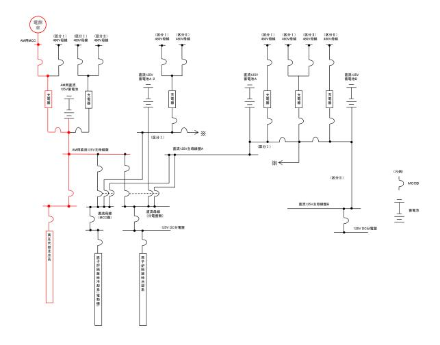
図 2 6 号炉 高圧代替注水系の機能回復 (可搬型代替直流電源設備による給電) 単線結線図
