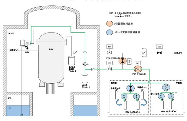
図5 高圧窒素ガス供給系系統概要図 (7号炉)
