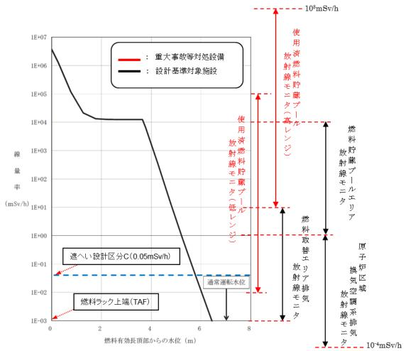
図10 水位と放射線線量率の関係(6号炉)
