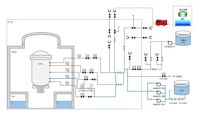
図 1 低圧代替注水系(常設)による原子炉圧力容器への注水 (残留熱除去系(C)注入配管使用)手順の概要図(7号炉の例)
