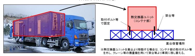
図 48-12-1 熱交換器ユニットの保管場所における転倒防止措置のイメージ
