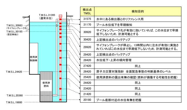
図3 使用済燃料貯蔵プール水位(SA 広域)の水位設定点(6 号炉)
