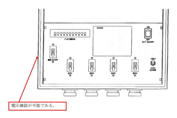
図8 逃がし安全弁用可搬型蓄電池構造図
