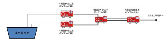
図1 燃料プール代替注水系(可搬型スプレイヘッダ/常設スプレイヘッダ)による注水, 燃料プール代替注水系(可搬型スプレイヘッダ)によるスプレイ 系統概要図
