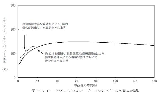
図 50-7-15 サプレッション・チェンバ・プール水温の推移 (原子炉圧力容器への注水及び格納容器スプレイ)
