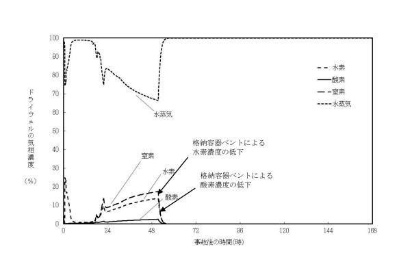
図 52-6-3 原子炉格納容器 (ドライウェル) 気相濃度 (大 LOCA+SBO+全 ECCS 機能喪失,代替循環冷却系使用)
