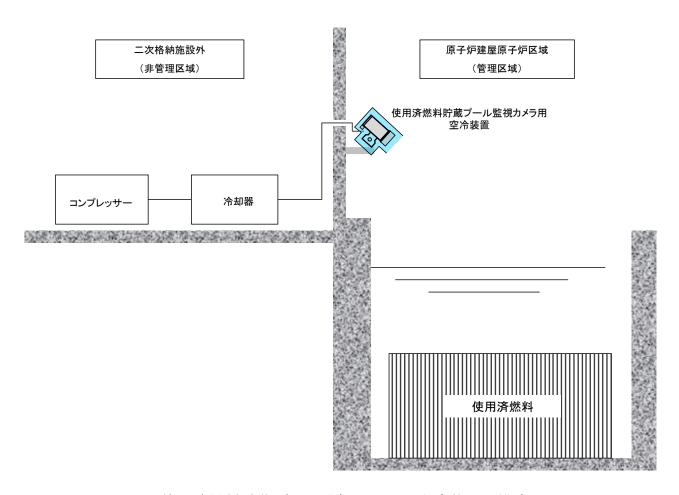
図 14 使用済燃料貯蔵プール監視カメラ用空冷装置の構成図
