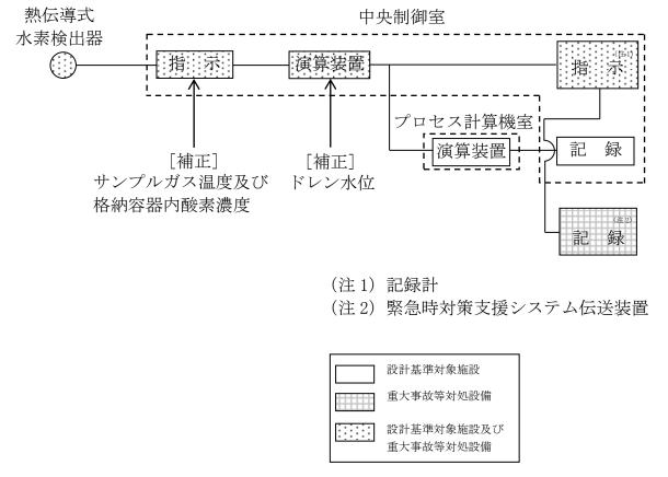
図 52-6-7 6 号炉格納容器内水素濃度の概略構成図
