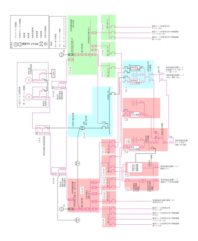
図1 使用済燃料プール監視設備 単線結線図 (6号炉)
