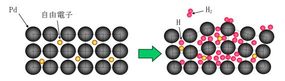
図 52-7-1 格納容器内水素濃度(SA)の測定原理
