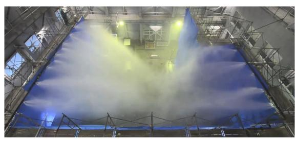
図 13 スプレイ状態の試験状況 (スプレイ量:132m³/h)
