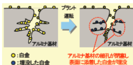
図(添付1-2) ベーマイトが多い触媒における白金の活性表面積の減少イメージ
