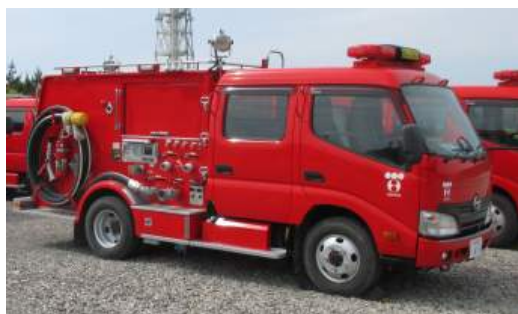
②可搬型代替注水ポンプ（A-2 級消防車）
