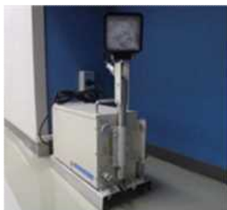
第6図 バッテリー内蔵型の照明
