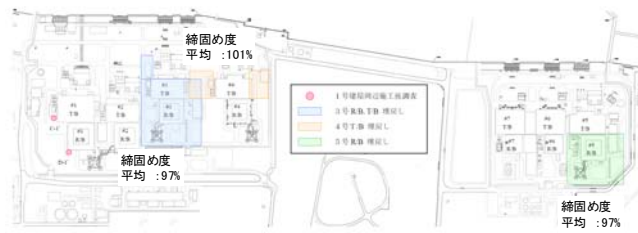
埋戻土の締固め度 (建屋周辺)
