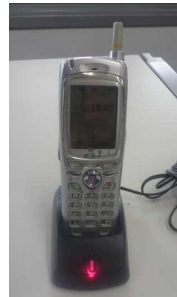
電力保安通信用電話設備 （PHS端末）
