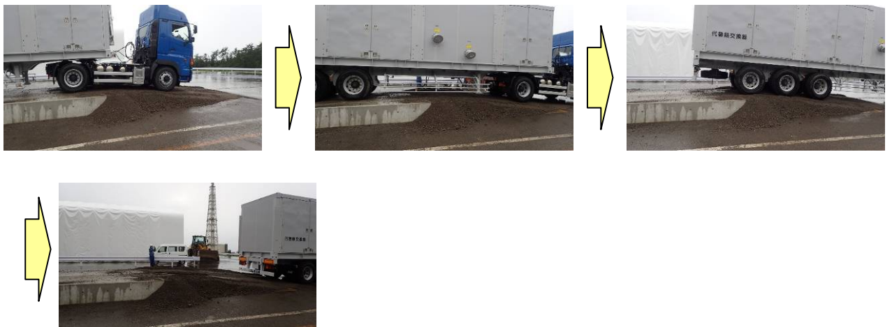
第4図 走行性検証状況写真
