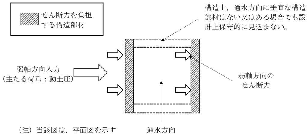
第 5-4-5 図 従来設計手法の考え方
