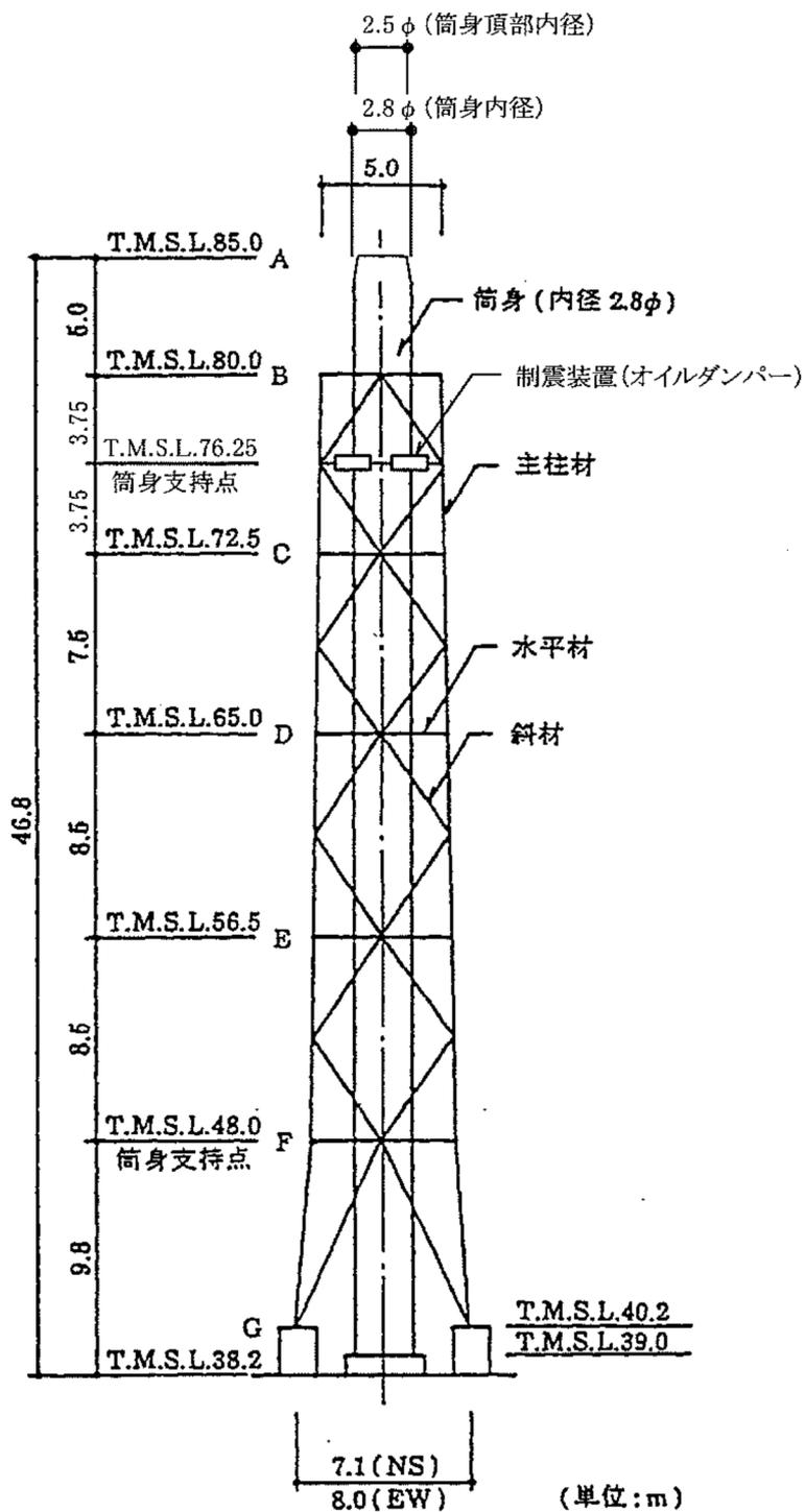
第7-15図 主排気筒概要図 (6号炉)
