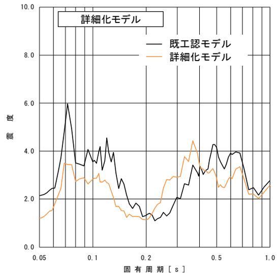
第9図 (2/2) 原子炉遮蔽壁における床応答スペクトル比較
