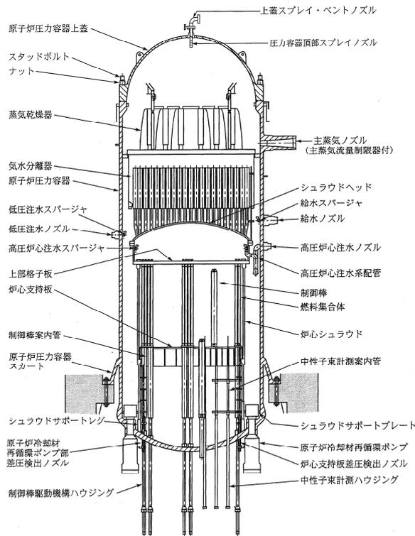
第 2-4 図 原子炉内部構造図
