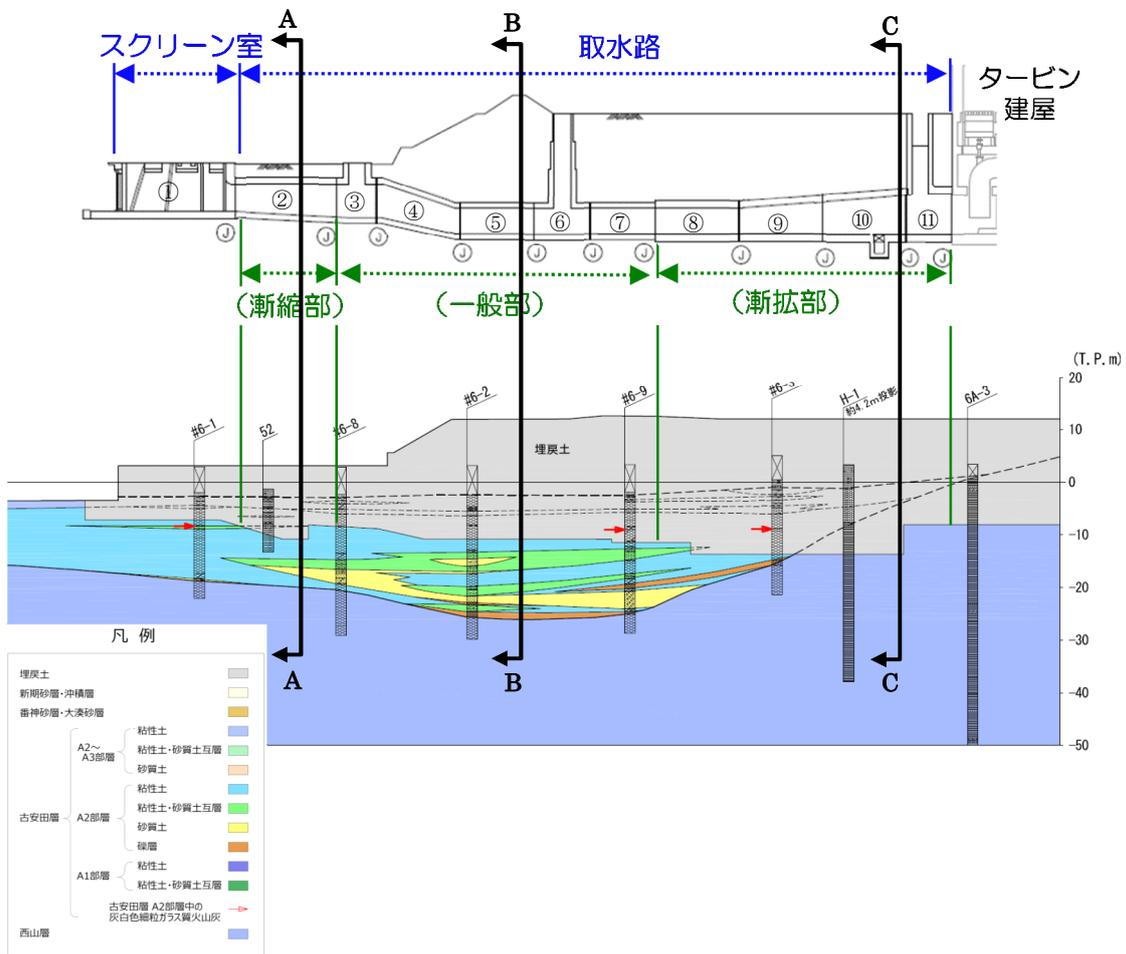
第6-2-2図 6号炉取水路 縦断面図
