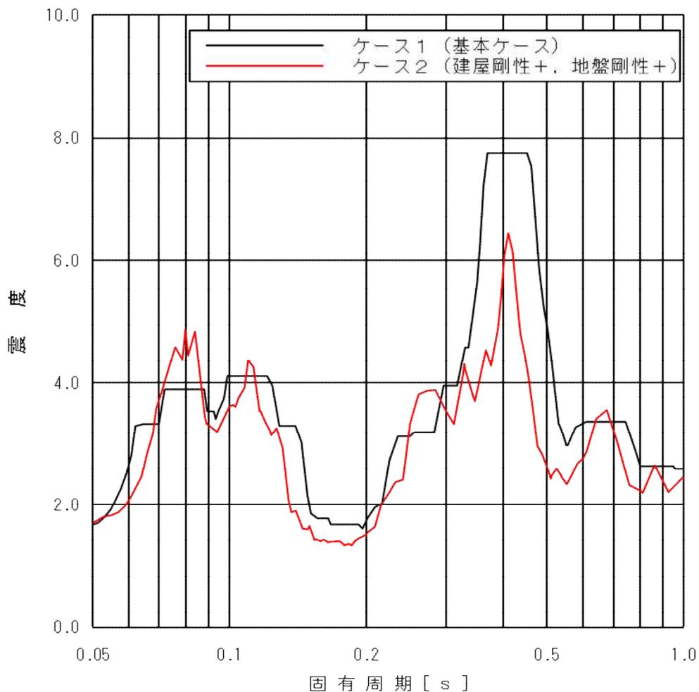
第5図 (1/4) 原子炉遮蔽壁における床応答スペクトル比較 (ケース2)
