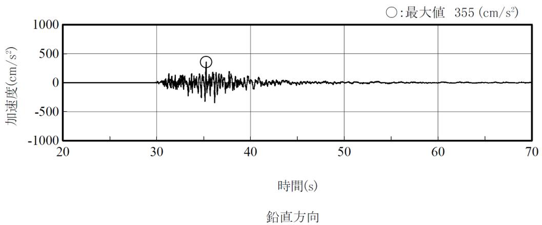
第 2-3 図 原子炉建屋基礎版上の地震観測記録 加速度時刻歴波形
