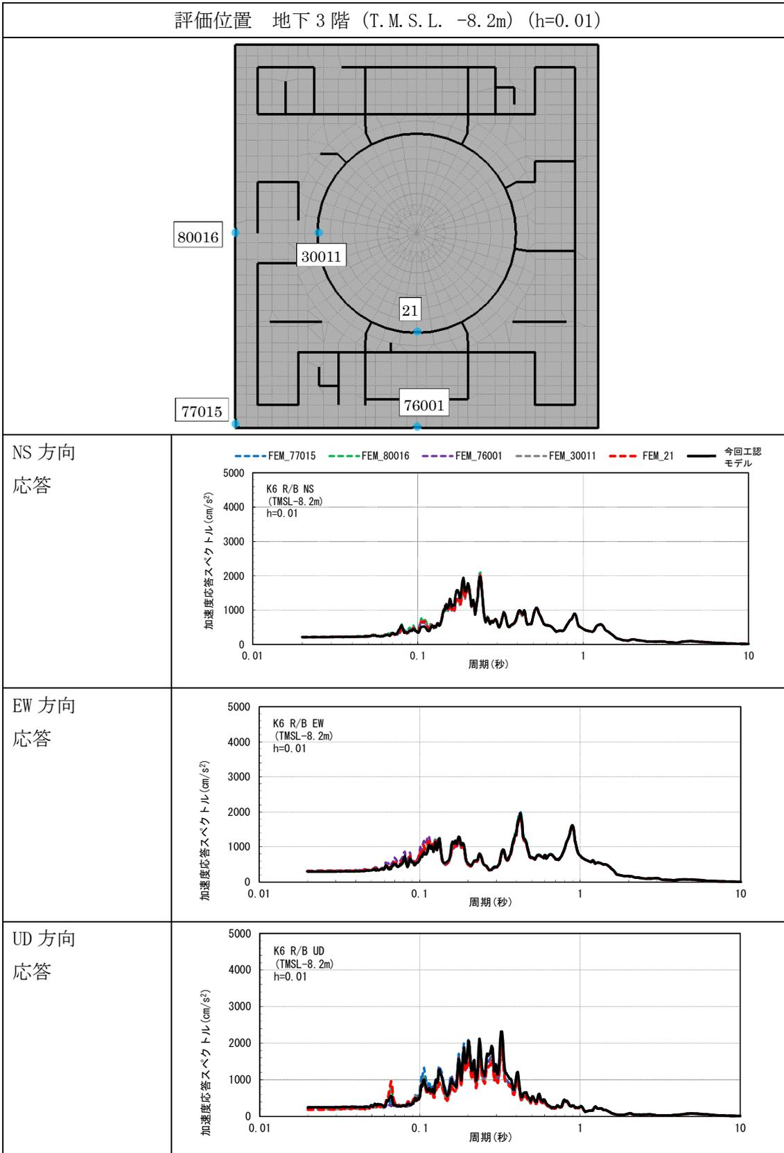
第 3. 3-1 図 今回工認モデル及び建屋 3 次元 FEM モデルの応答スペクトルの比較 (4/6)
