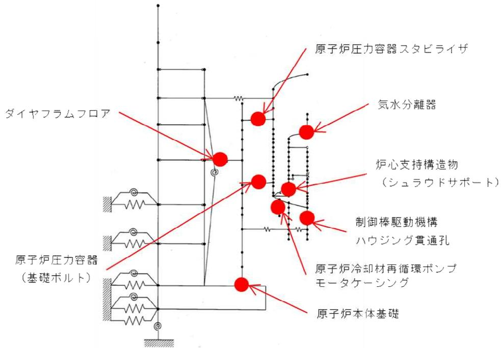
第 6 図 評価対象設備（代表設備）
