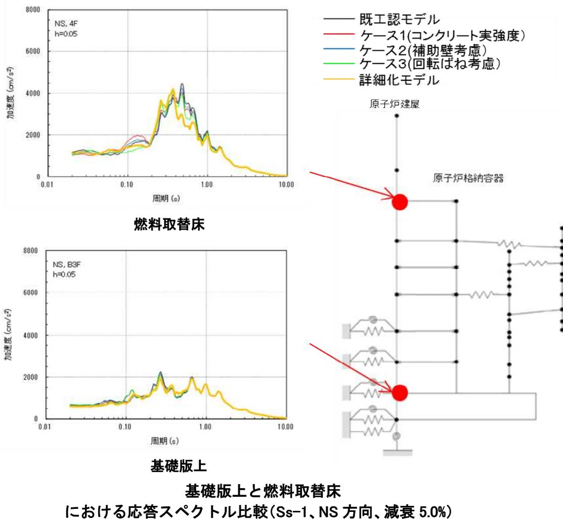
第4図 原子炉建屋の床応答スペクトルの比較
