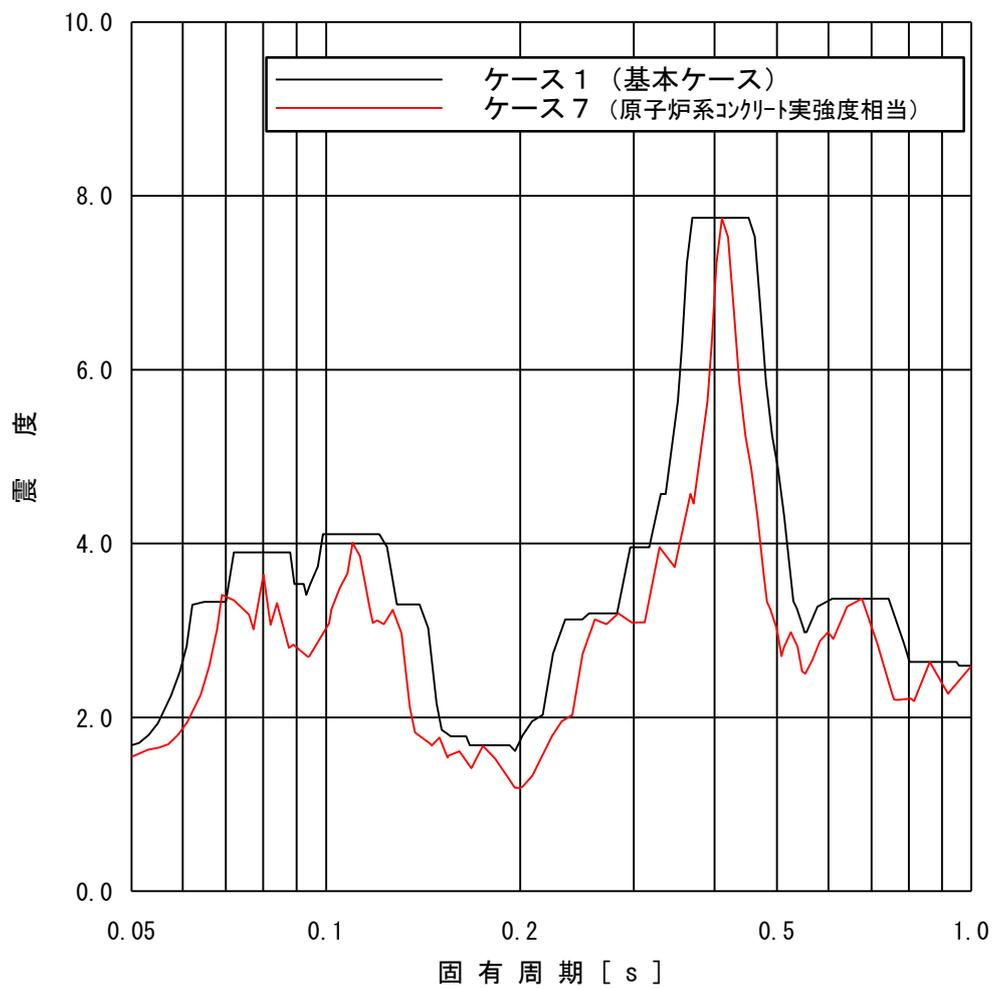
第5図 (3/4) 原子炉遮蔽壁における床応答スペクトル比較 (ケース7)
