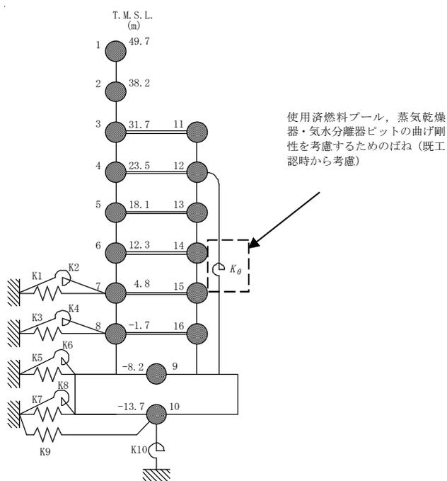
第 3-2 図 今回工認で採用予定の原子炉建屋の地震応答解析モデル (EW 方向)
