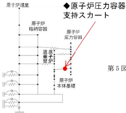
第5図 原子炉压力容器スカートにおける地震荷重の比較
