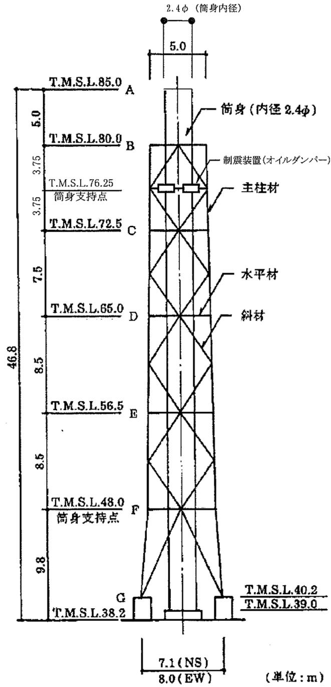
第 7-17 図 主排気筒概要図 (7 号炉)
