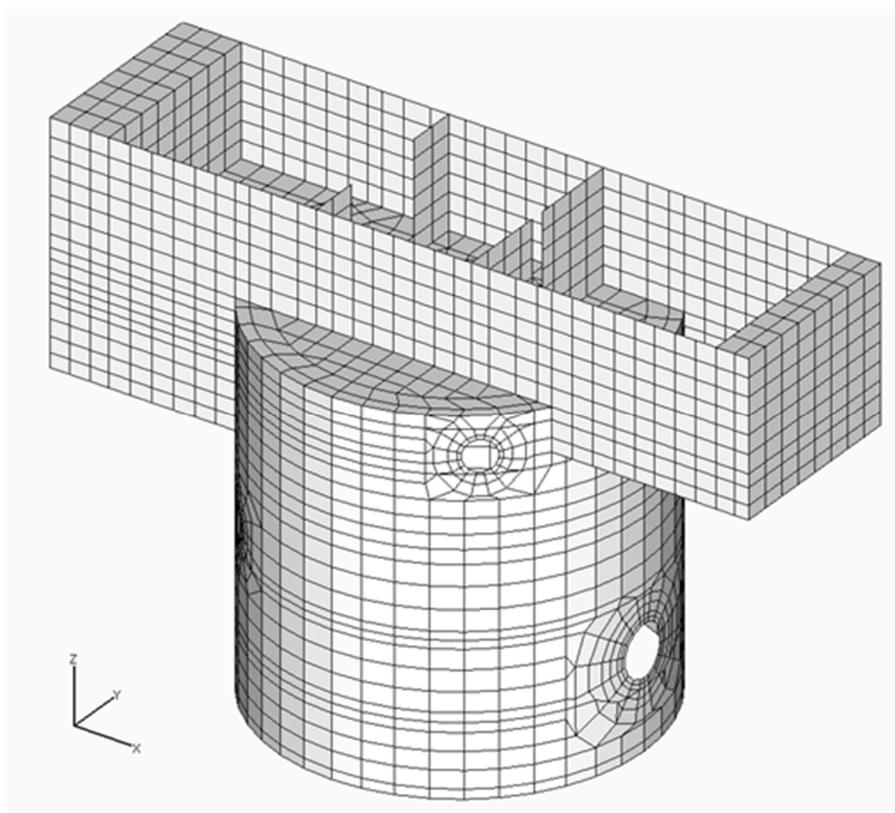
第7-19図 原子炉格納容器 解析モデル図
