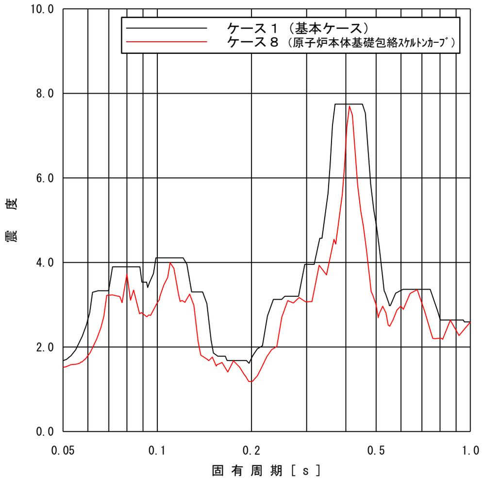
第5図 (4/4) 原子炉遮蔽壁における床応答スペクトル比較 (ケース8)
