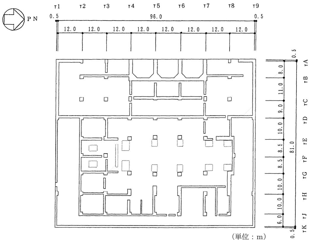
第7-10図 6号炉タービン建屋 概略平面図 (T.M.S.L. -5.1m)
