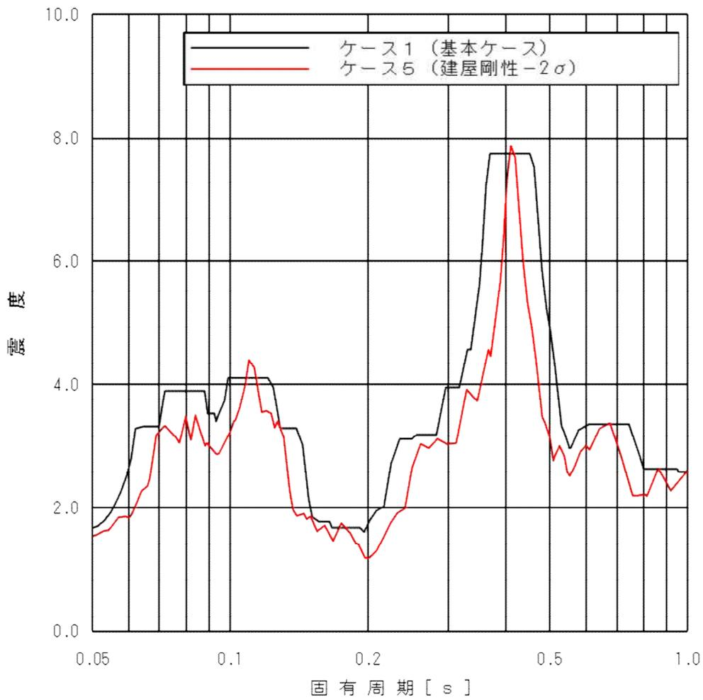
第5図 (2/4) 原子炉遮蔽壁における床応答スペクトル比較 (ケース5)
