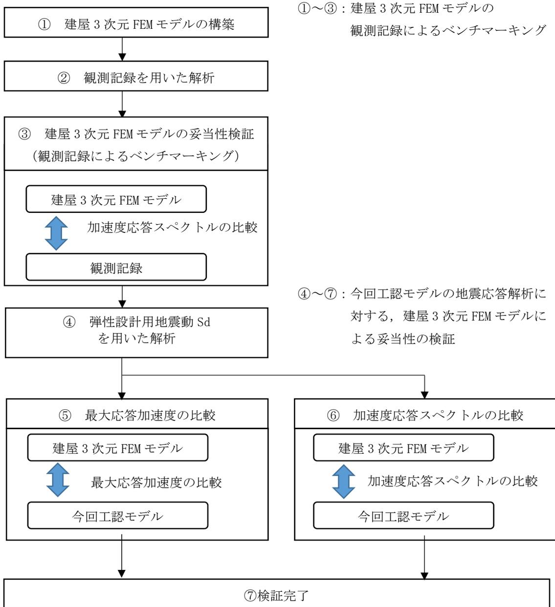
第 3-5 図 地震応答解析モデルの妥当性検証フロー
