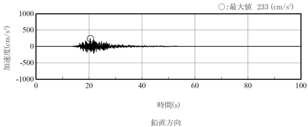
第 3.1-2 図 弾性設計用地震動 Sd-2 加速度時刻歴波形 (解放基盤表面)
