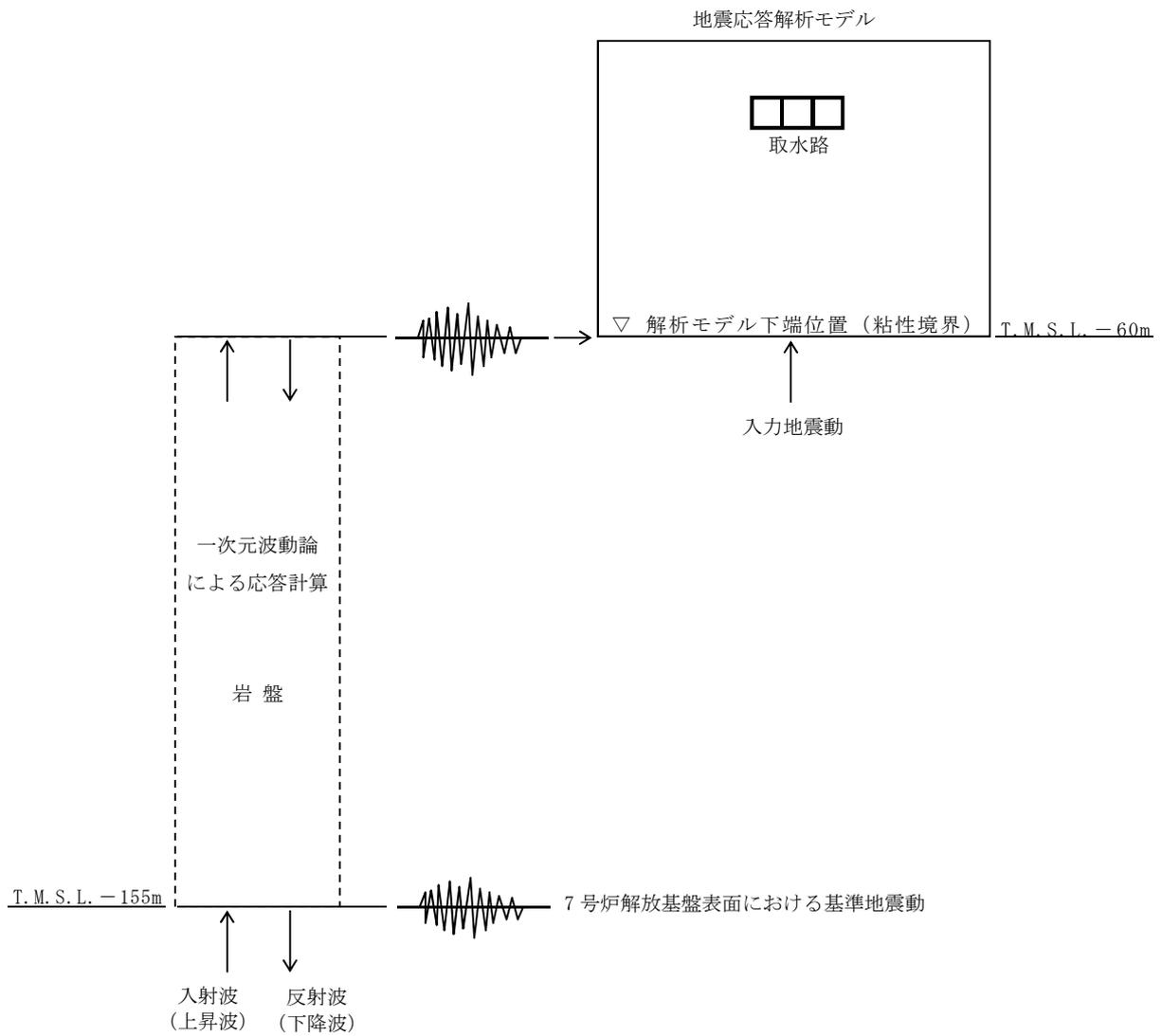
第8-2図 屋外重要土木構造物への入力地震動の概念図（7号炉取水路の例）
