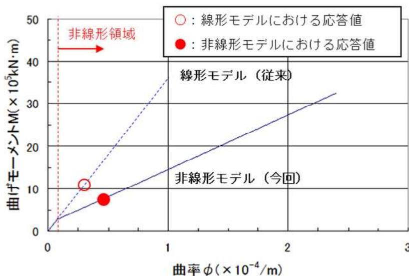
第3-4図 原子炉本体基礎の復元力特性の例
