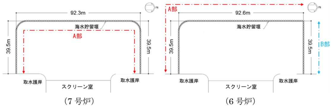
第 6-5-1 図 6号及び7号炉海水貯留堰 平面図
