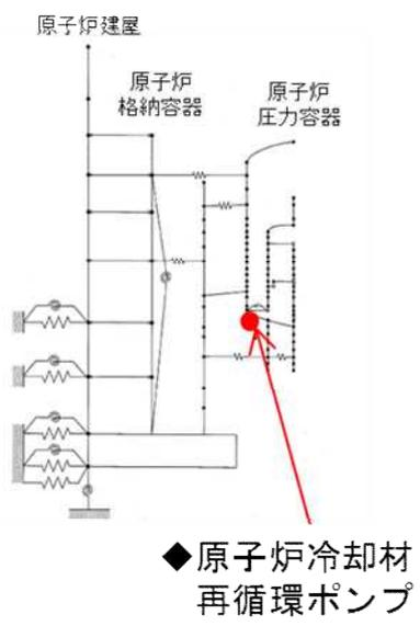
第8図 原子炉冷却材再循環ポンプ付け根部における地震荷重の比較 (上：せん断力，下：モーメント)
