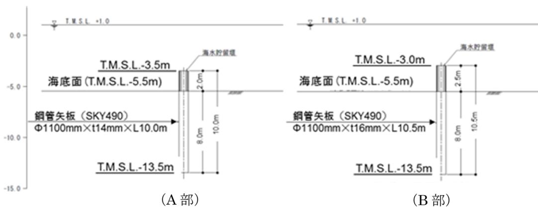
第 6-5-2 図 6号及び7号炉海水貯留堰 断面図
