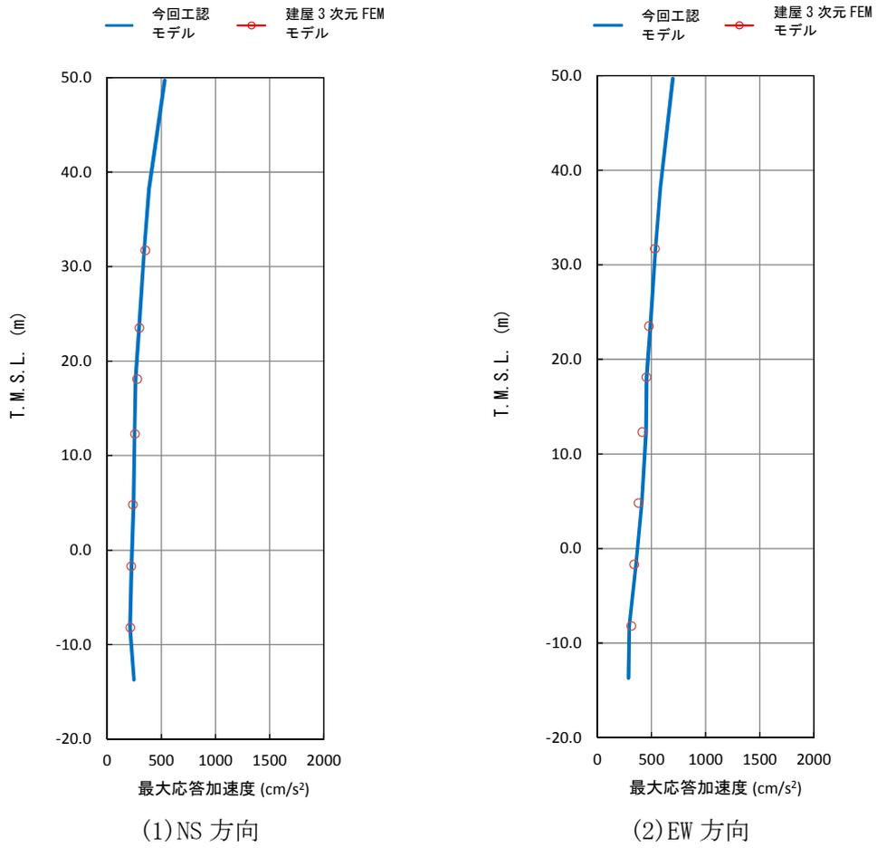
第 3.2-1 図 今回工認モデル及び建屋 3 次元 FEM における最大応答加速度の比較
