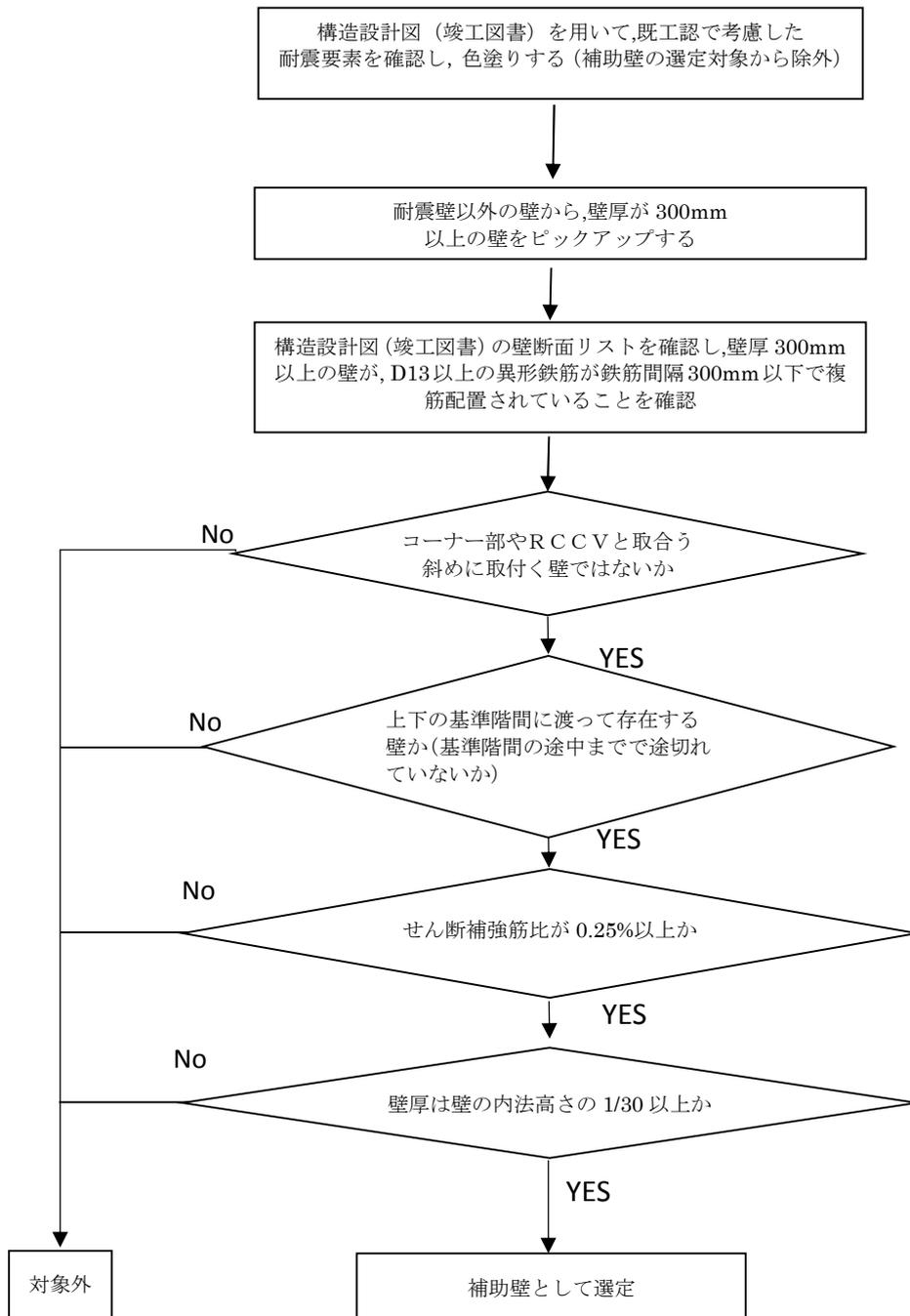
第 2-1 図 補助壁の選定プロセス
