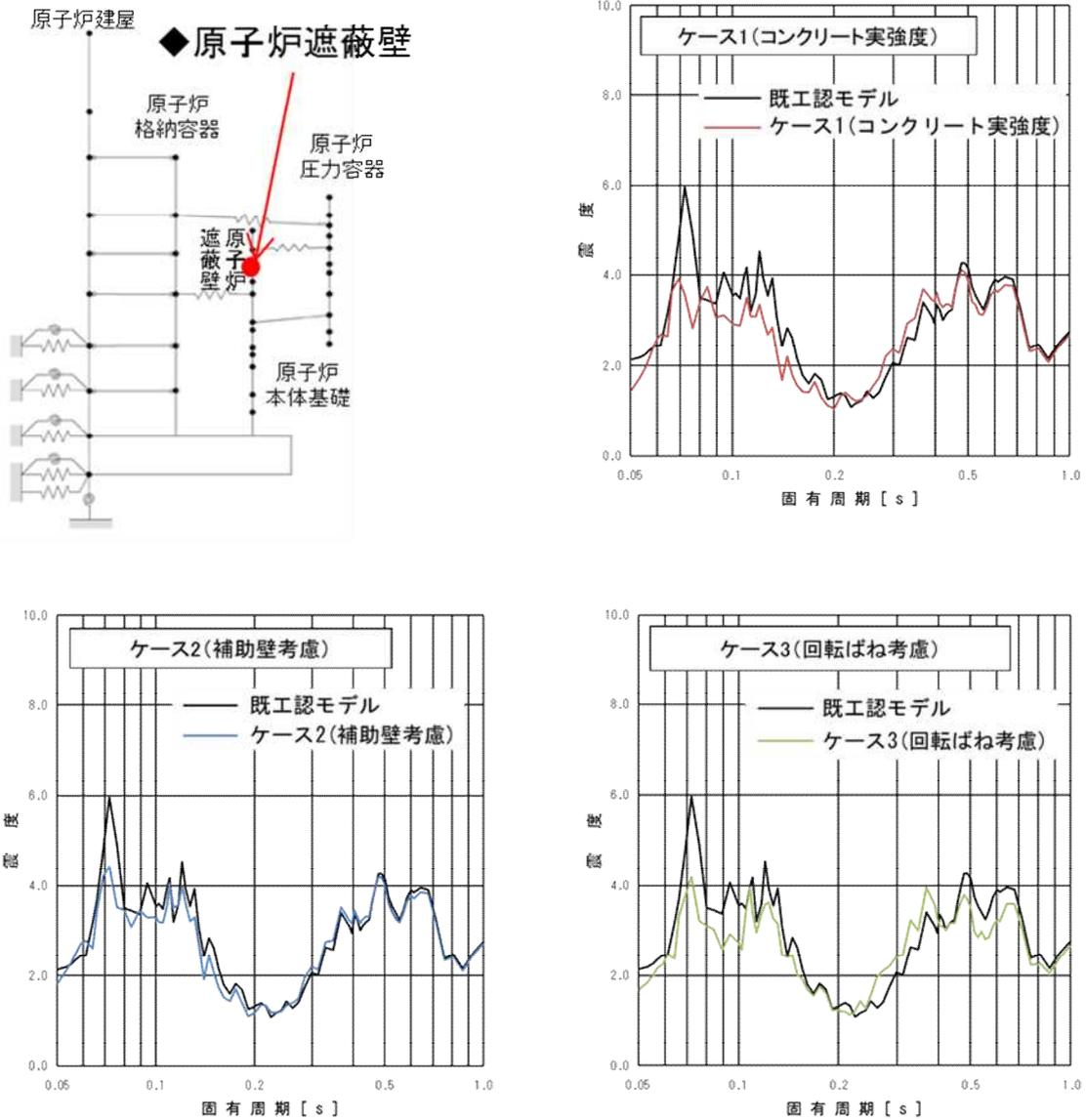
第 9 図 (1/2) 原子炉遮蔽壁における床応答スペクトル比較
