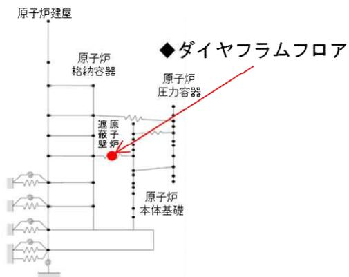
第7図 ダイヤフラムフロアにおけるばね反力の比較
