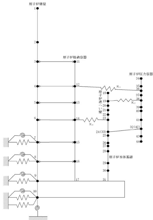
第 2-3 図 原子炉本体基礎の地震応答解析モデル
