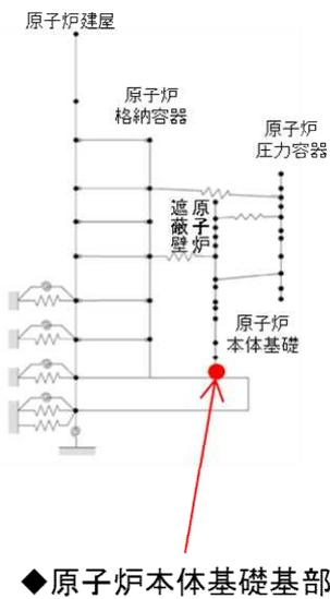
第6図 原子炉本体基礎基部における地震荷重の比較
