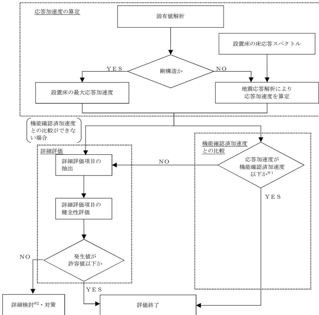
※1 制御棒の地震時挿入性の評価については、炉心を模擬した実物大の部分モデルによる加振時制御棒挿入試験結果から挿入機能に支障を与えない最大燃料集合体変位を求め、地震応答解析から求めた燃料集合体変位がその最大燃料集合体変位を下回ることを確認する。
