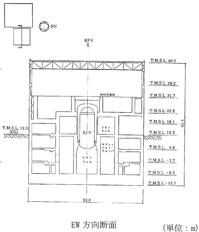
第 7-5 図 6 号炉原子炉建屋 断面図
