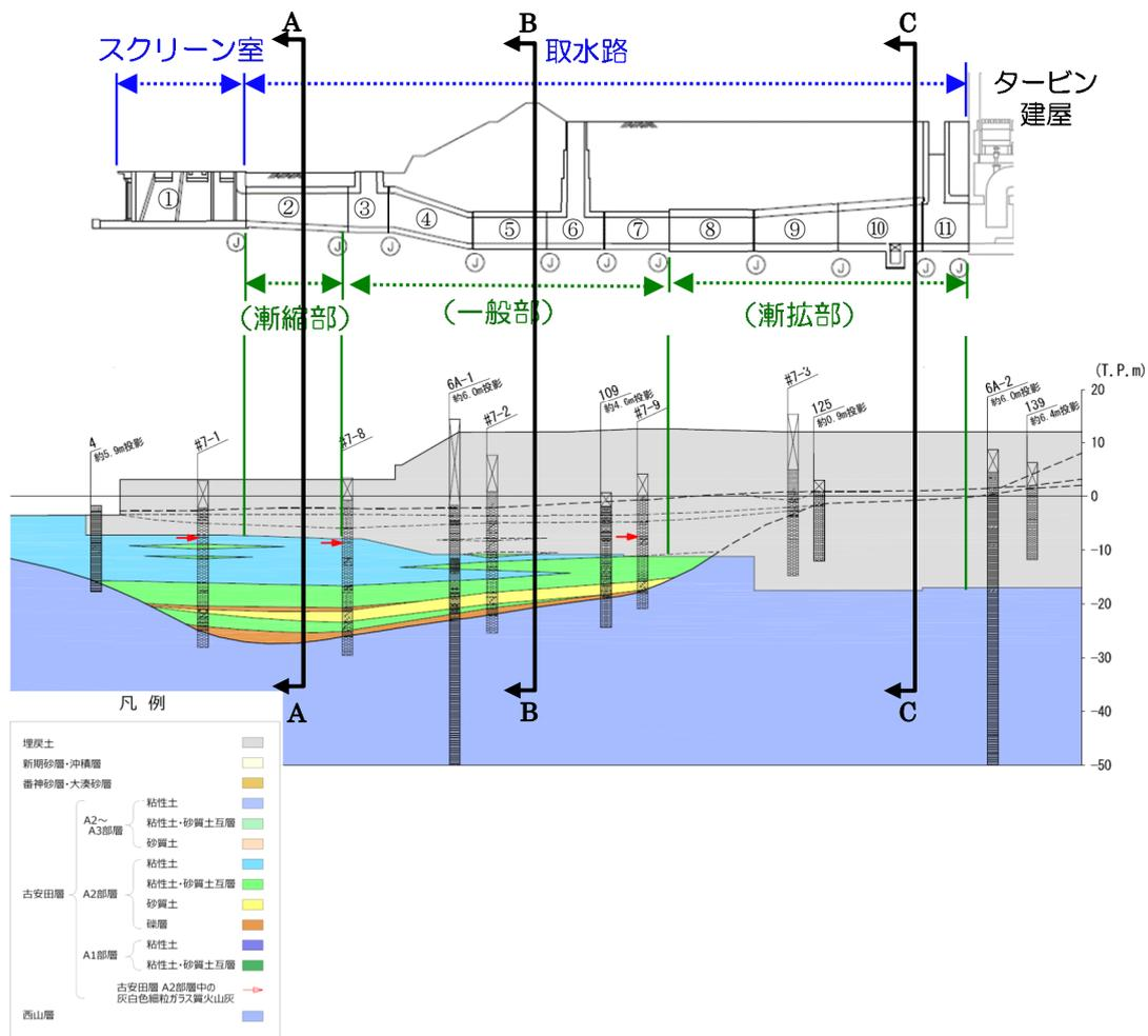
第 6-2-3 図 7号炉取水路 縦断面図
