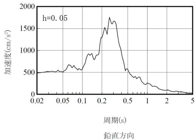
第 2.2-4 図 原子炉建屋の基礎上の観測記録 加速度応答スペクトル
