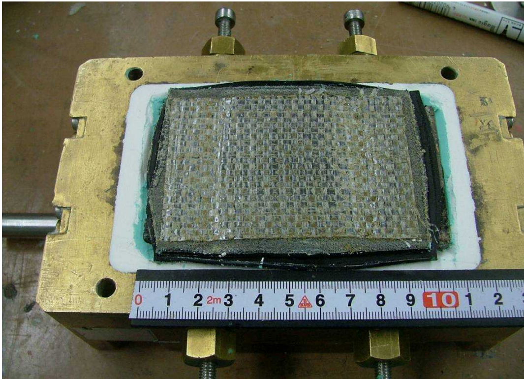
第 3.3.19 図 繰返し载荷試験後の供試体状況 ケース 1-8 (保護層表面)
