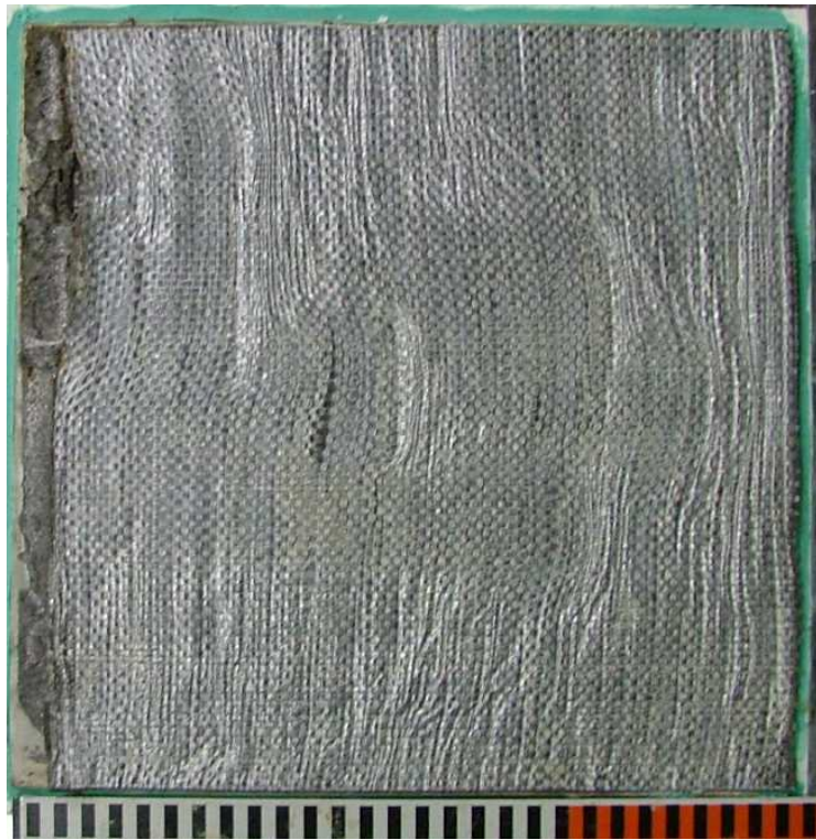
第 3.4.13 図 スケール影響試験後の供試体状況 ケース 2-6 (保護層表面)
