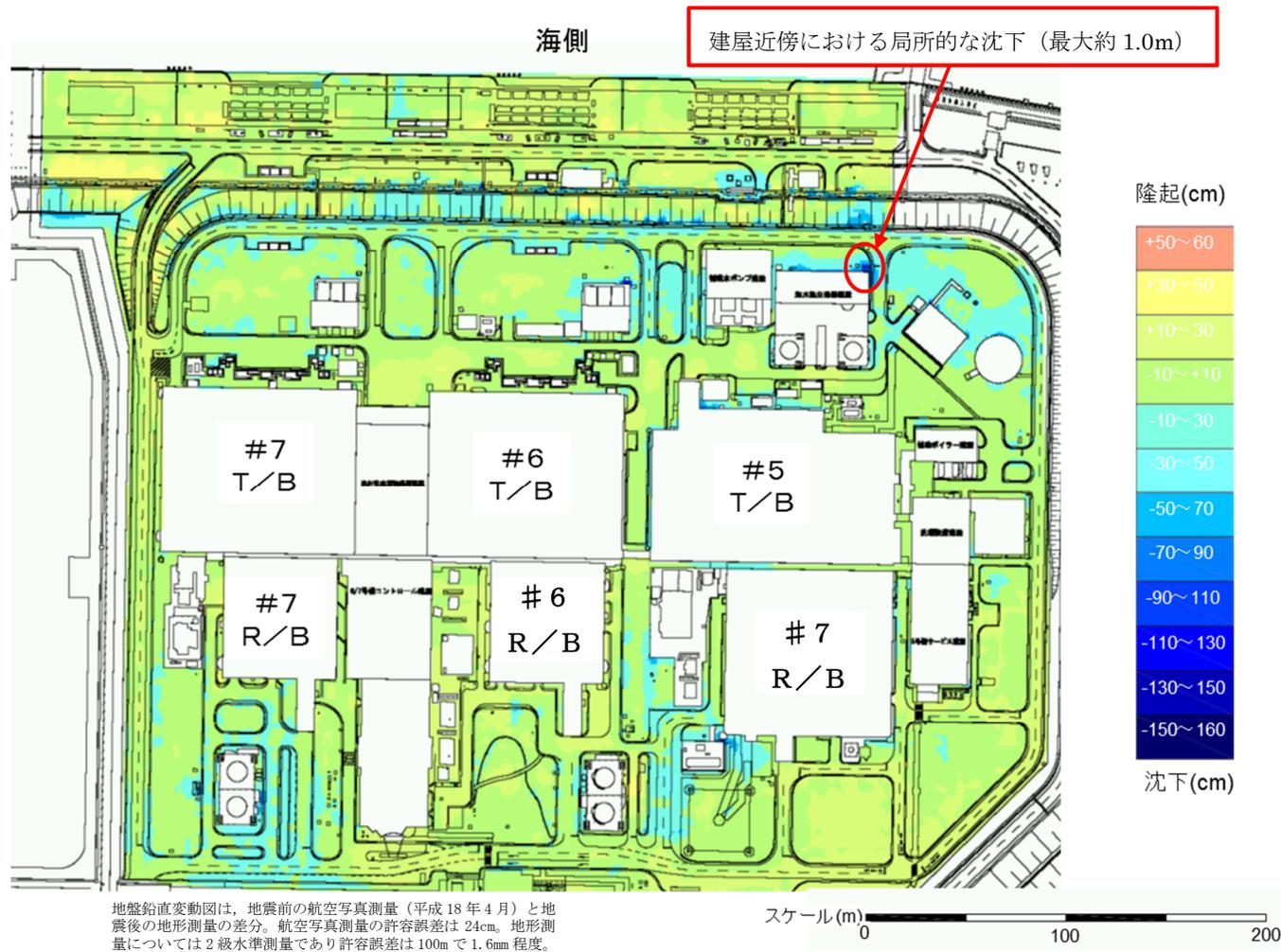
第 11-11-34 図 新潟県中越沖地震における敷地内の地盤鉛直変動図 (b)大湊側
