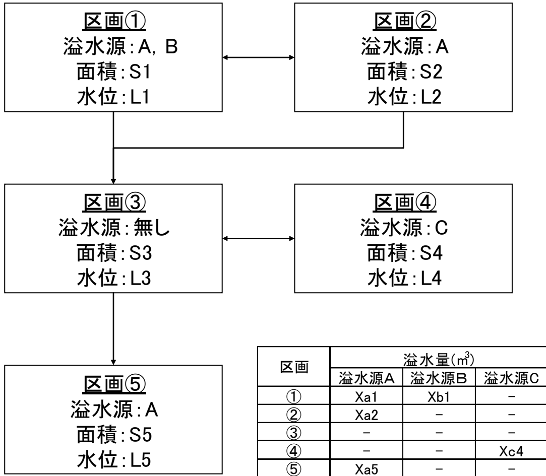
第7.6.2-1図 地震時溢水伝播評価のモデルケースの設定
