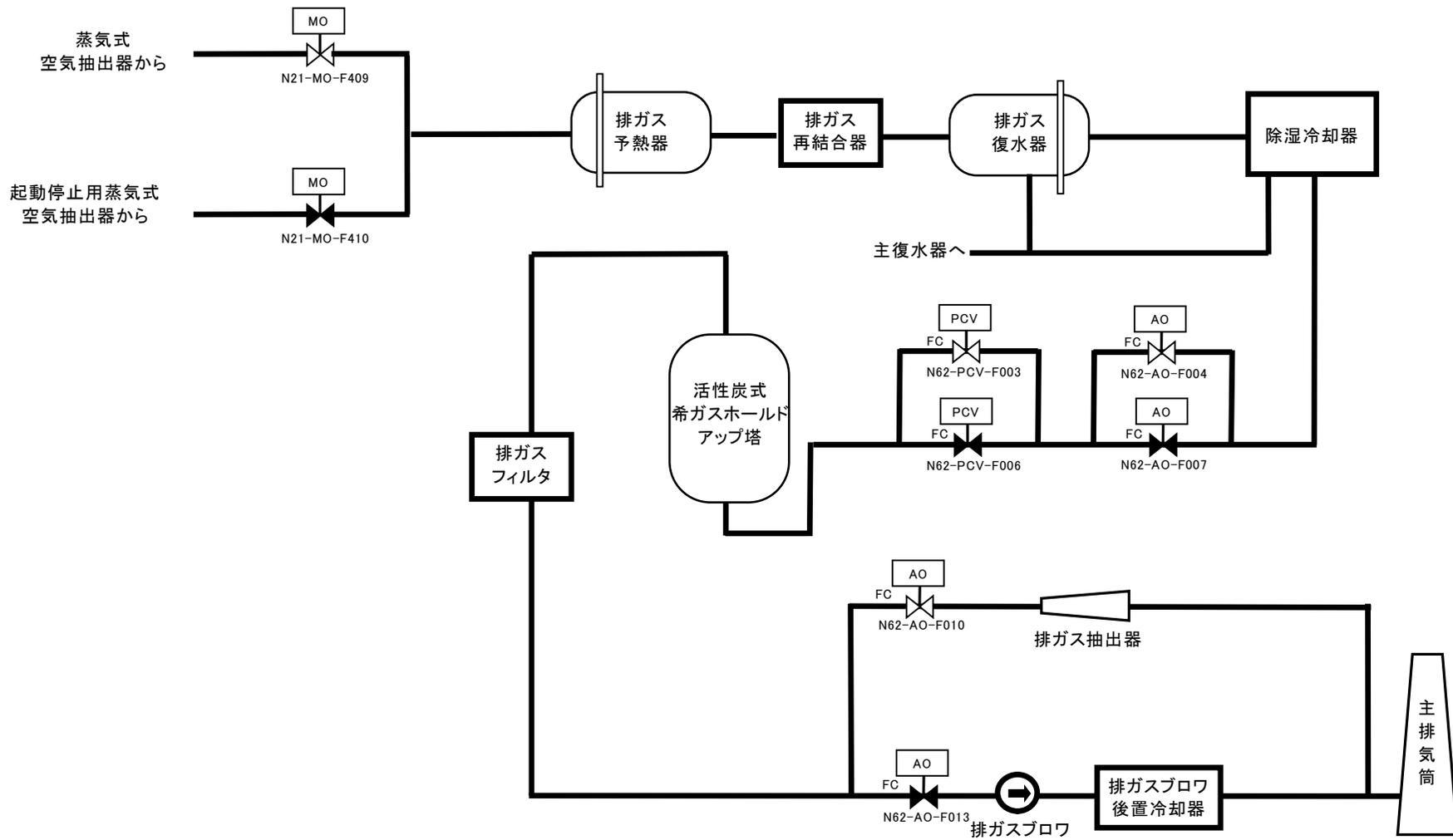
第 9-1 図：気体廃棄物処理系 系統概略図（6 号炉）
