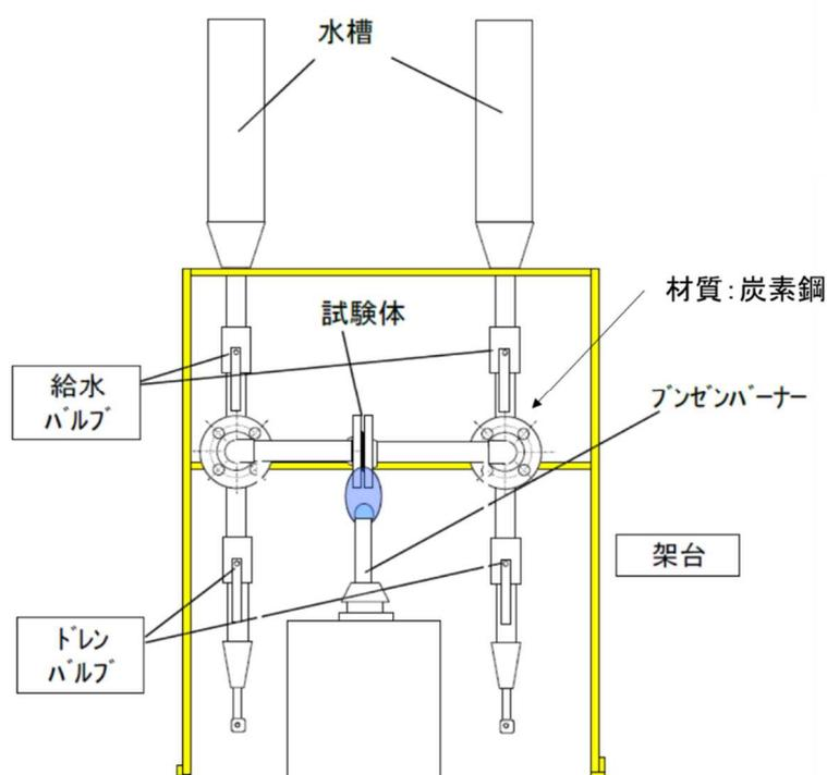
第1図 加熱試験の概要
