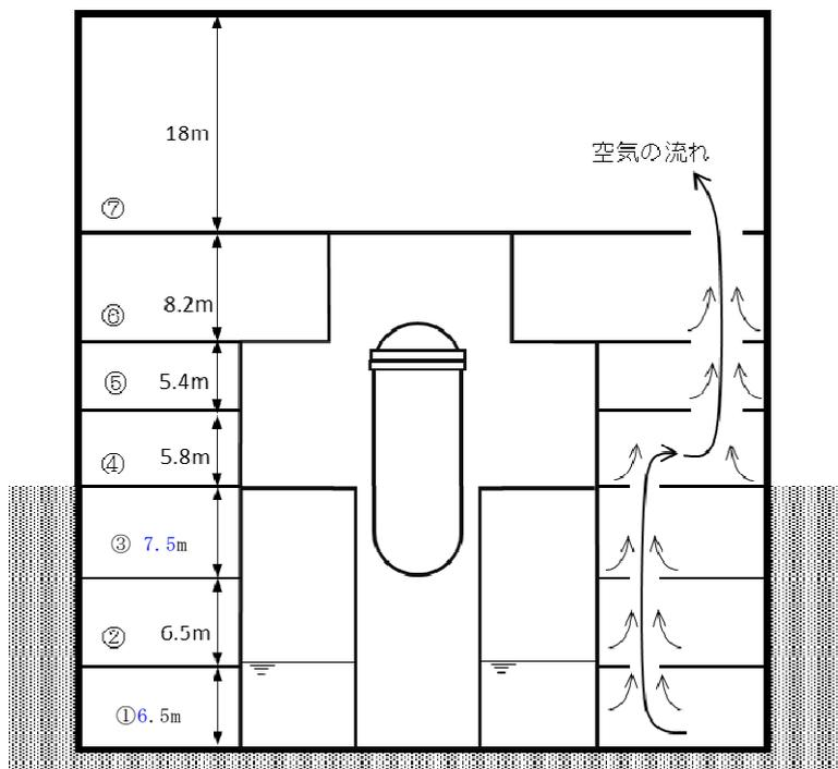
第 2.1 図 7号炉原子炉建屋の断面図
