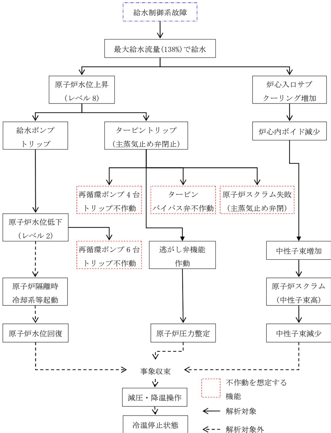
図 6-6 給水制御系の故障事象進展フロー (T/B 起因)
