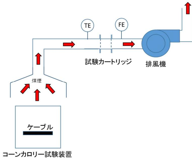
第 2 図 煤煙通気試験装置 概要図
