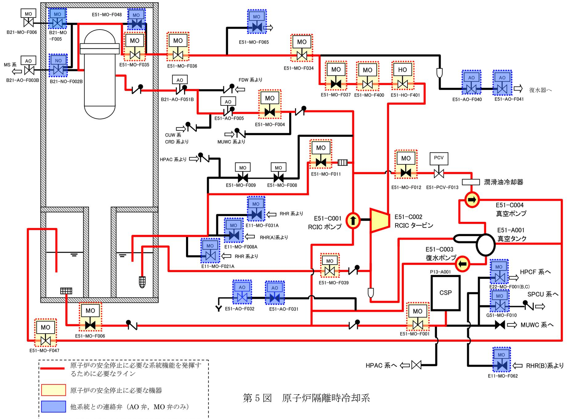
第 5 図 原子炉隔離時冷却系
