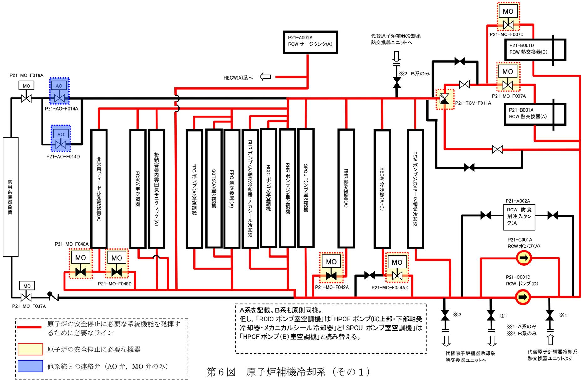
第6図 原子炉補機冷却系 (その1)
