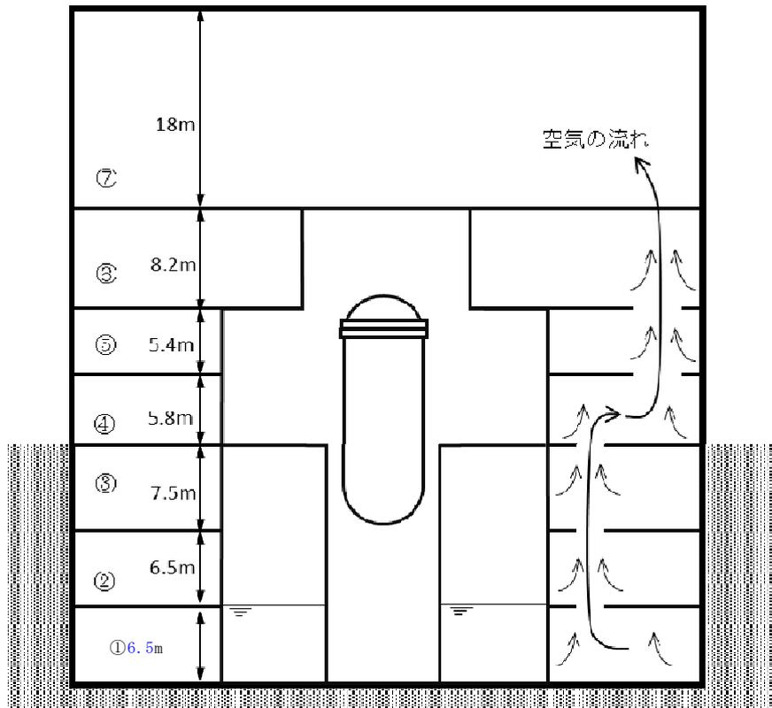
第 2.2 図 6号炉原子炉建屋の断面図
