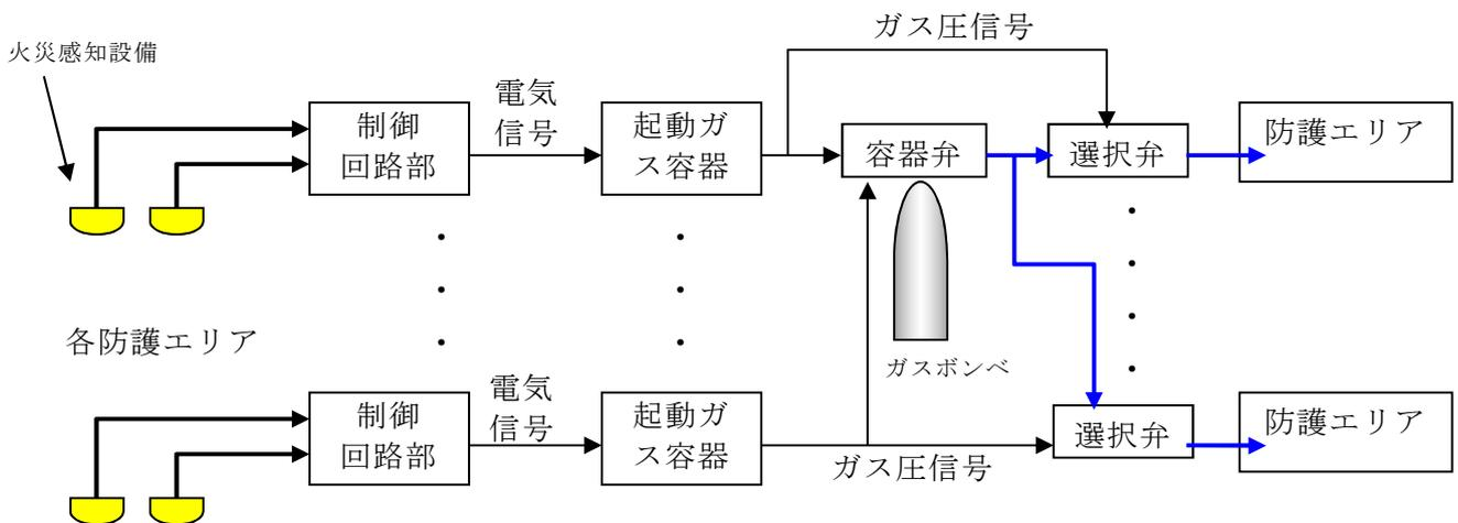
第8図：全域ガス消火設備（選択型）の系統構成
