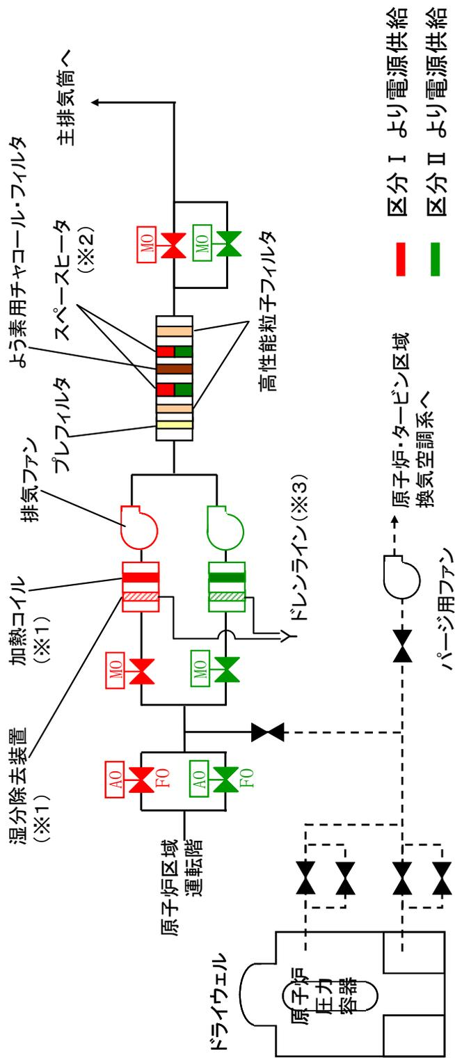
(※1) SGT5乾燥装置(湿分除去装置, 加熱コイル)は100% × 2系列
