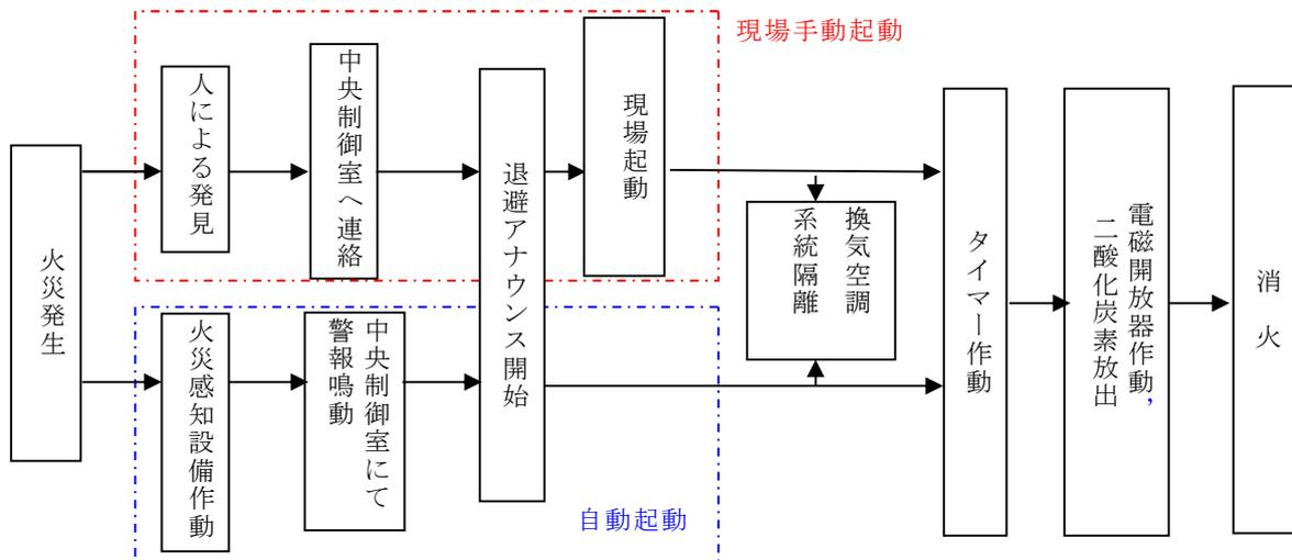
第2図 火災発生時の信号の流れ
