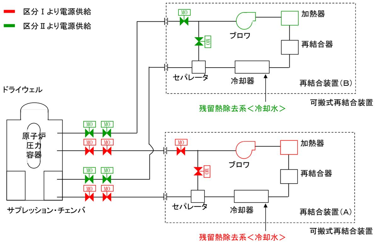
第10図：可燃性ガス濃度制御系の概要
