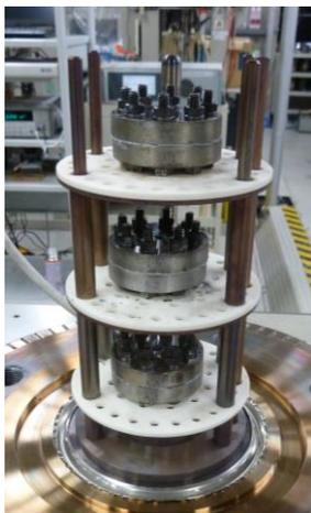
図3 蒸気暴露試験片設置状況
