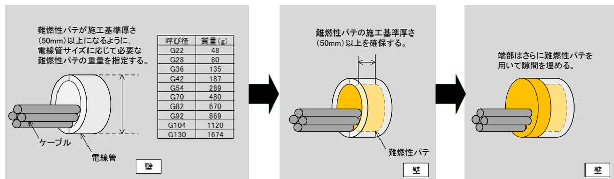
第8図 電線管貫通部処理時の管理方法（7号炉の例）
