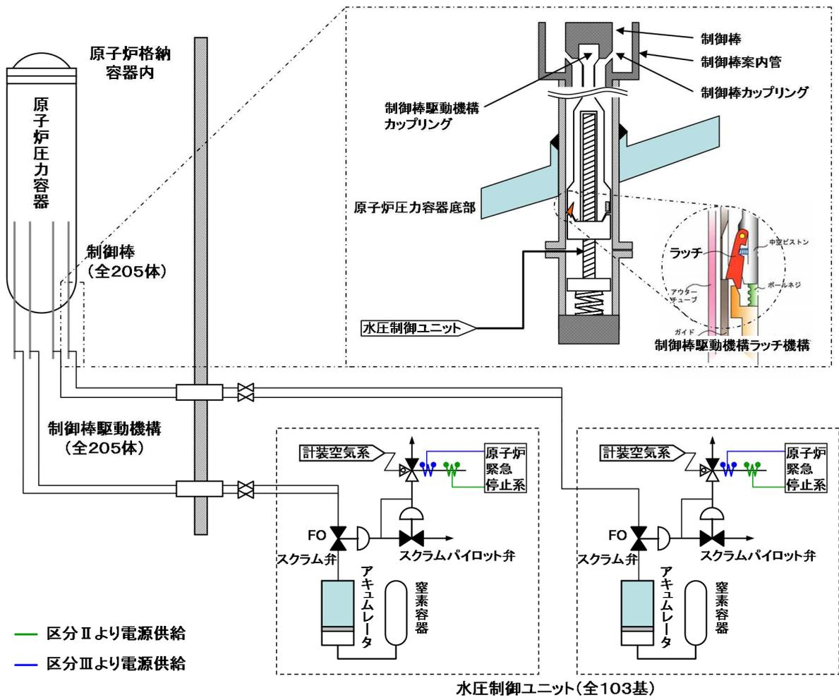
第1図：原子炉の緊急停止機能の概要
