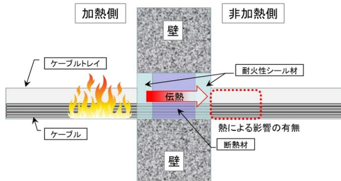
図 1 非加熱面側のケーブルトレイ貫通部周囲への熱影響
