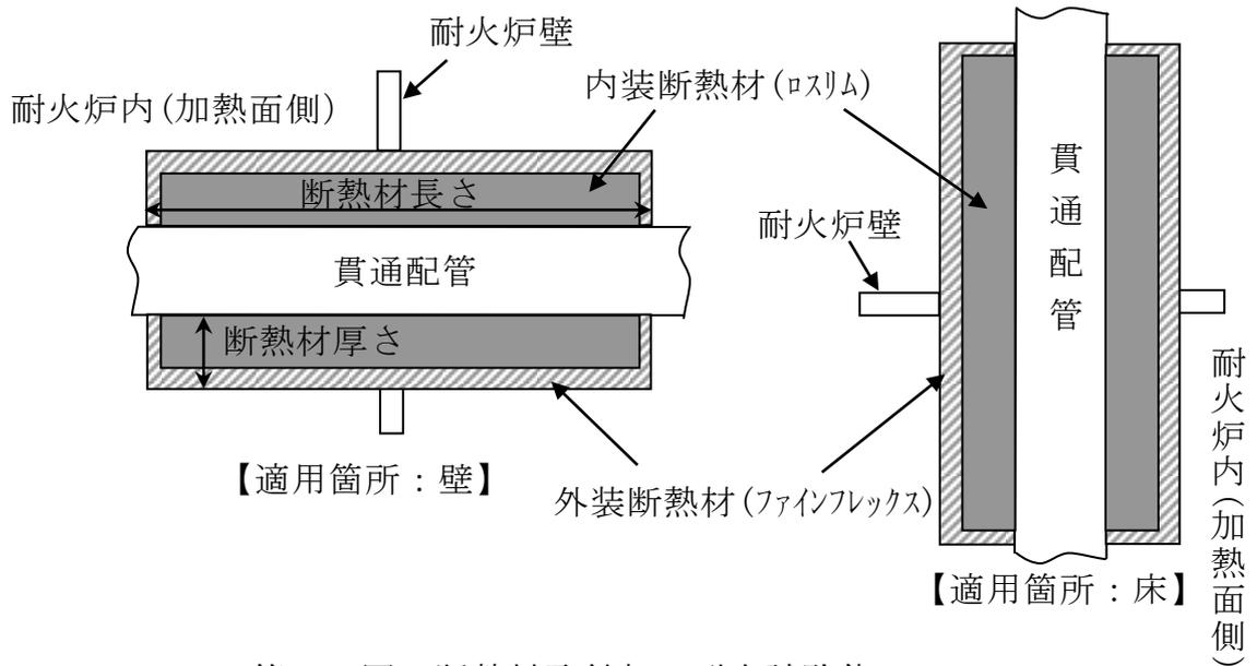
第 4-1 図 断熱材取付部の耐火試験体
