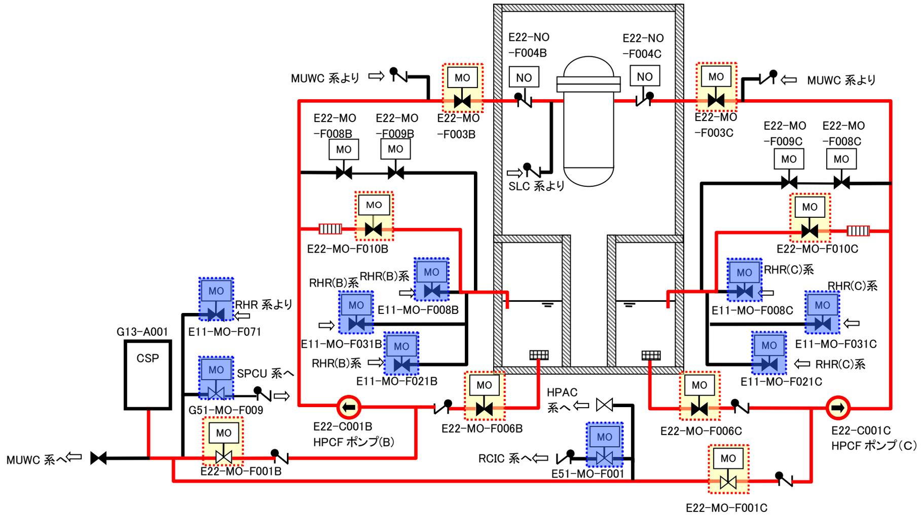
第 4 図 高圧炉心冷却系
