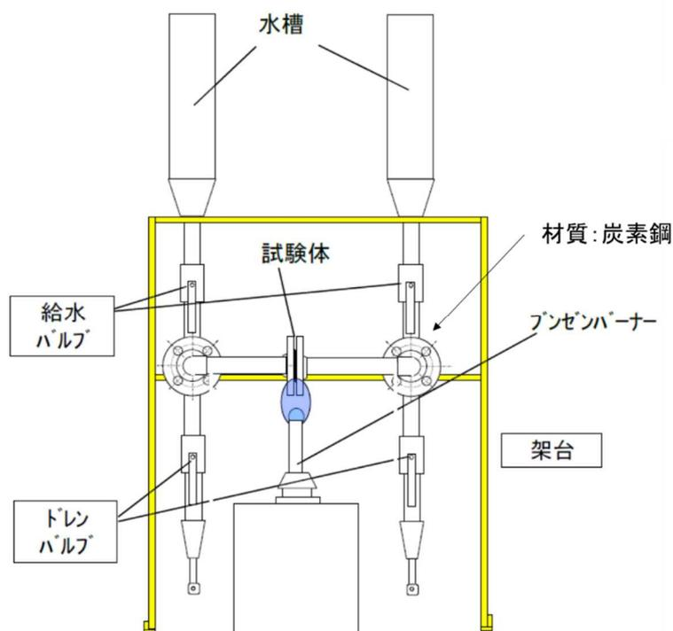
第1図 加熱試験の概要
