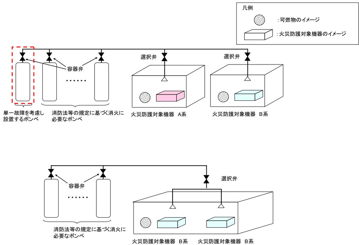
第 1-23 図：系統分離に応じた独立性を考慮した消火設備の概要図
