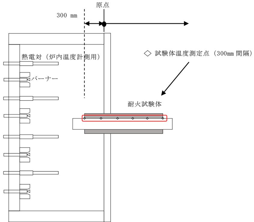
※：原点からの長さに炉側 300mm を加えたものを断熱材の必要長さとする。
