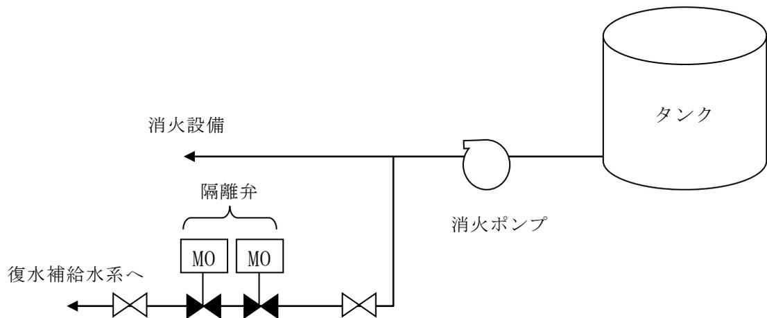
第 1-26 図：消火用水供給系の優先供給の概略図
