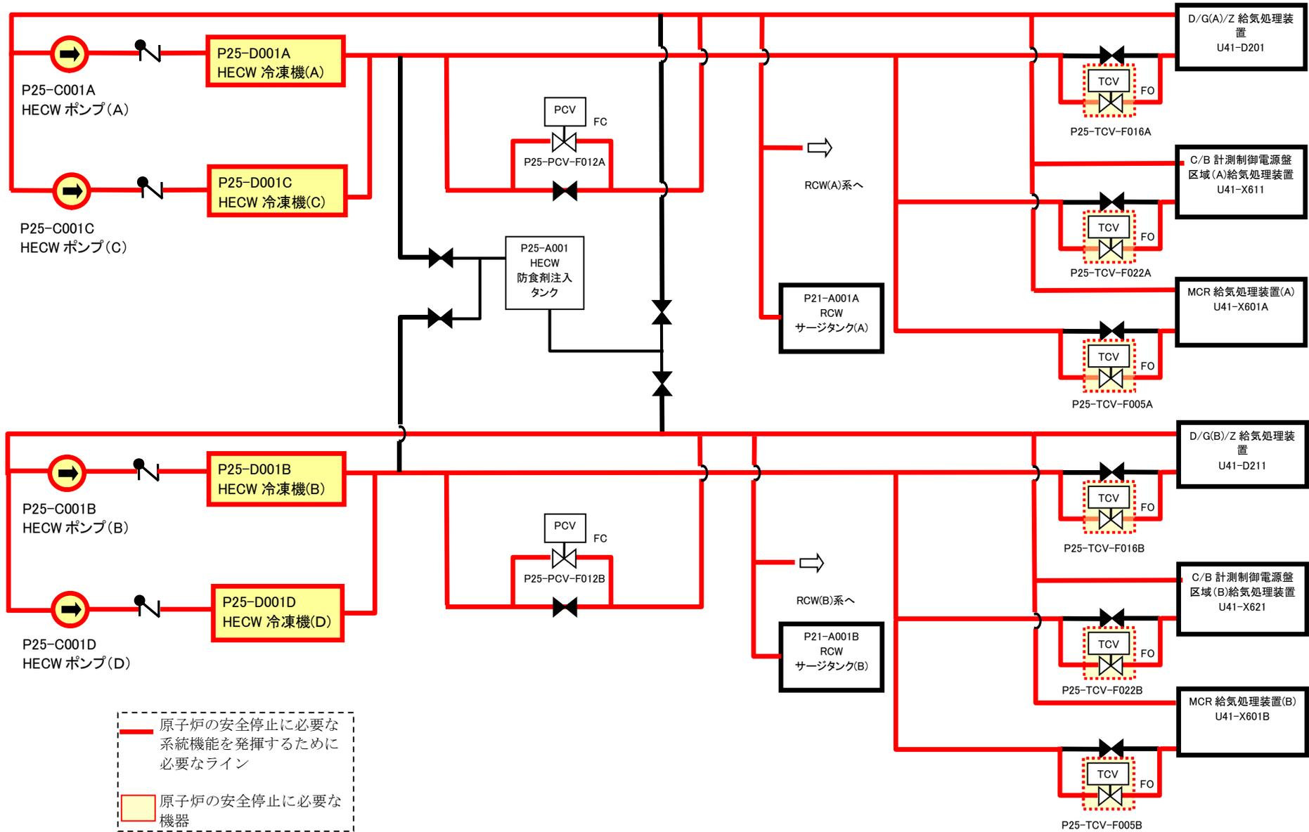
第 8 図 換気空調補機非常用冷却系
