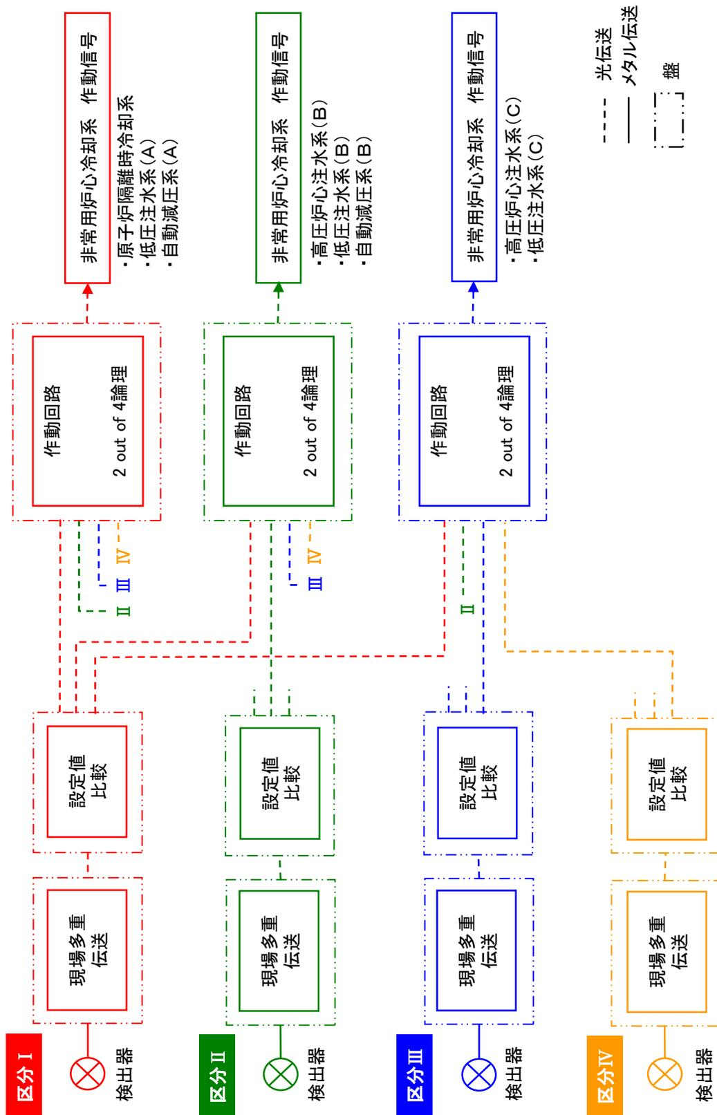
第 17 図：非常用炉心冷却系作動の安全保護回路の概要図
