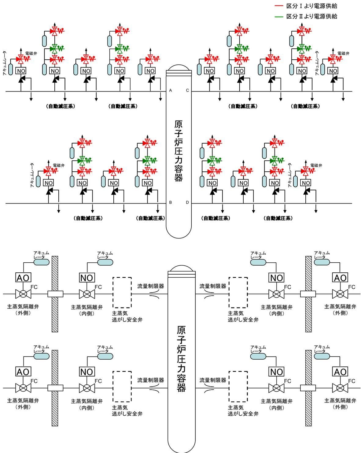
第 13 図：圧縮空気供給機能の概要
