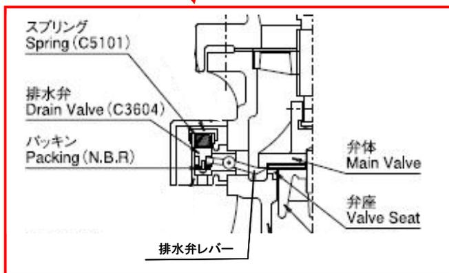
**<強制排水弁機構>**
