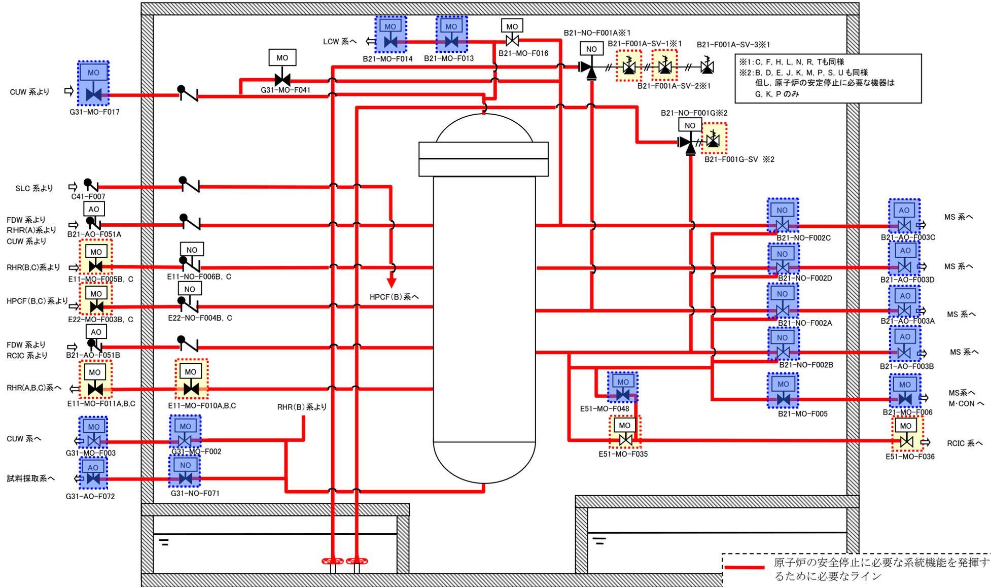
第1図 原子炉冷却材圧力バウンダリ/自動減圧系/逃がし安全弁
