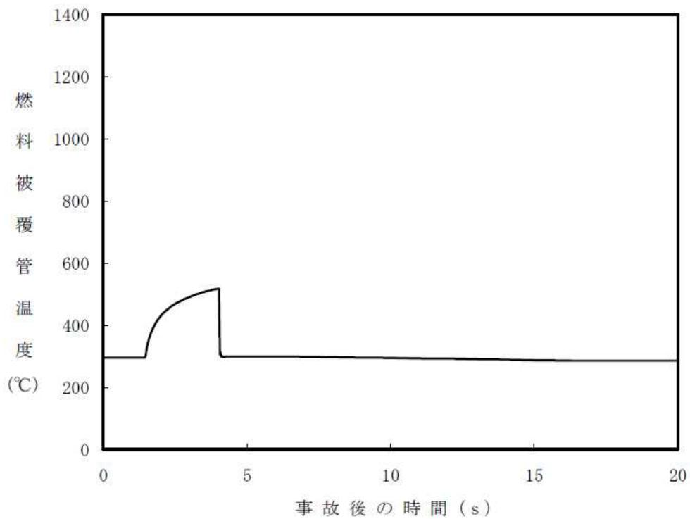
図 6-3 原子炉冷却材流量の喪失+給水制御系の故障解析結果 (R/B 起因)
