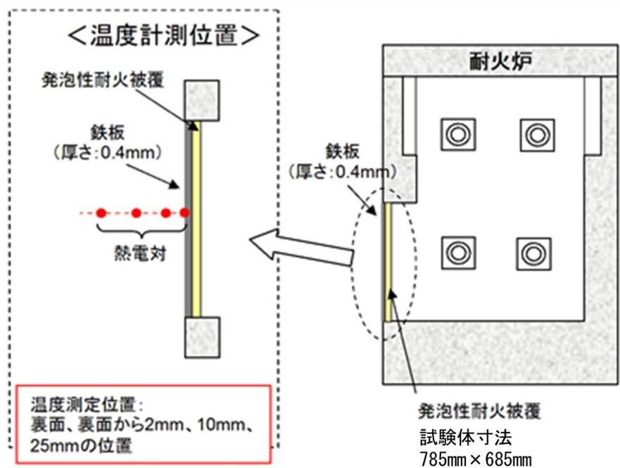
第 3-1 図 鉄板+発泡性耐火被覆 試験体
