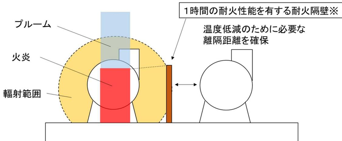
※片系側の火災に対し、FDTを用いて機器の損傷に関する火災影響範囲を算定。
