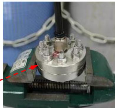
表1 He 気密確認試験結果（高温暴露後）
