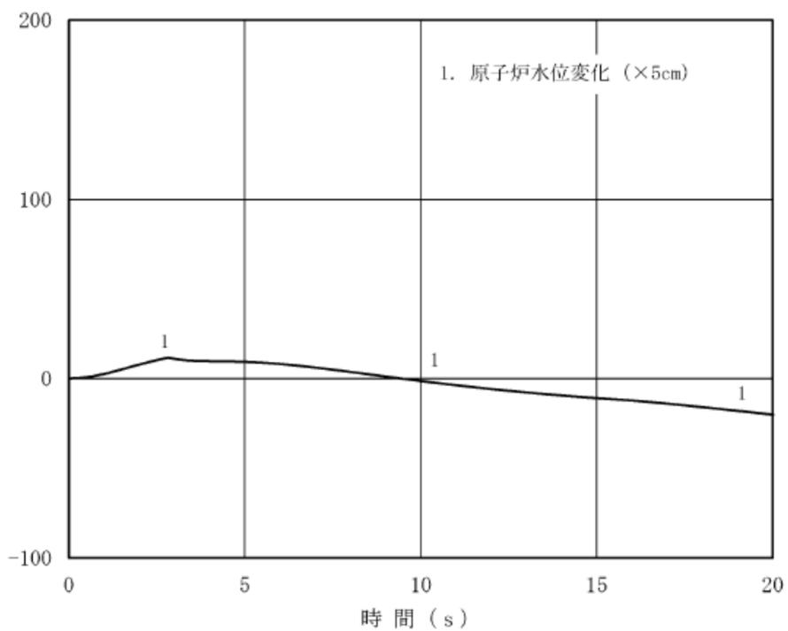
図 6-3 原子炉冷却材流量の喪失+給水制御系の故障解析結果 (R/B 起因)
