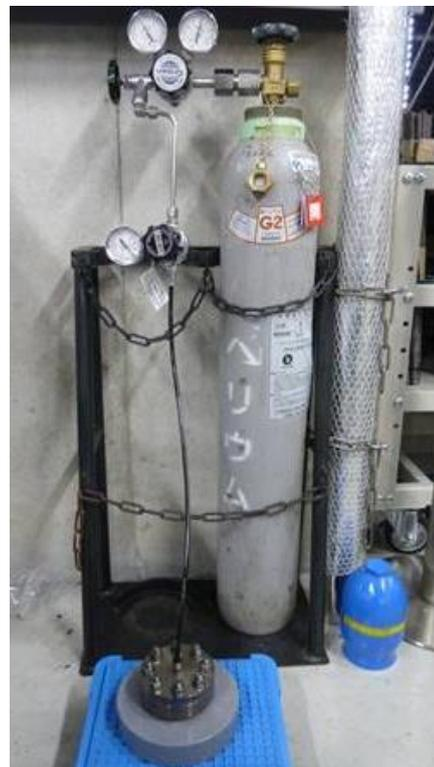
図 12 He 気密確認試験状況
