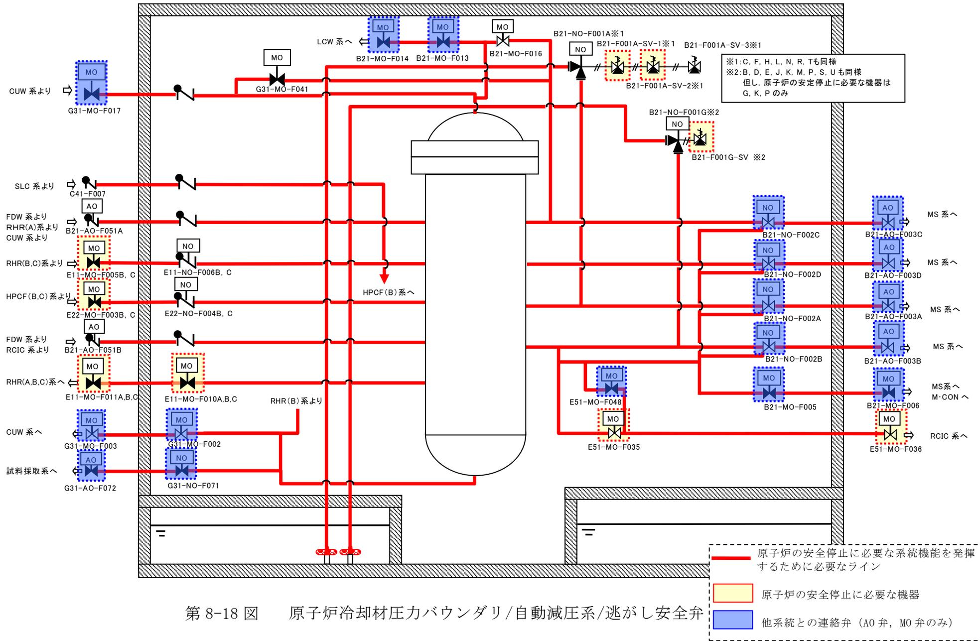
第8-18図 原子炉冷却材圧力バウンダリ/自動減圧系/逃がし安全弁
