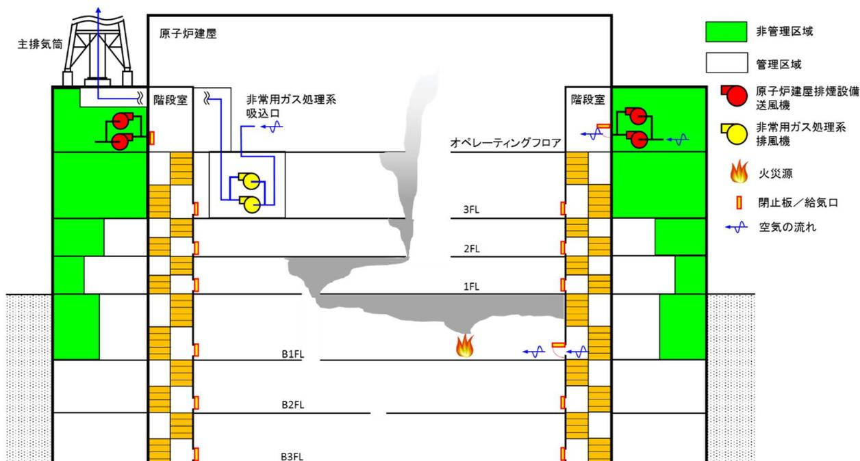
第1図 原子炉建屋排煙設備の系統概要図
