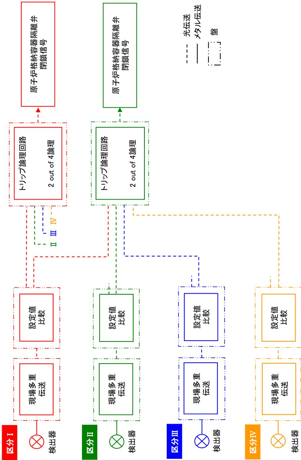
第 19 図：原子炉格納容器隔離の安全保護回路の概要図
