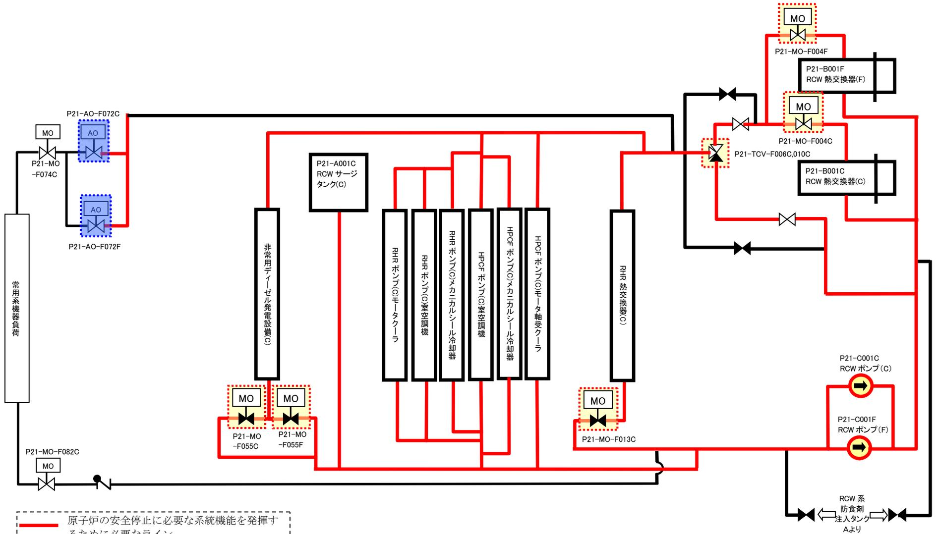
第 7 図 原子炉補機冷却系 (その 2)
