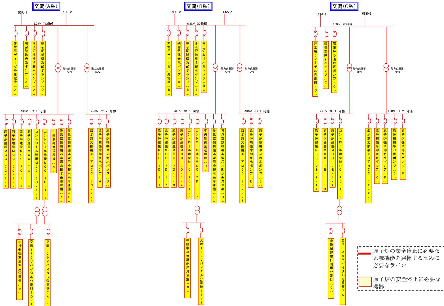
第 15 図 交流電源単線結線図 (非常用所内電源設備)
