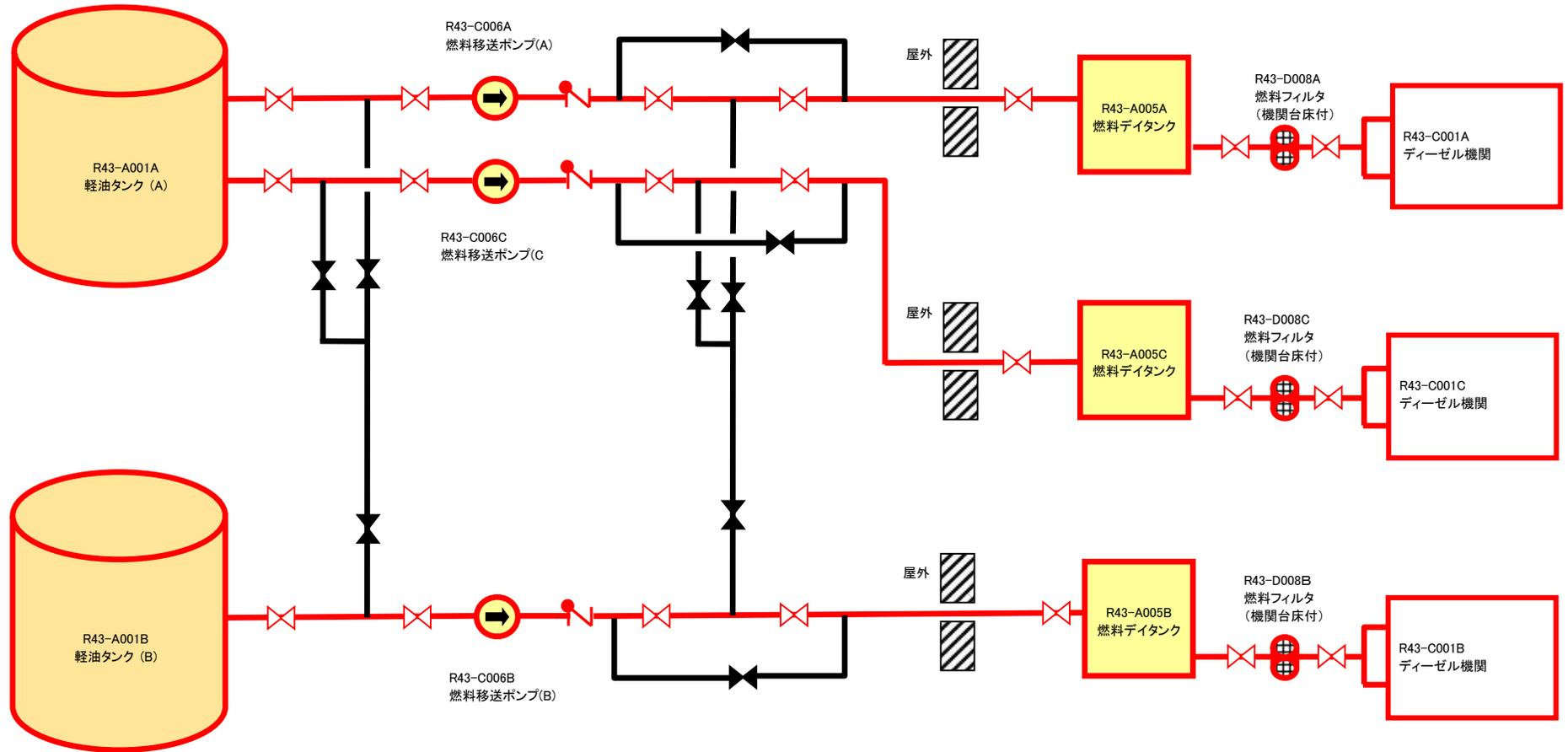
第 11 図 非常用ディーゼル発電機設備燃料移送系
