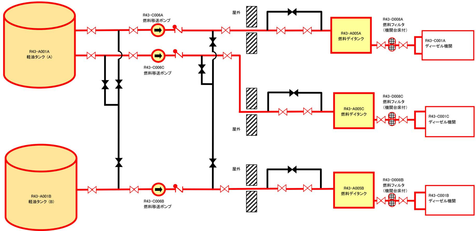
第 11 図 非常用ディーゼル発電機設備燃料移送系
