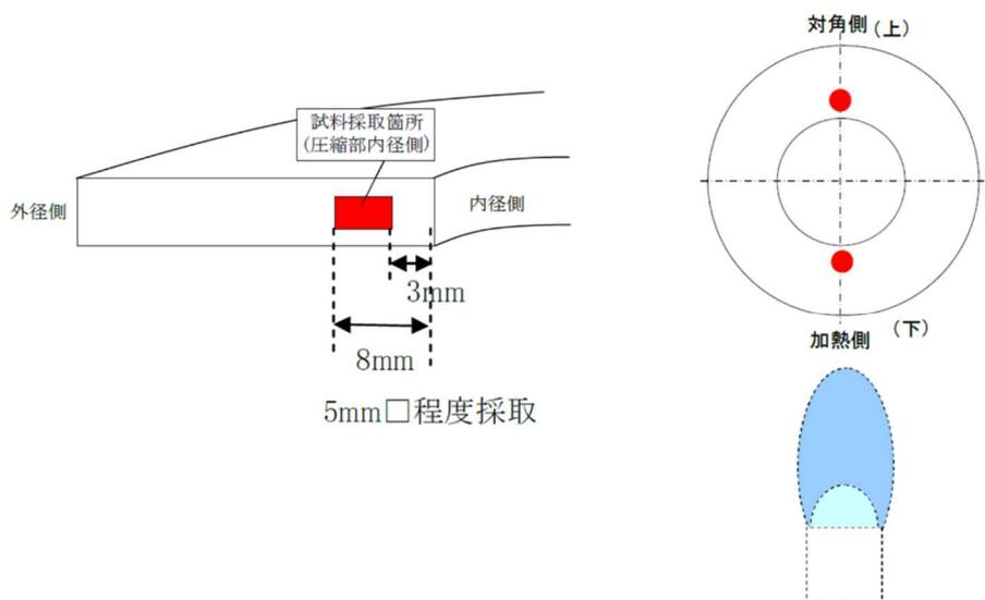
第3図 熱重量測定の実験箇所
