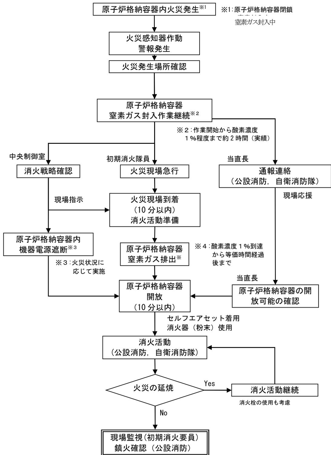
第 8-13 図 原子炉格納容器内での火災発生に対する対応フロー
