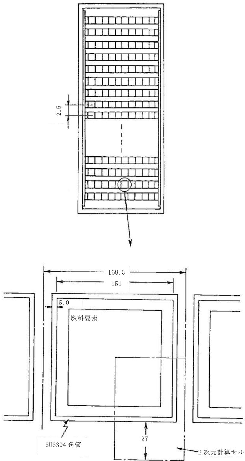
第1図：6号炉新燃料貯蔵ラック寸法図（単位：mm）
