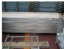
③-41 仮設足場板
