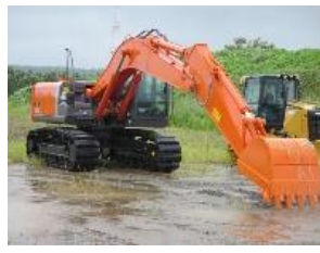
③-32 建設重機 (バックホー)
