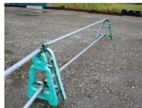
④-41 鋼製車止め (単管バリケード)
