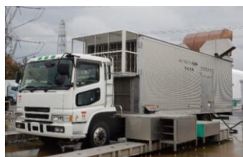
①-38 常設代替交流電源設備 (ガスタービン発電機)
