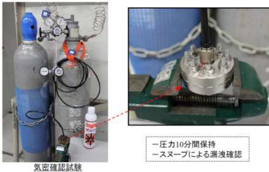
図 3-11 バックアップシール材イメージ図
