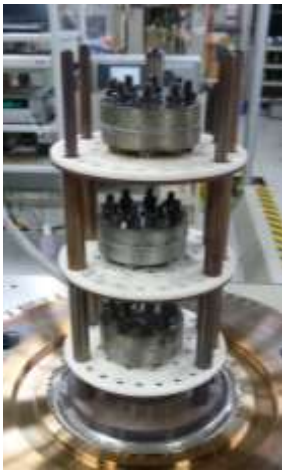
図3 蒸気曝露 試験片設置状況
