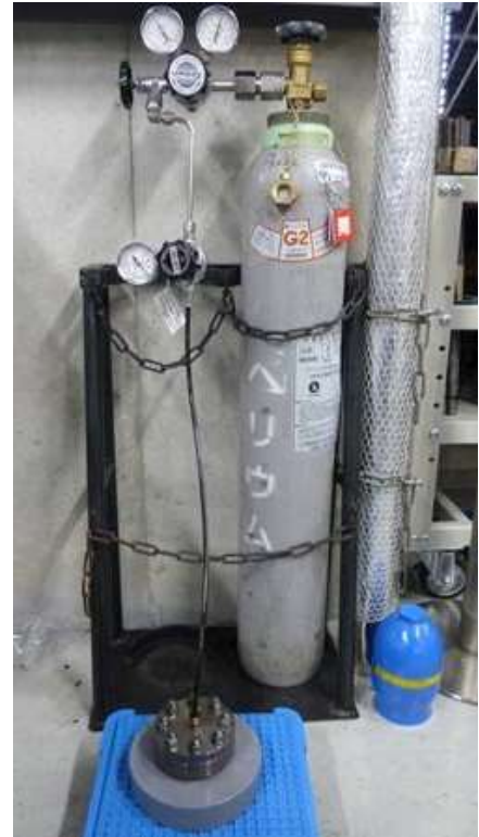
図 12 He 気密確認試験状況
