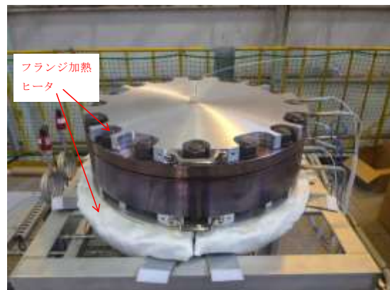
試験装置外観 (フランジ密閉時)
