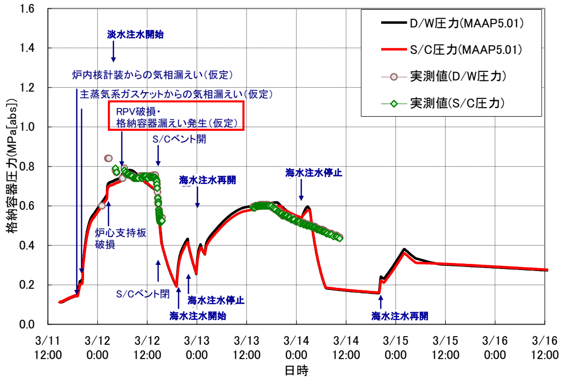
図 1-1 1号機 格納容器圧力挙動
