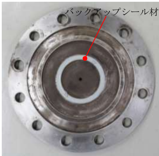
図 6 バックアップシール材塗布状況 (1.5mm 厚さ)
