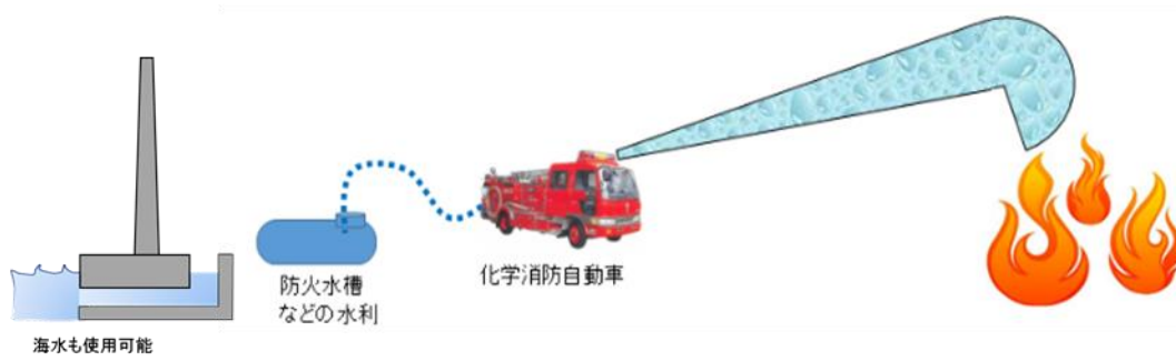
図 8-2 化学消防自動車による泡消火
