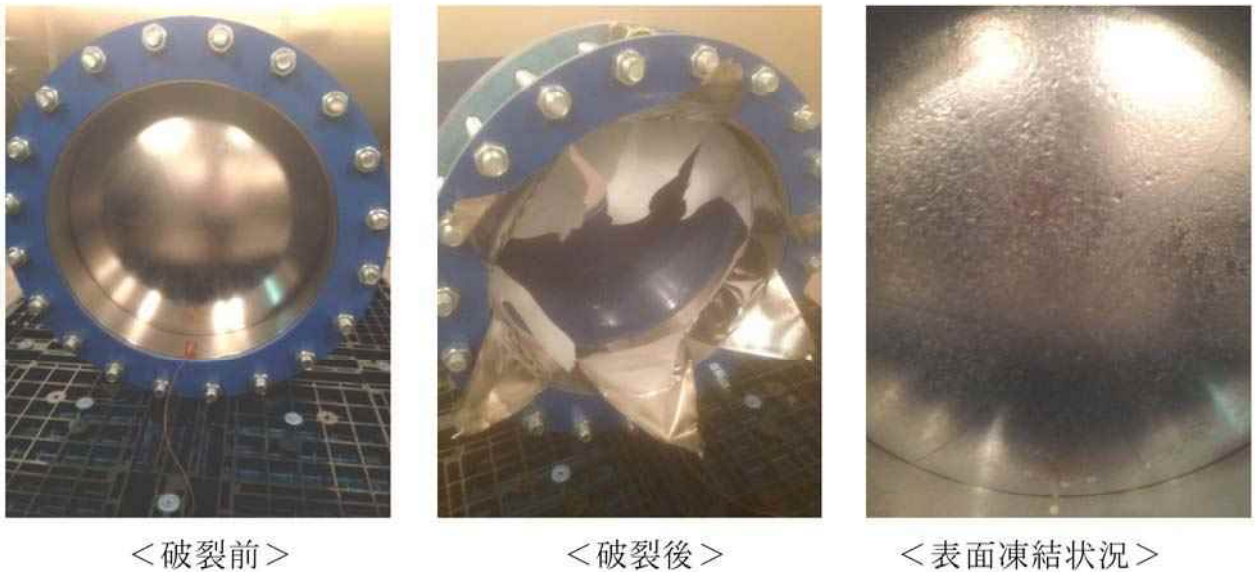
第3図 ラプチャーディスク破裂試験
