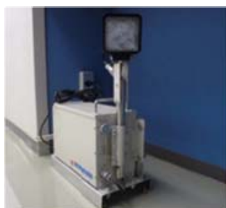
第 2 図 バッテリー内蔵型の照明
