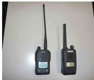
無線連絡設備（可搬型）
