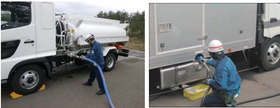
可搬型重大事故等対処設備への給油
