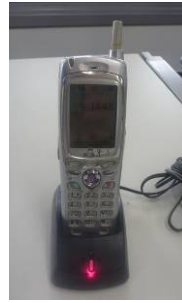
電力保安通信用電話設備 (PHS 端末)
