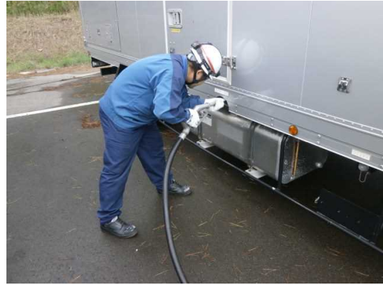
電源車への給油
