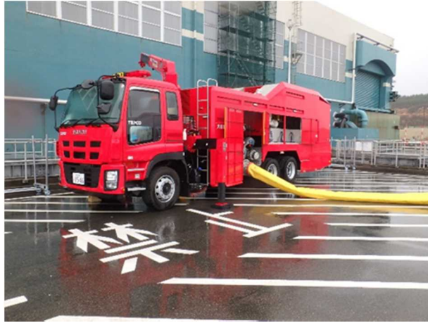
大容量送水車（海水取水用） （タービン建屋周辺）
