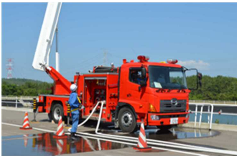
大型化学高所放水車の 遠隔操作状況
