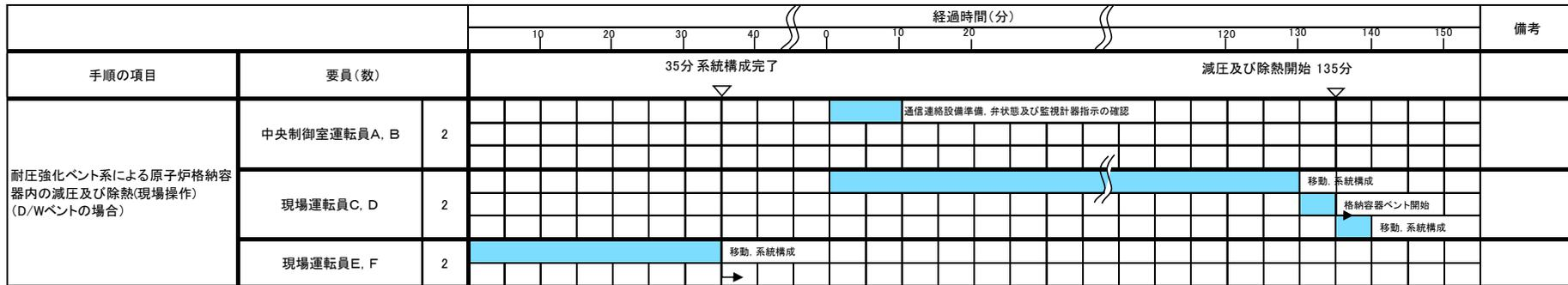
第 1.5.31 図 耐圧強化ベント系による原子炉格納容器内の減圧及び除熱（現場操作） タイムチャート
