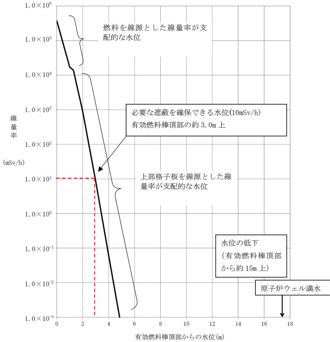
図 3 原子炉水位と線量率
