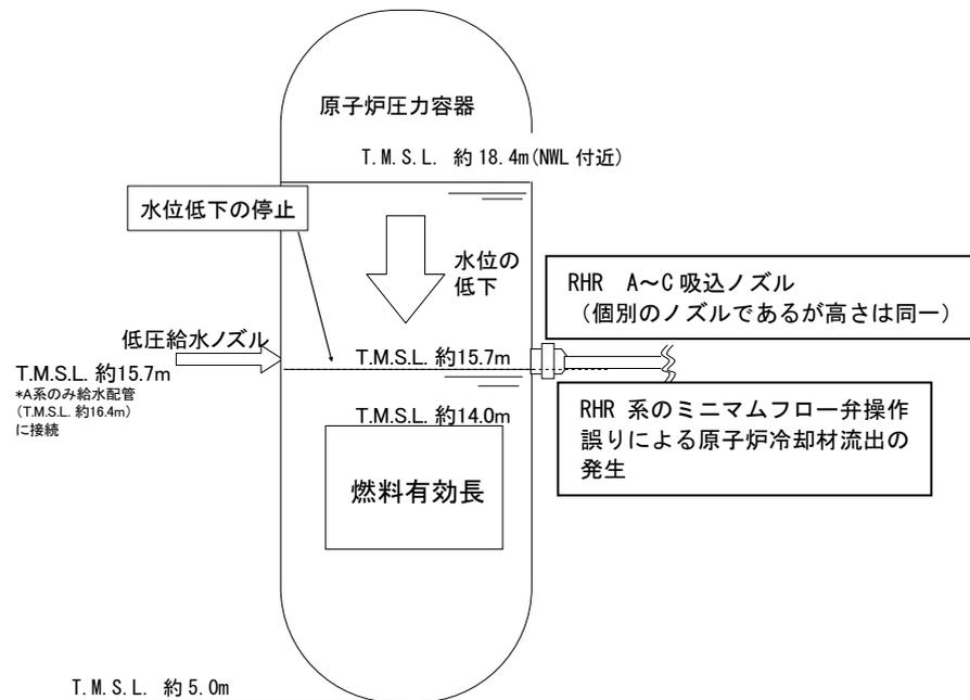
図 3 RHR 吸い込み配管のノズルの高さ と燃料有効長頂部の高さ
