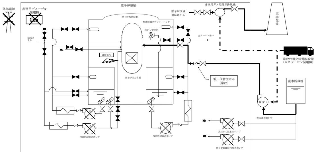
第 3.1.3.1 図 「雰囲気圧力・温度による静的負荷（格納容器過圧・過温破損）」の重大事故等対策の概略系統図（代替循環冷却系を使用しない場合）（1/3）
