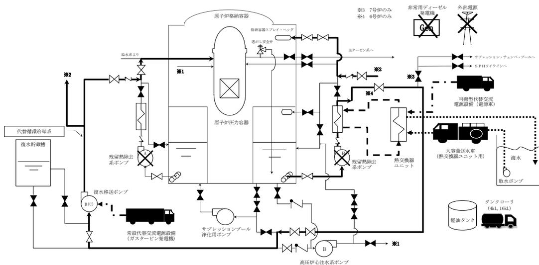
第 3. 1. 2. 4 図 「雰囲気圧力・温度による静的負荷（格納容器過圧・過温破損）」の重大事故等対策の概略系統図（代替循環冷却系を使用する場合）（4/4）
