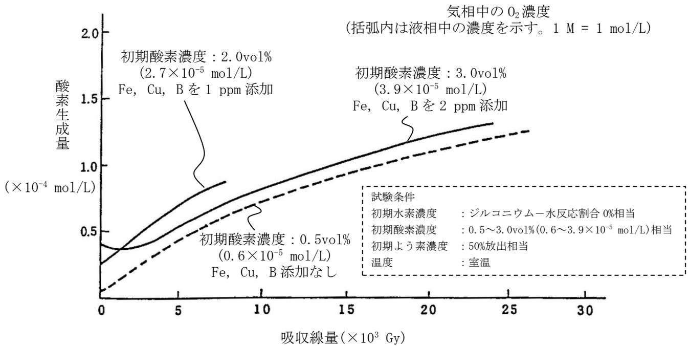
図3 溶存酸素濃度及び不純物(Fe, Cu, B)の有無と吸収線量の関係
