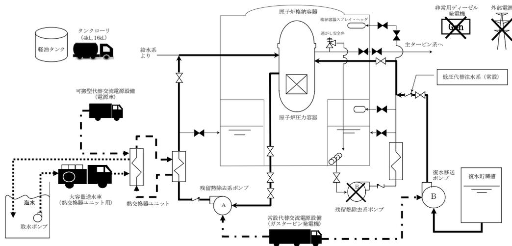
第 5.2.2 図 「全交流動力電源喪失」の重大事故等対策の概略系統図 (2/2)
