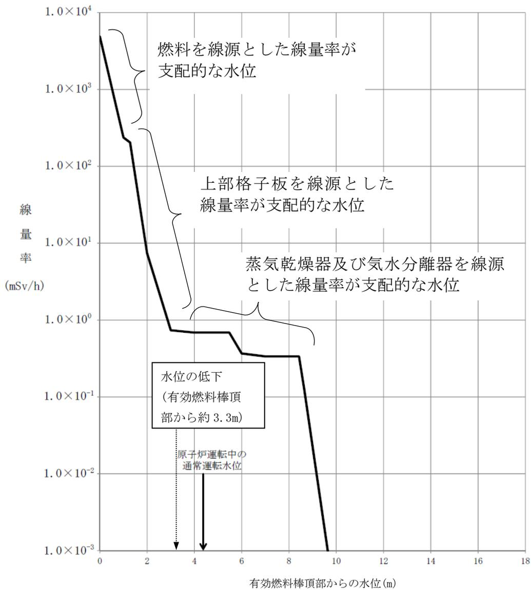
第 5. 1. 6 図 原子炉水位と線量率
