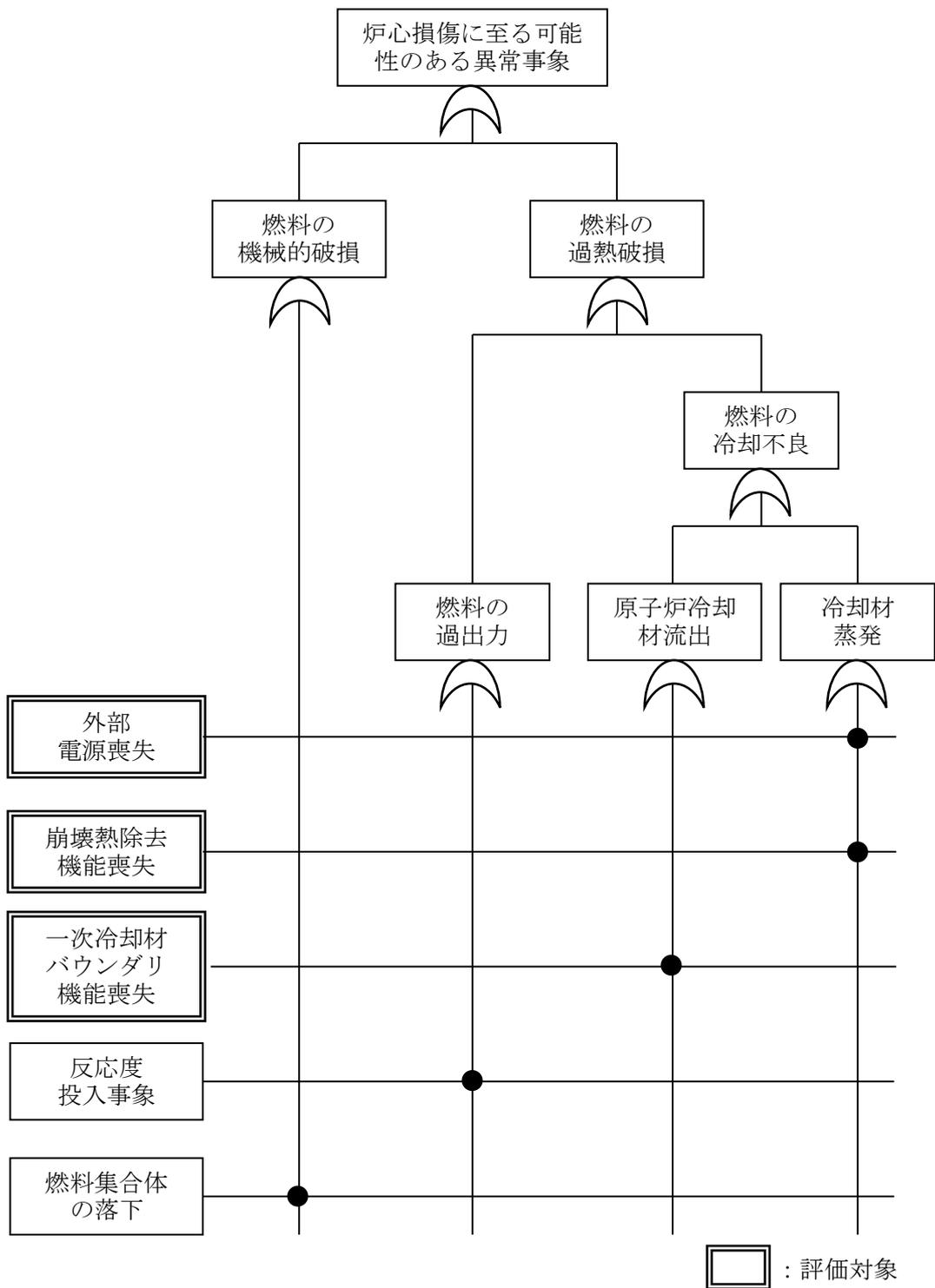
第1図 炉心損傷に至る可能性のある異常事象
