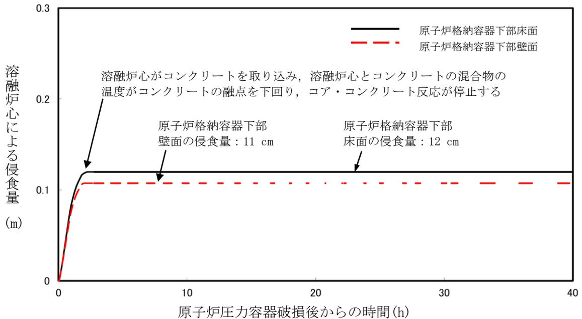
(b) 初期水張り水位 1 m の場合 (溶融炉心の崩壊熱：事象発生から 6 時間後、上面熱流束：800kW/m<sup>2</sup> 相当 (圧力依存なし))
