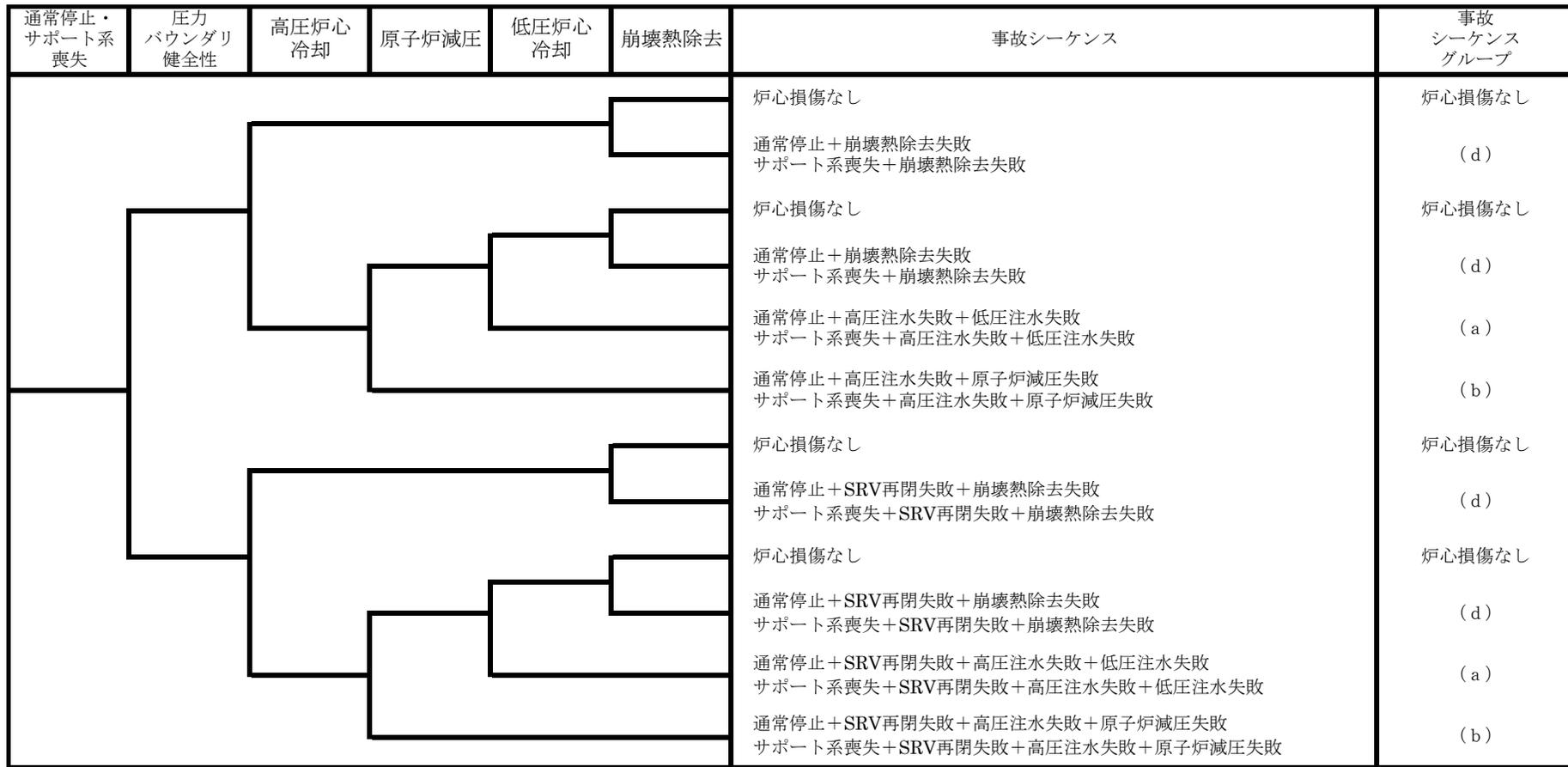
(a) 高圧・低圧注水機能喪失      (b) 高圧注水・減圧機能喪失      (d) 崩壊熱除去機能喪失
