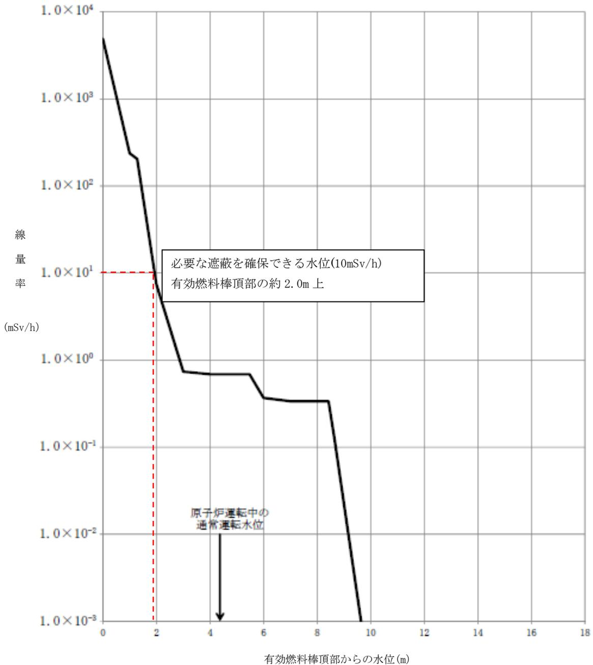
図 10 原子炉水位と炉心燃料及び上部格子板からの線量率
