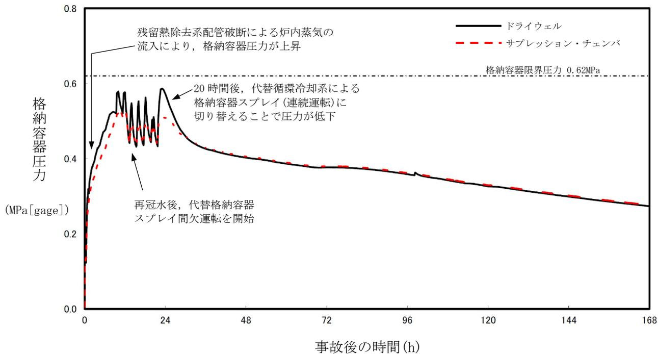
図 1 格納容器圧力の推移 (感度解析 1)
