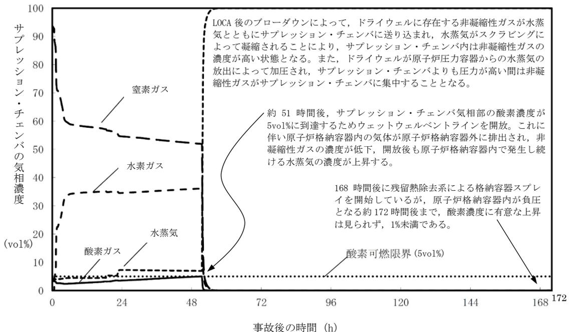
第 3.4.18 図 G 値を設計基準事故ベースとした場合のサブプレッション・チェンバの気相濃度の推移 (ウェット条件) (事象発生から 168 時間後に残留熱除去系によるドライウエルスプレイ (954m<sup>3</sup>/h) を連続で実施)
