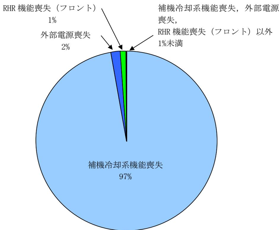
全炉心損傷頻度 :  $1.1 \times 10^{-8}$  (/定検)
