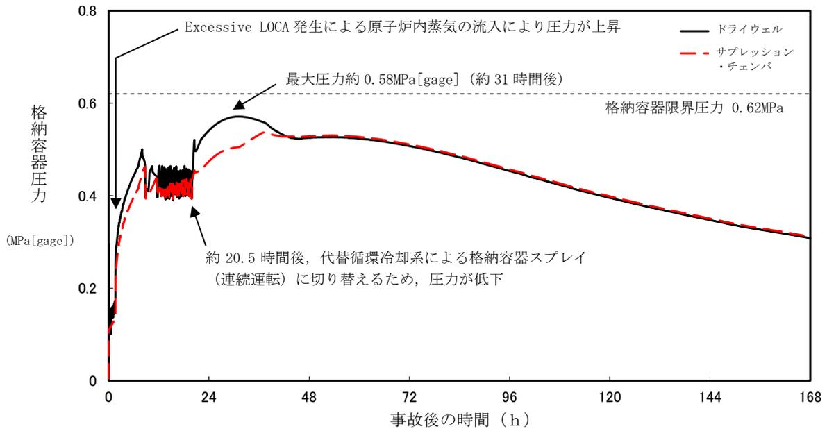
図1 格納容器圧力の推移
