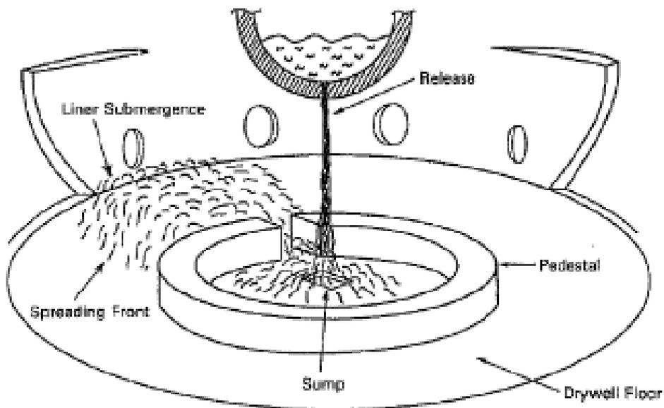
第2図 BWR MARK-I型格納容器における溶融炉心のペデスタル外側への流出のイメージ<sup>[1]</sup>
