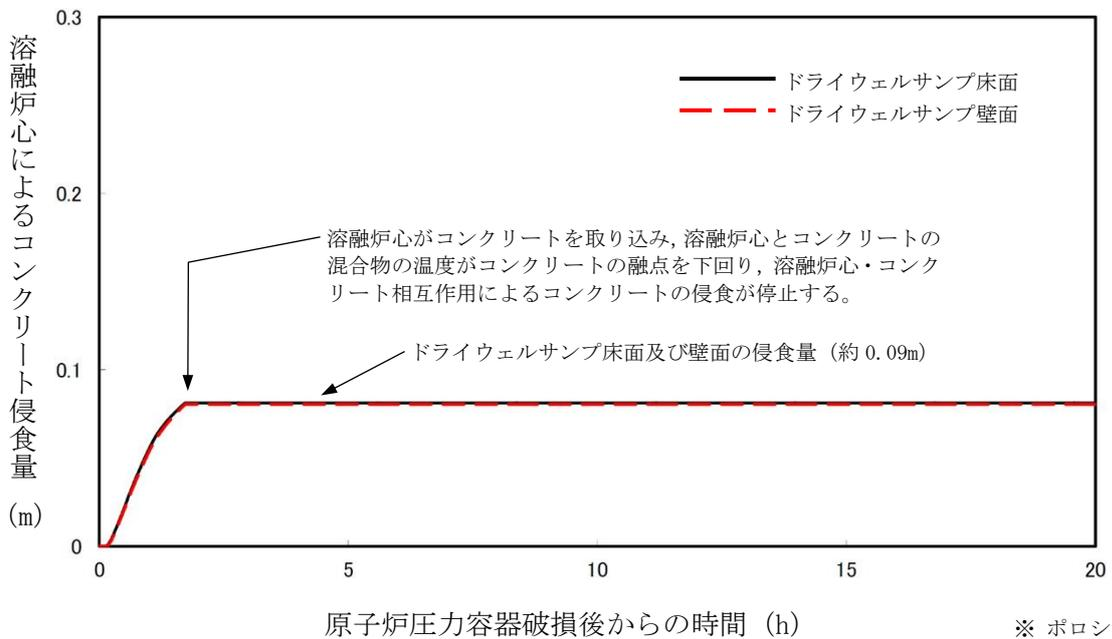
図4 原子炉格納容器下部床面及び壁面のコンクリート侵食量の推移
