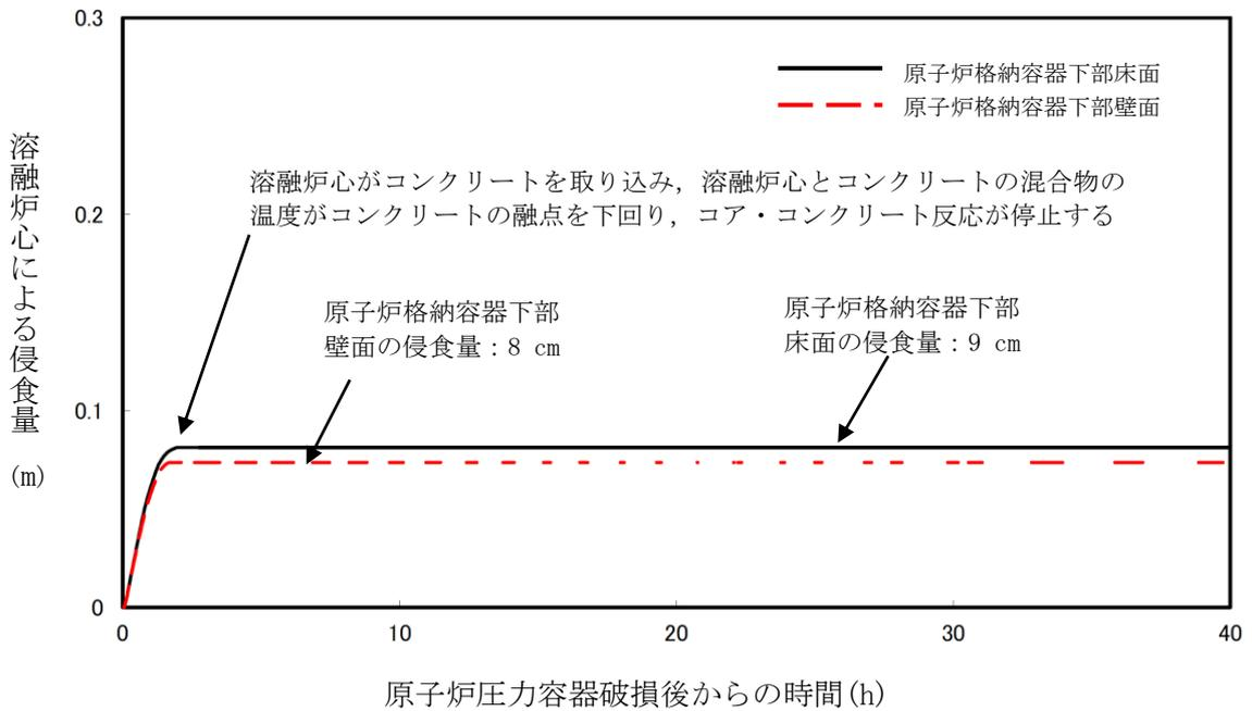
(a) 初期水張り水位 2 m の場合 (溶融炉心の崩壊熱：事象発生から 6 時間後、上面熱流束：800kW/m<sup>2</sup> 相当 (圧力依存なし))
