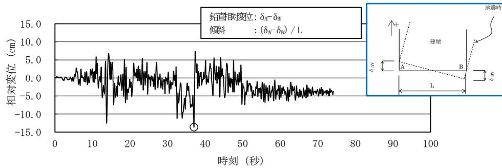
第5図 6号炉原子炉建屋の鉛直相対変位量 (UHS(10<sup>-6</sup>)相当地震波)
