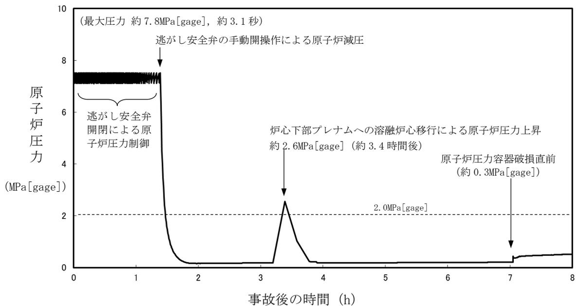
第 3.5.1 図 原子炉圧力の推移
