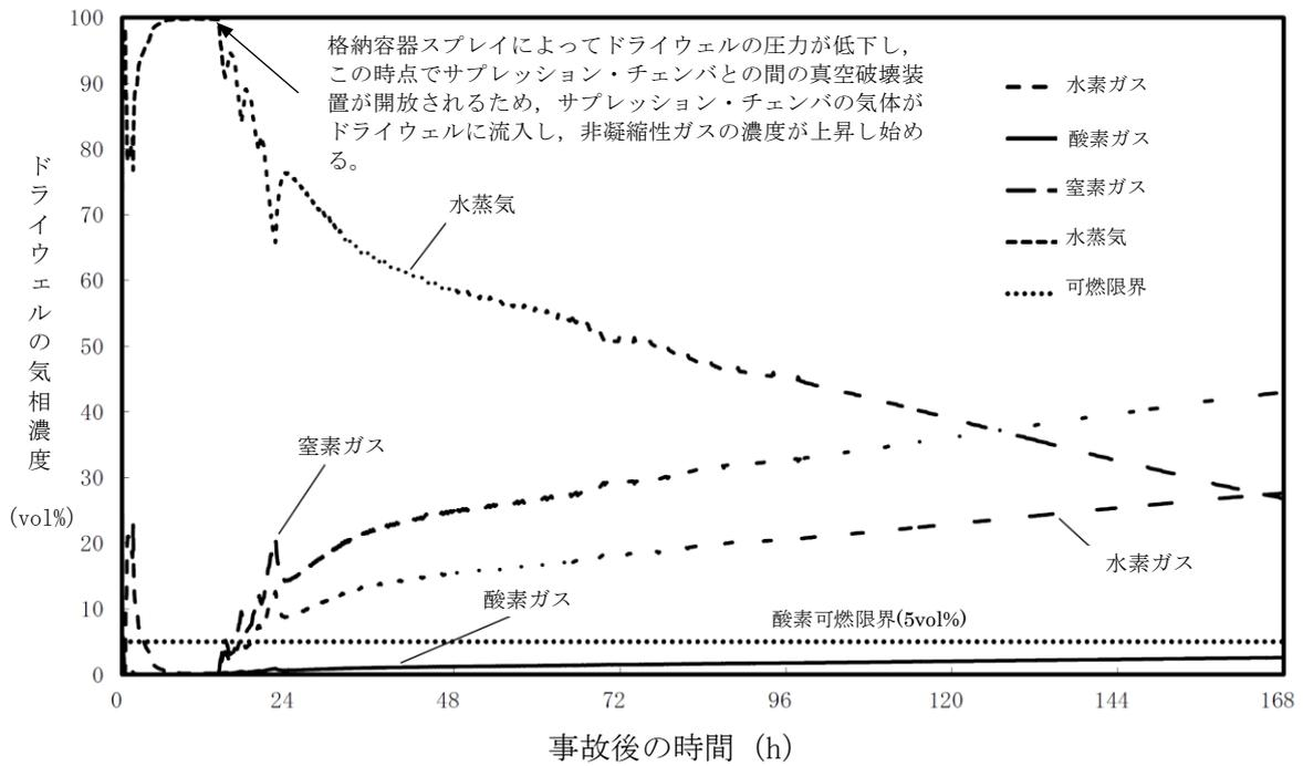
第 3. 4. 9 図 事象発生から 90 分後に注水を開始した場合のドライウエルの気相濃度の推移 (ウェット条件)
