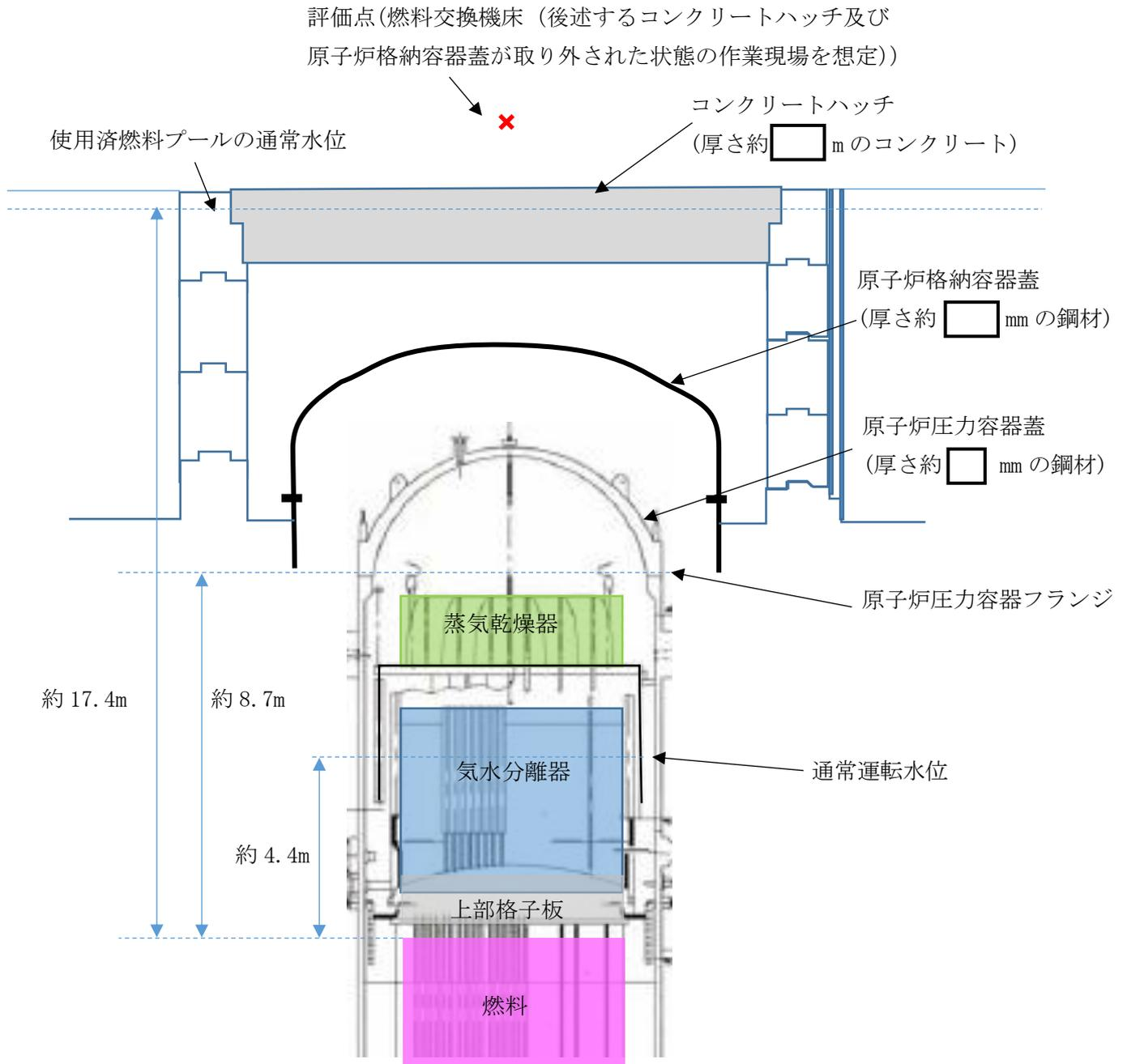
図 2 原子炉圧力容器等構造物の概要
