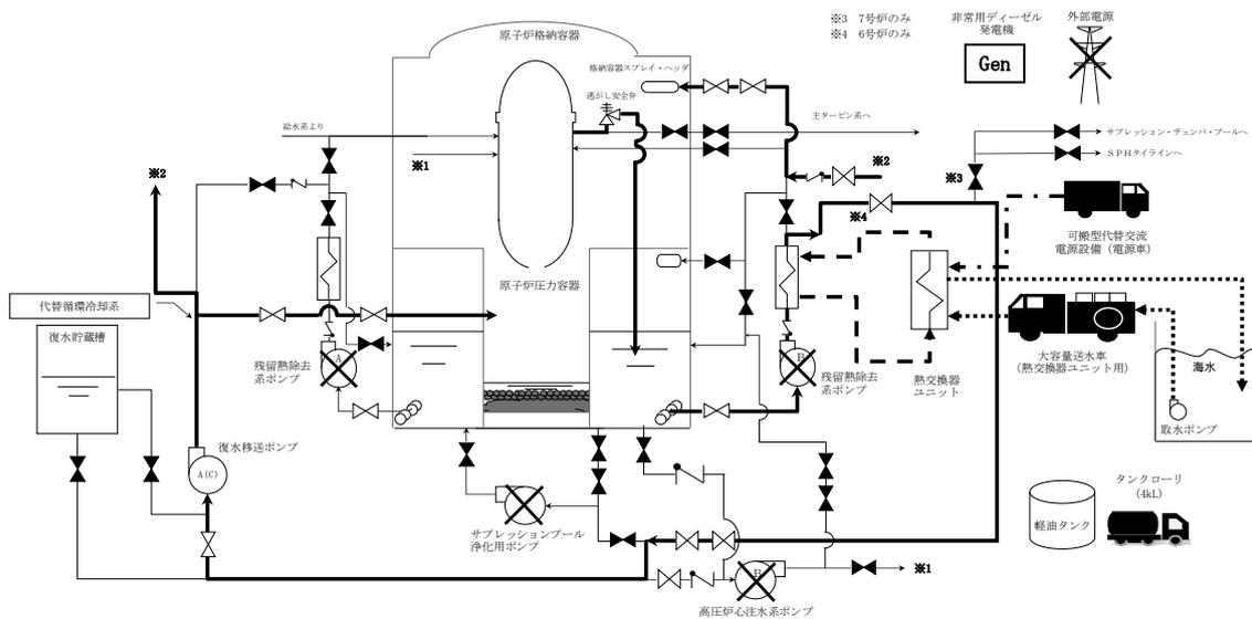
第 3.2.4 図 「高圧溶融物放出／格納容器雰囲気直接加熱」の重大事故等
