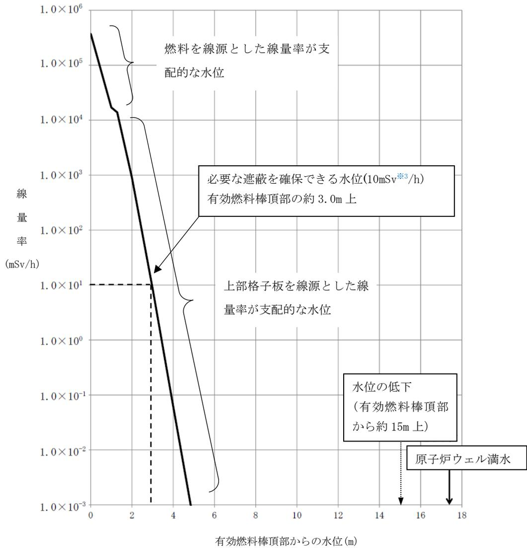
第 5.3.6 図 原子炉水位と線量率
