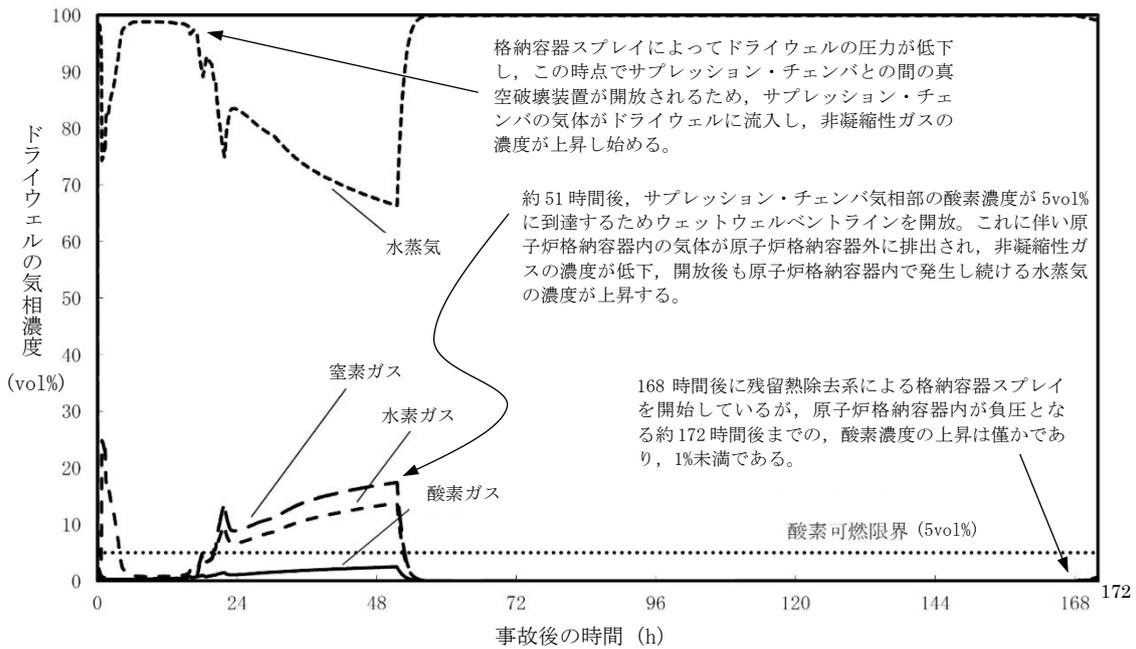
第 3.4.17 図 G 値を設計基準事故ベースとした場合のドライウエルの気相濃度の推移 (ウェット条件) (事象発生から 168 時間後に残留熱除去系によるドライウエルスプレイ (954m<sup>3</sup>/h) を連続で実施)
