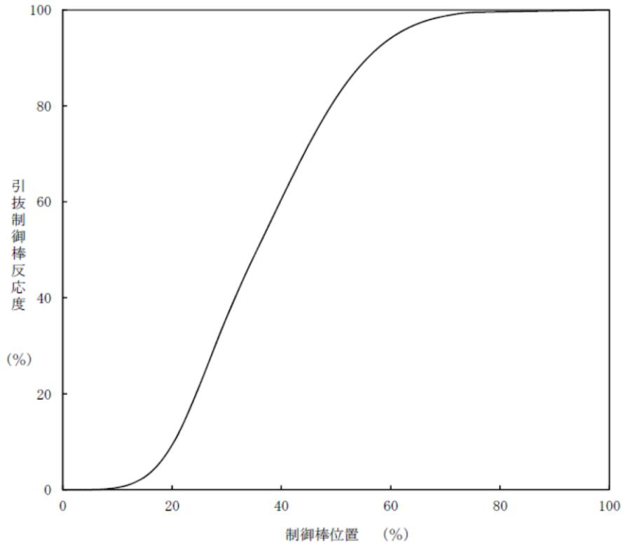
第 5.4.2 図 引抜制御棒反応度曲線
