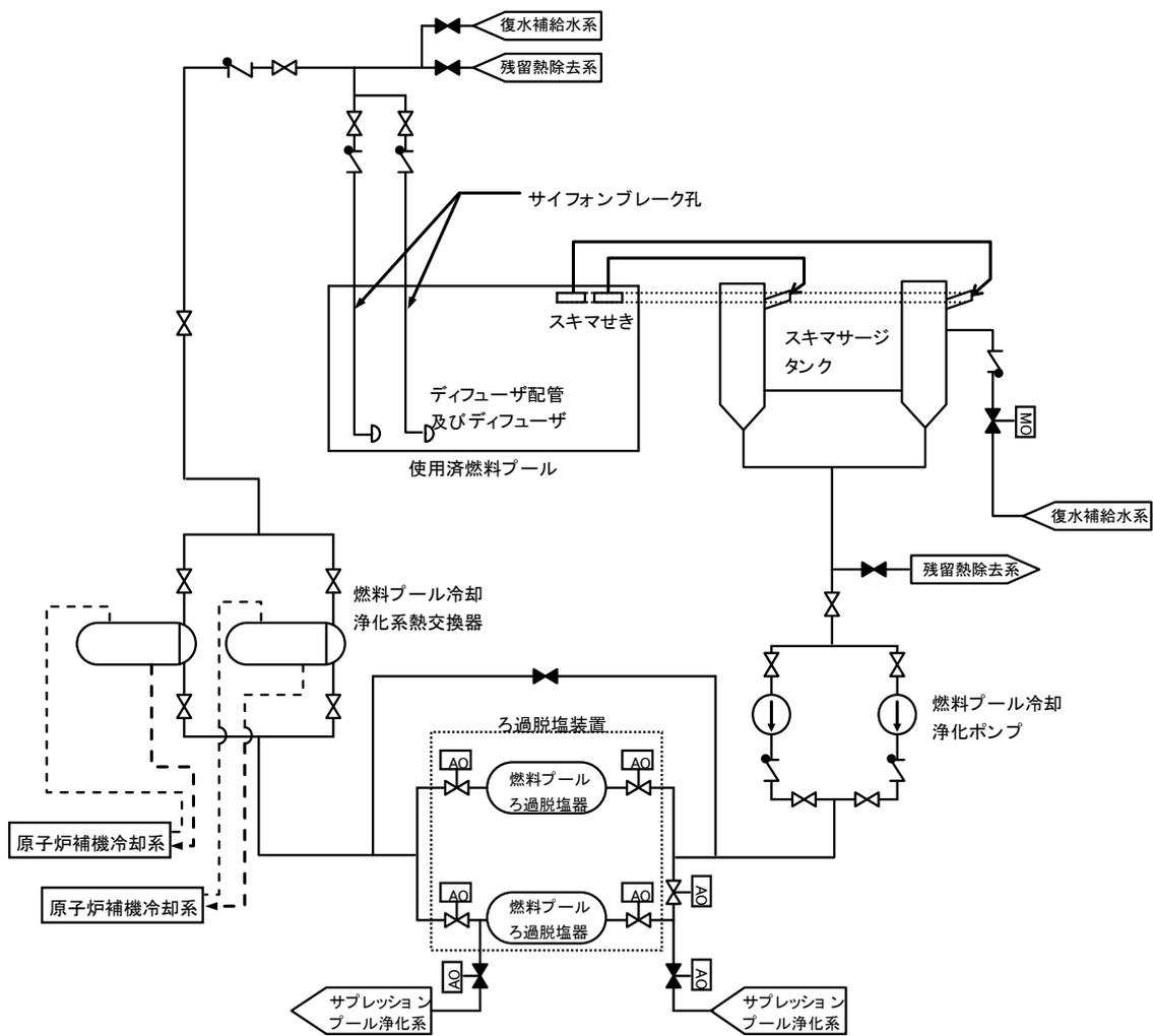
図1 燃料プール冷却浄化系 系統概略図
