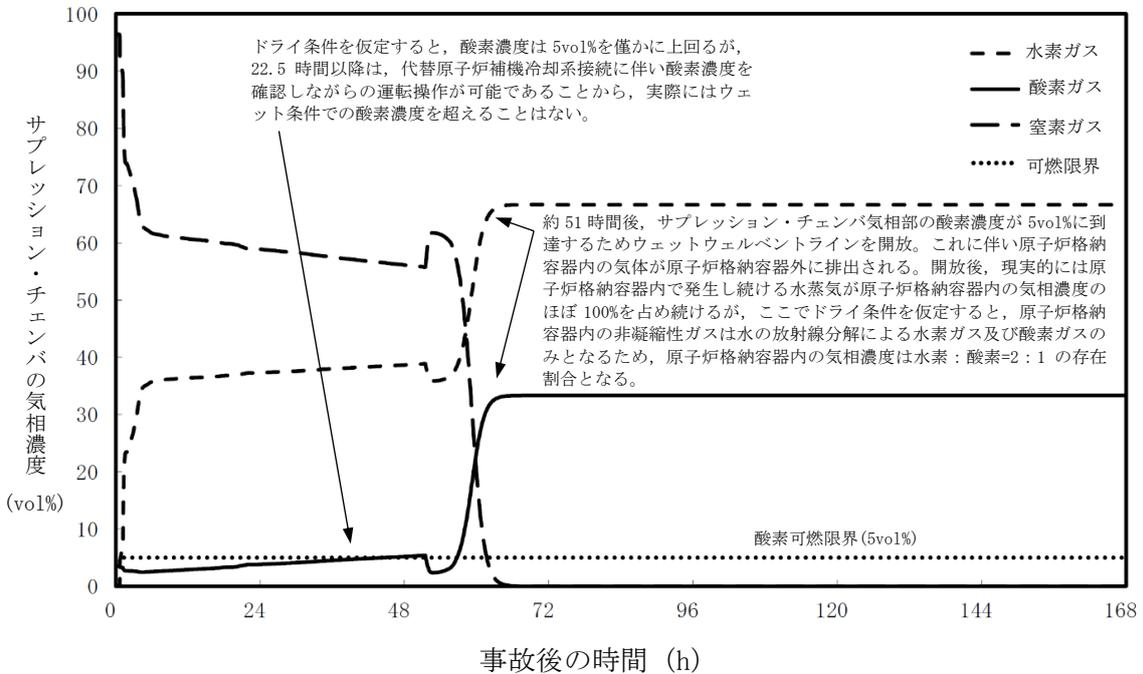
第 3.4.15 図 G 値を設計基準事故ベースとした場合のサブプレッション・チェンバの気相濃度の推移 (ドライ条件)
