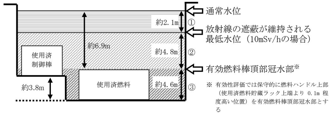
図3 6号及び7号炉の使用済燃料プールの構造高さ
