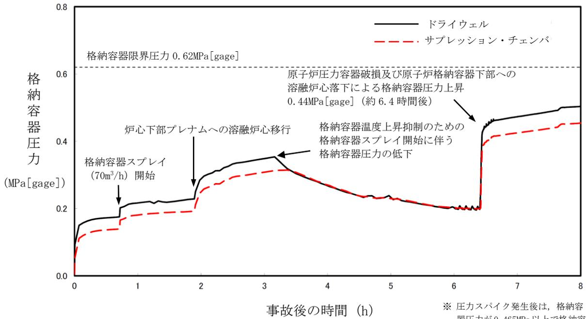
図 1 格納容器圧力の推移
