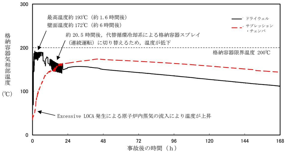
図2 格納容器気相部温度の推移
