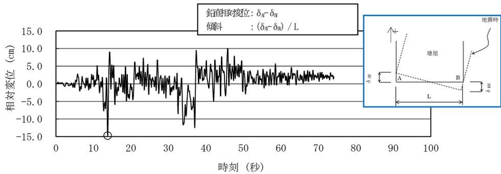
第6図 7号炉原子炉建屋の鉛直相対変位量 (UHS(10<sup>-6</sup>)相当地震波)
