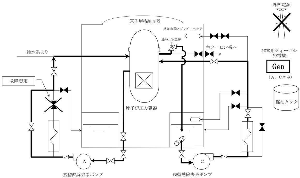
第 5.1.1 図 「崩壊熱除去機能喪失」の重大事故等対策の概略系統図 (1/2)
