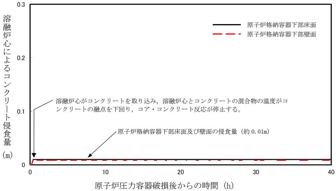
図3 原子炉格納容器下部床面及び壁面のコンクリート侵食量の推移
