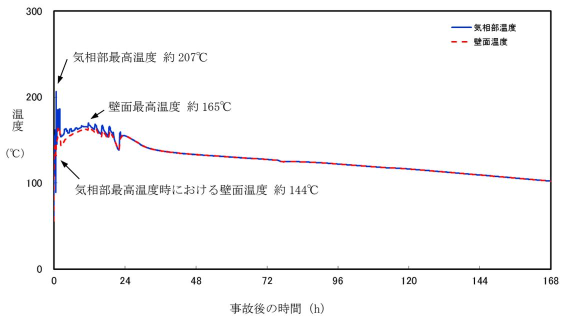
図1 原子炉格納容器の気相部温度と壁面温度の推移
