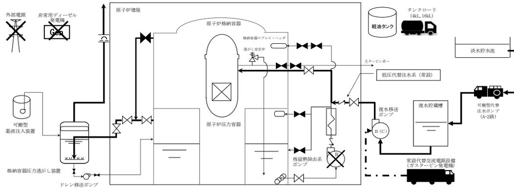
第 3. 1. 3. 3 図 「雰囲気圧力・温度による静的負荷（格納容器過圧・過温破損）」の重大事故等対策の概略系統図（代替循環冷却系を使用しない場合）(3/3)
