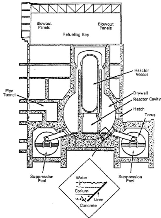
第1図 BWR MARK-I型格納容器におけるシェルアタックのイメージ(側面図)<sup>[1]</sup>
