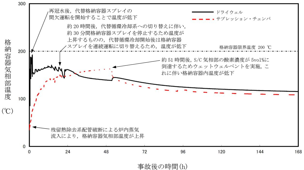
図2 格納容器気相部温度の推移
