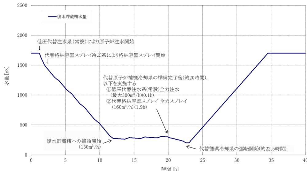
7日間における燃料の対応について（雰囲気圧力・温度による静的負荷（格納容器過圧・過温破損）：代替循環冷却系を使用する場合）
