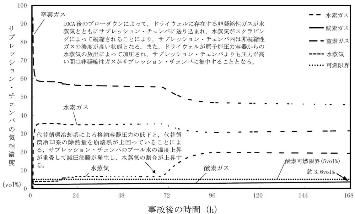
第 3. 4. 8 図 事象発生から 30 分後に注水を開始した場合のサプレッション・チェンバの気相濃度の推移 (ウェット条件)
