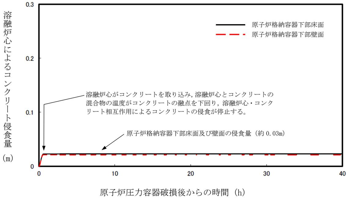
図1 原子炉格納容器下部床面及び壁面のコンクリート侵食量の推移
