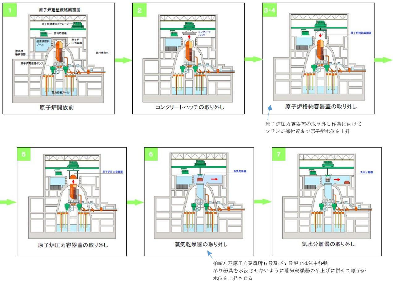
図 1 原子炉压力容器開放作業の流れ
