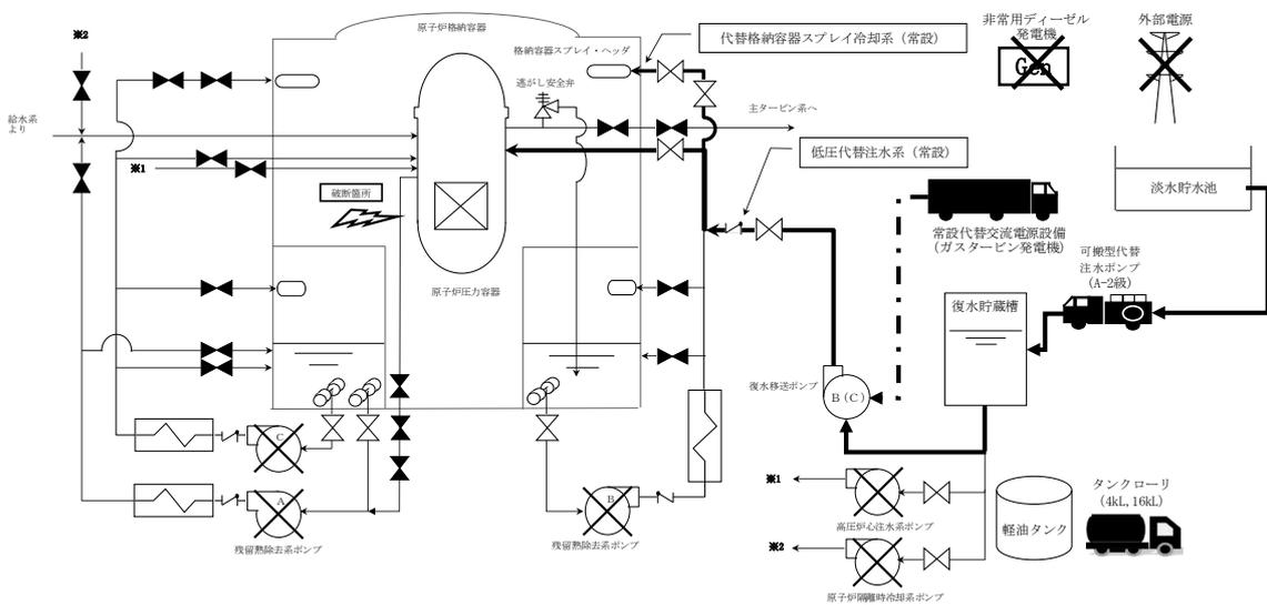
※低圧代替注水系（常設）と代替格納容器スプレー冷却系（常設）は、同じ復水移送ポンプを用いて弁の切替えにより実施する。
