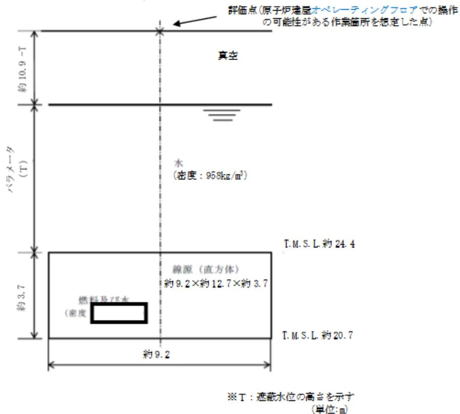
図 1 使用済燃料の線量率評価モデル
