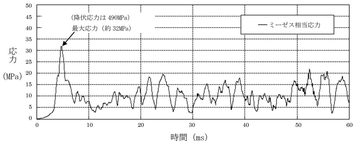
図2 原子炉格納容器下部内側鋼板の応力の推移<sup>※1</sup>
