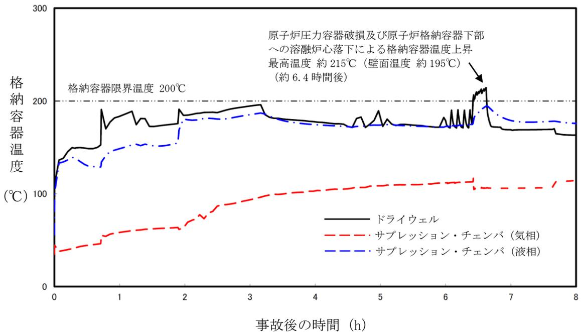
図 2 格納容器気相部温度の推移
