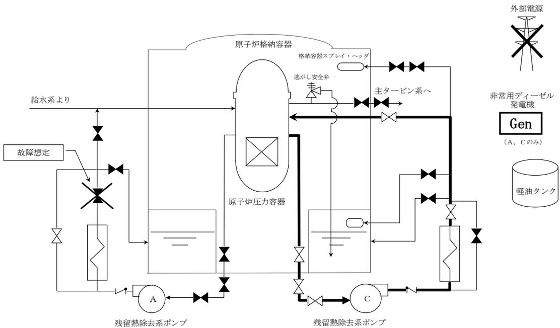
第 5.1.2 図 「崩壊熱除去機能喪失」の重大事故等対策の概略系統図 (2/2)
