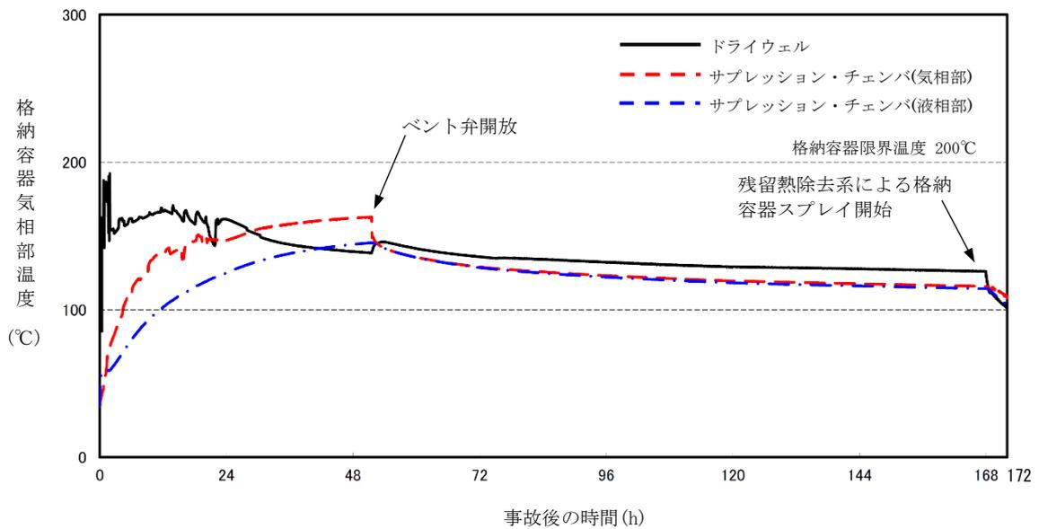
図8 格納容器気相部温度の推移(事象発生から168時間後に残留熱除去系によるドライウエルスプレイ(954m<sup>3</sup>/h)を連続で実施)
