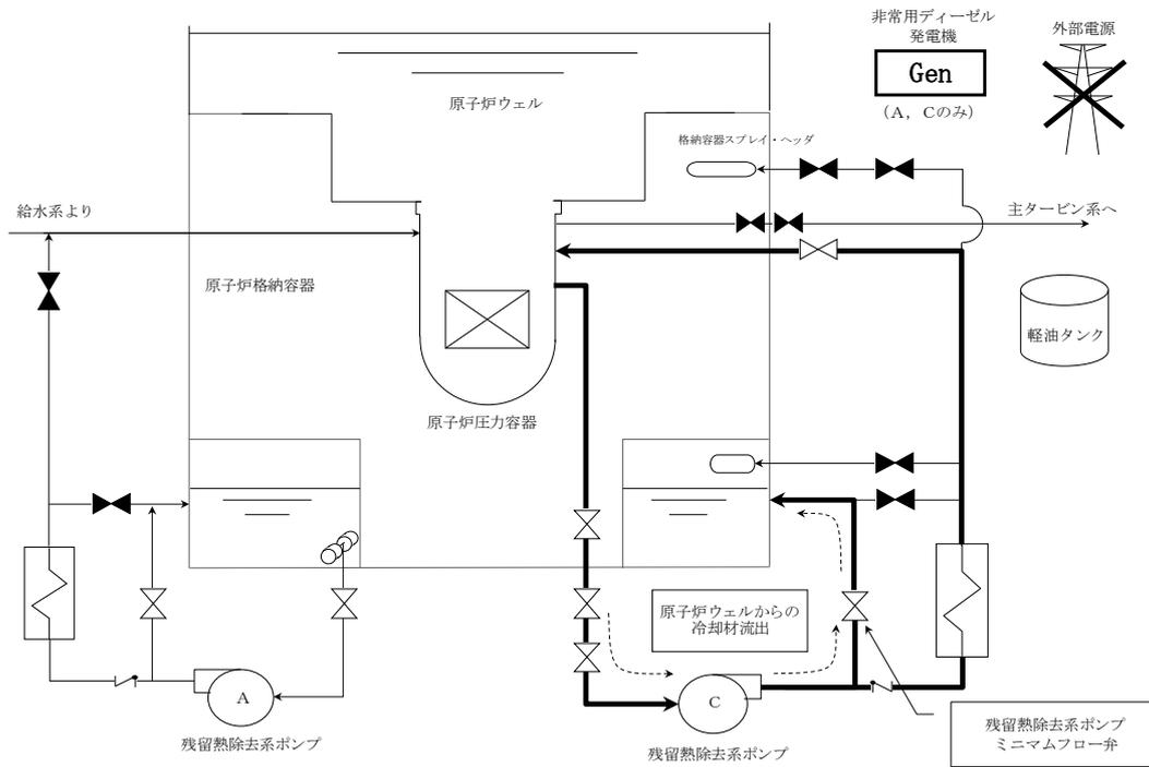
第 5.3.1 図 「原子炉冷却材の流出」の重大事故等対策の概略系統図(1/2)
