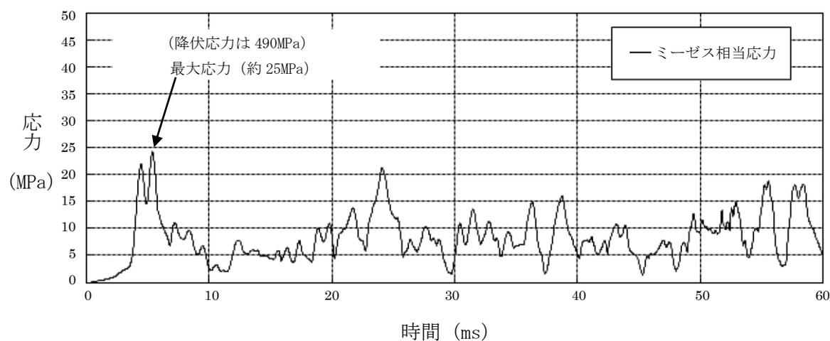
図3 原子炉格納容器下部外側鋼板の応力の推移<sup>※1</sup>
