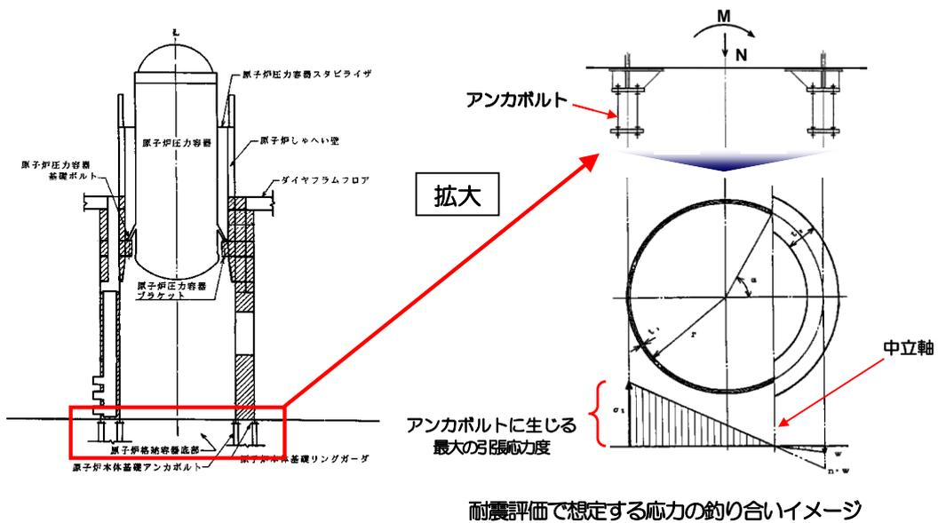
第10図 決定論による耐震評価のイメージ (アンカボルト)
