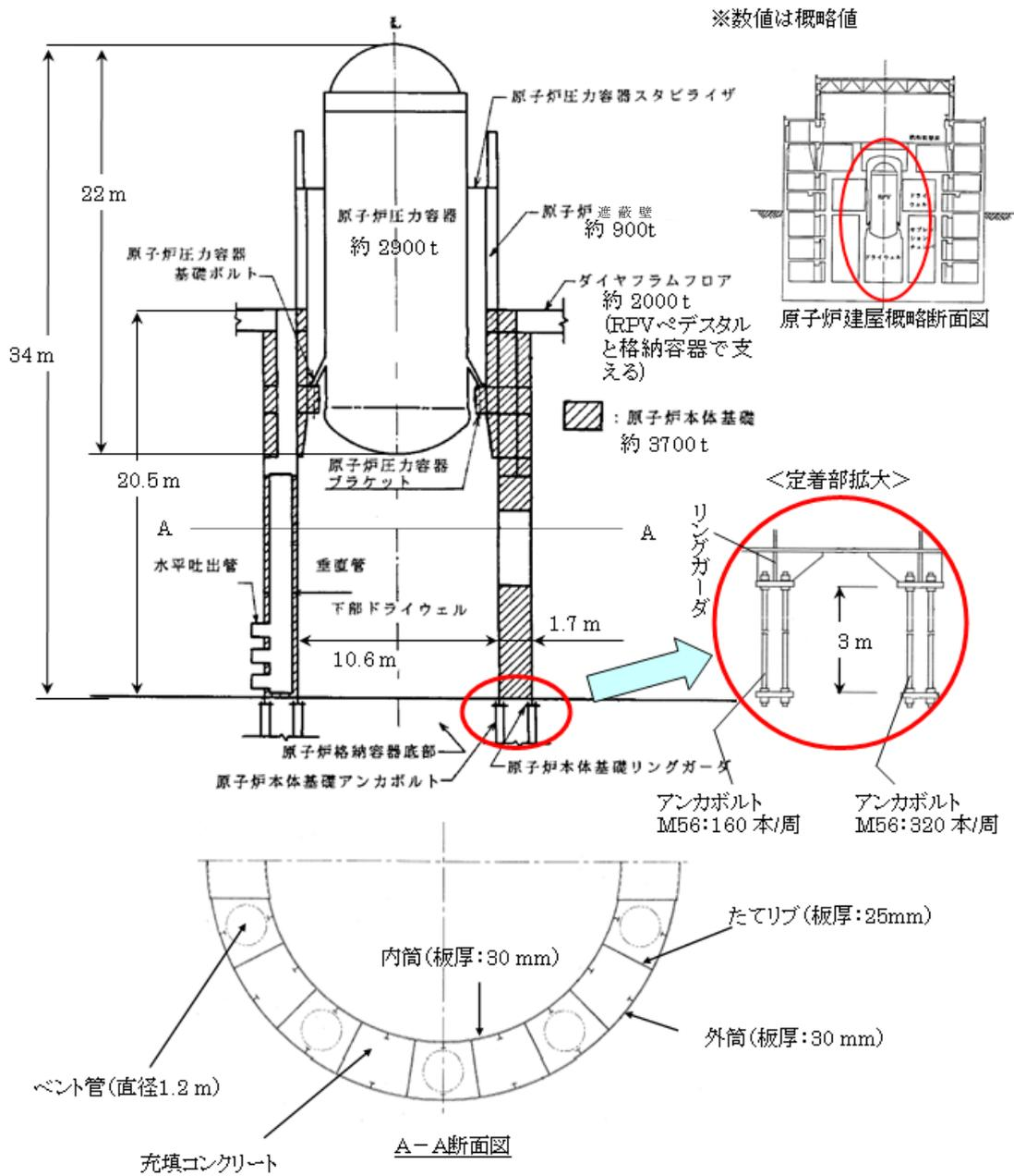
第 7 図 原子炉压力容器ペデスタルの概要図
