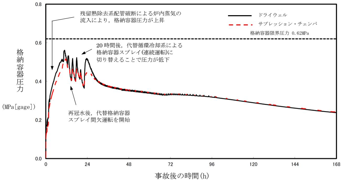
図5 格納容器圧力の推移 (感度解析 2)
