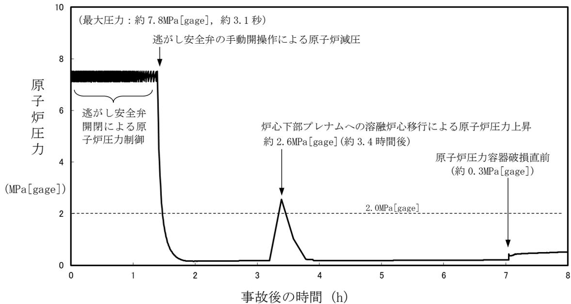
第 3.3.1 図 原子炉圧力の推移
