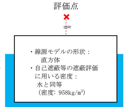
制御棒の線源モデル (一部露出時)
