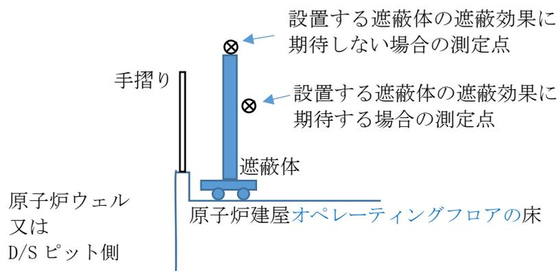
図5 蒸気乾燥器の移動範囲及び作業場所による線量率の測定点
