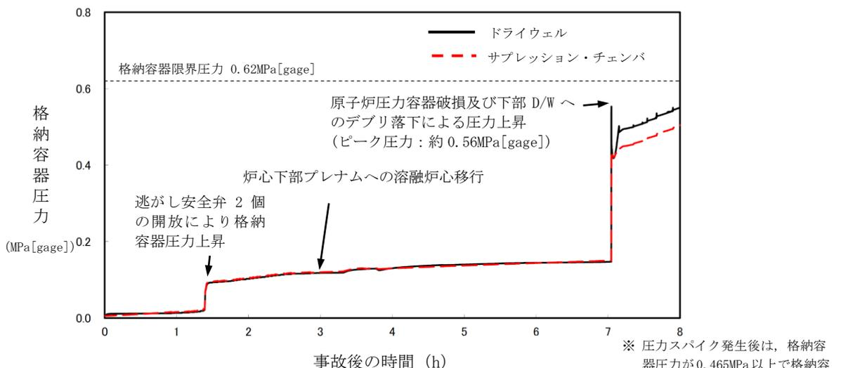
図3 格納容器圧力の時間的変化（感度解析ケース（最大値））
