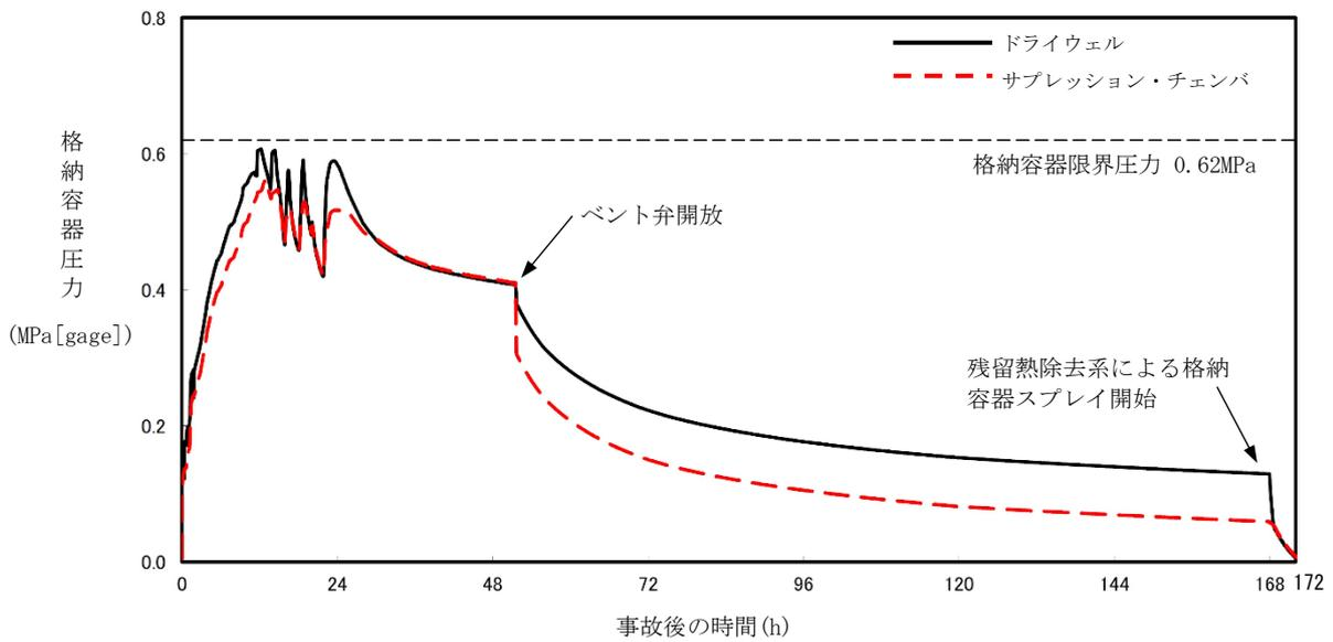
図7 格納容器圧力の推移(事象発生から168時間後に残留熱除去系によるドライウエルスプレイ(954m<sup>3</sup>/h)を連続で実施)
