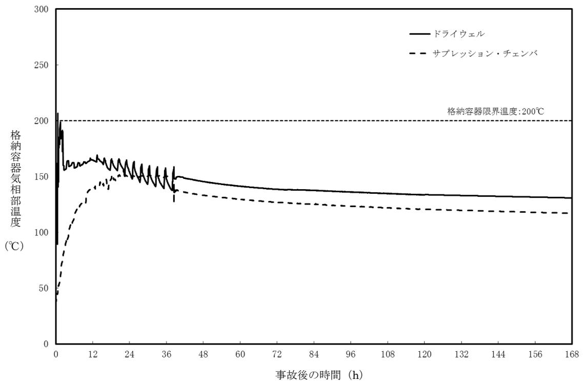
図 4. 操作 20 分遅れのケースにおける格納容器気相部温度の推移
