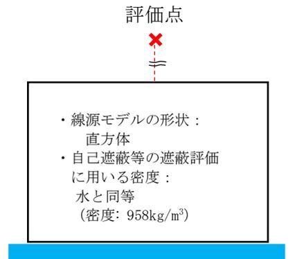
制御棒の線源モデル (露出時)
