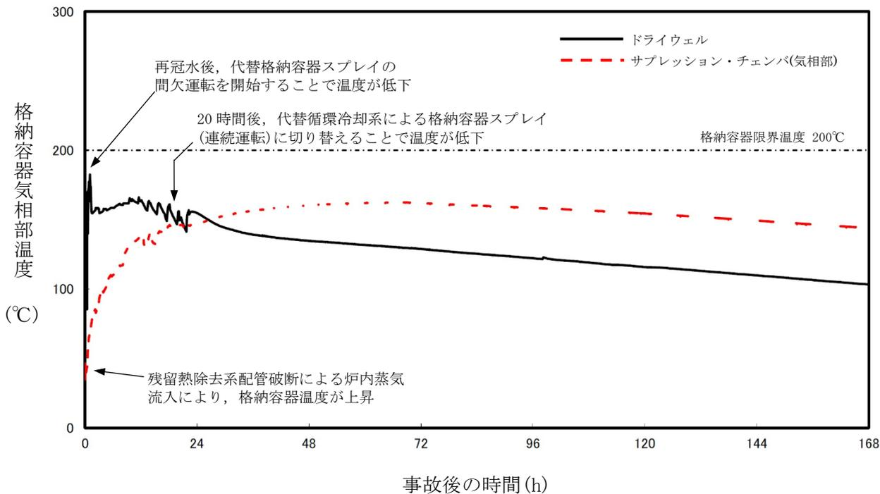
図 2 格納容器気相部温度の推移 (感度解析 1)
