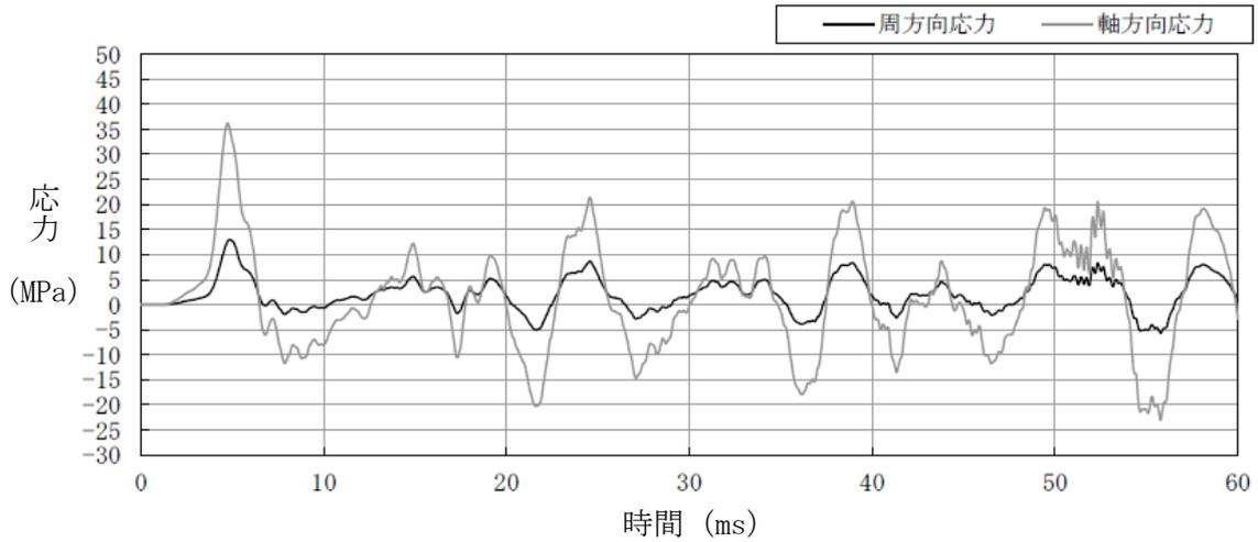
図4 内側鋼板の周方向及び軸方向応力の推移<sup>※1</sup>
