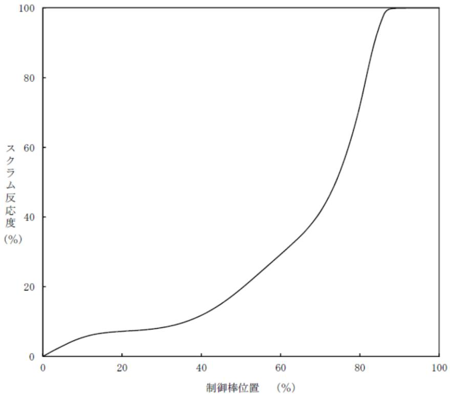
第 5.4.3 図 スクラム反応度曲線
