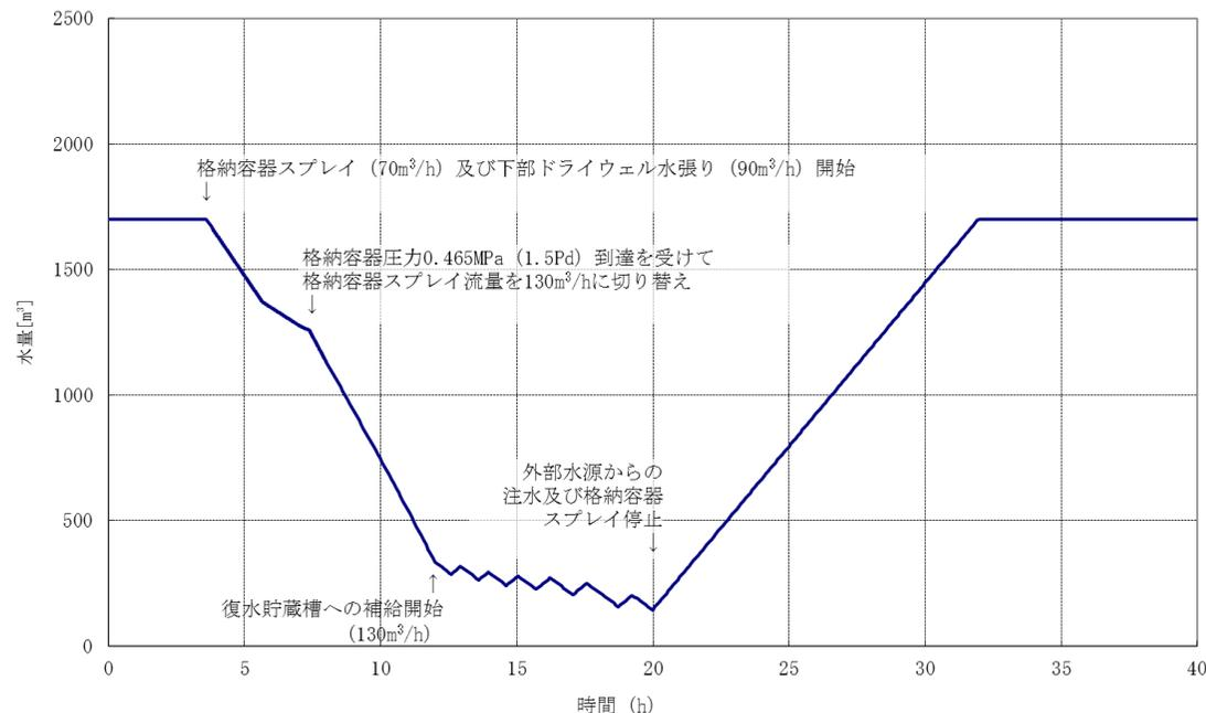
7日間における燃料の対応について(高压溶融物放出/格納容器雰囲気直接加熱)
