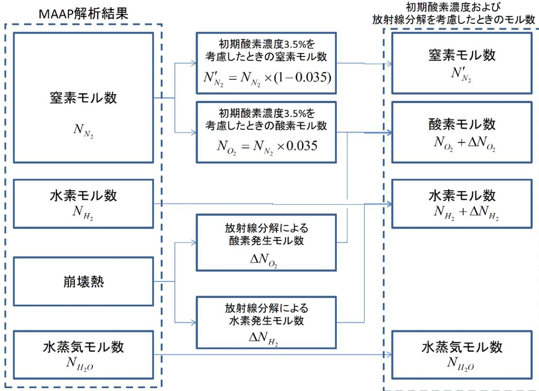
図 11 水素・酸素濃度の評価フロー図
