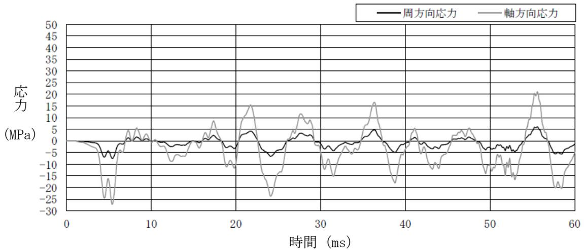
図5 外側鋼板の周方向及び軸方向応力の推移<sup>※1</sup>
