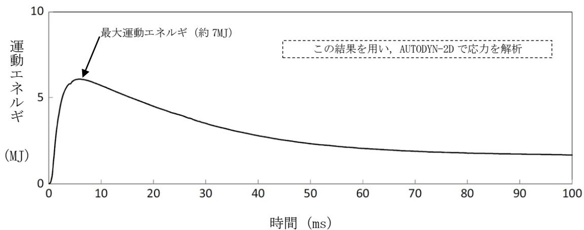
図1 水蒸気爆発によるエネルギーの推移<sup>※1</sup>
