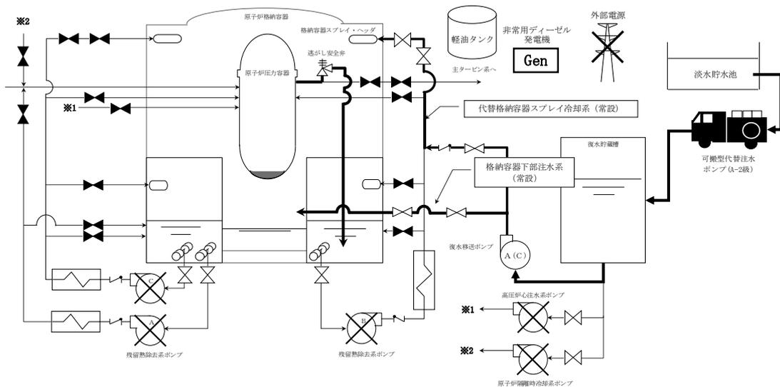
第 3.2.2 図 「高圧溶融物放出／格納容器雰囲気直接加熱」の重大事故等
