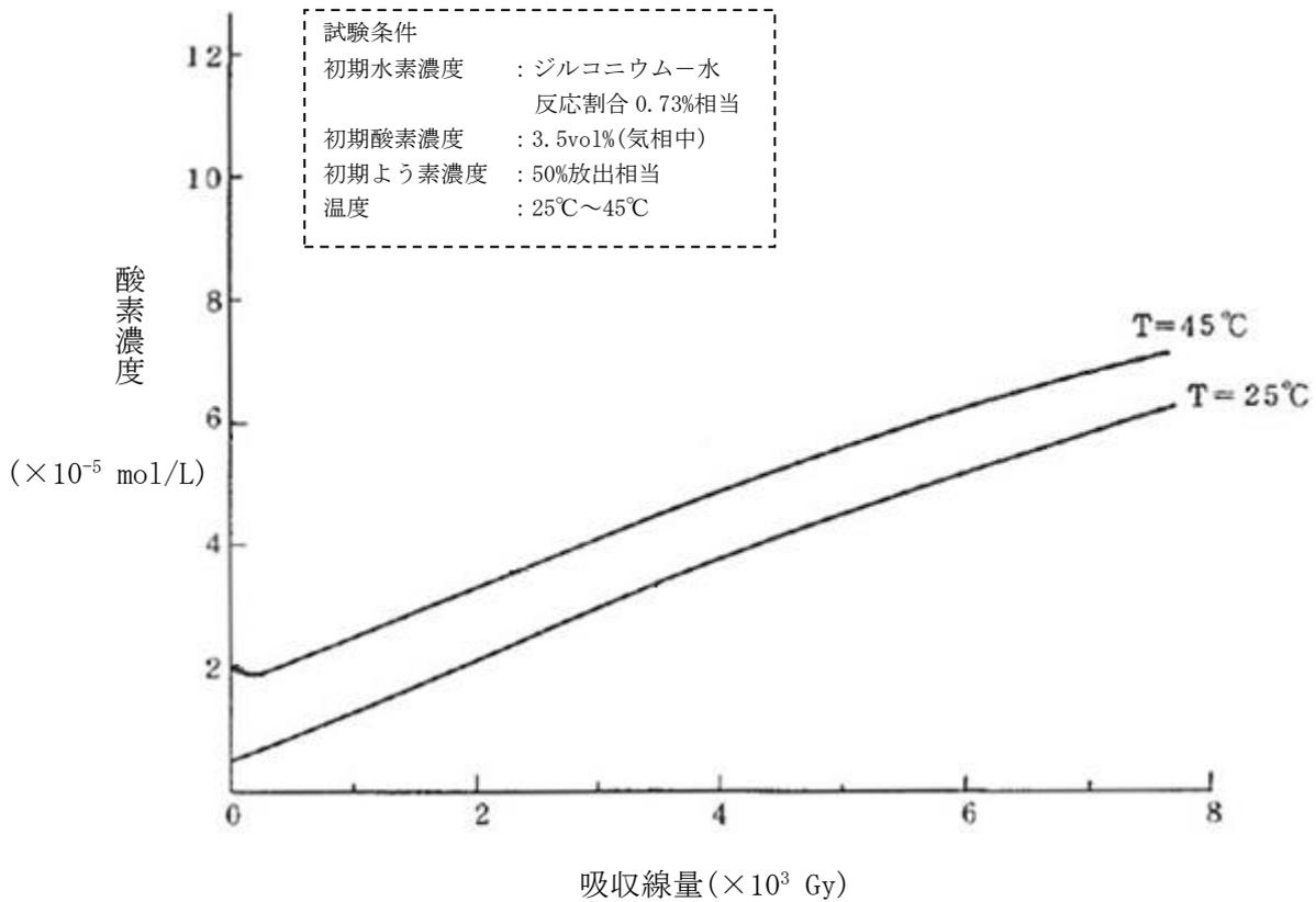
図6 溶存酸素濃度と吸収線量の関係(温度を変化させた場合)
