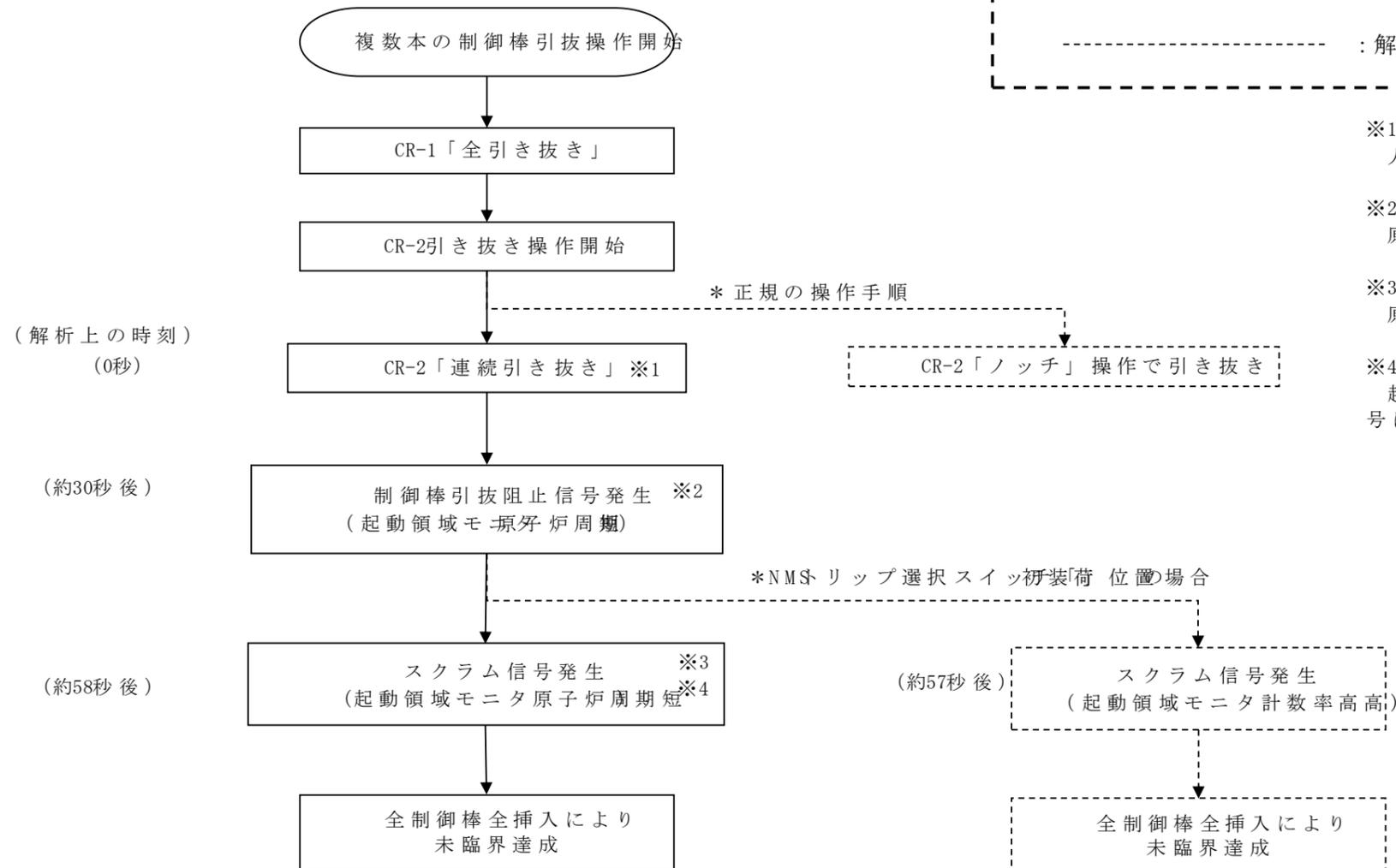
第 5.4.1 図 「反応度の誤投入」の対応手順の概要
