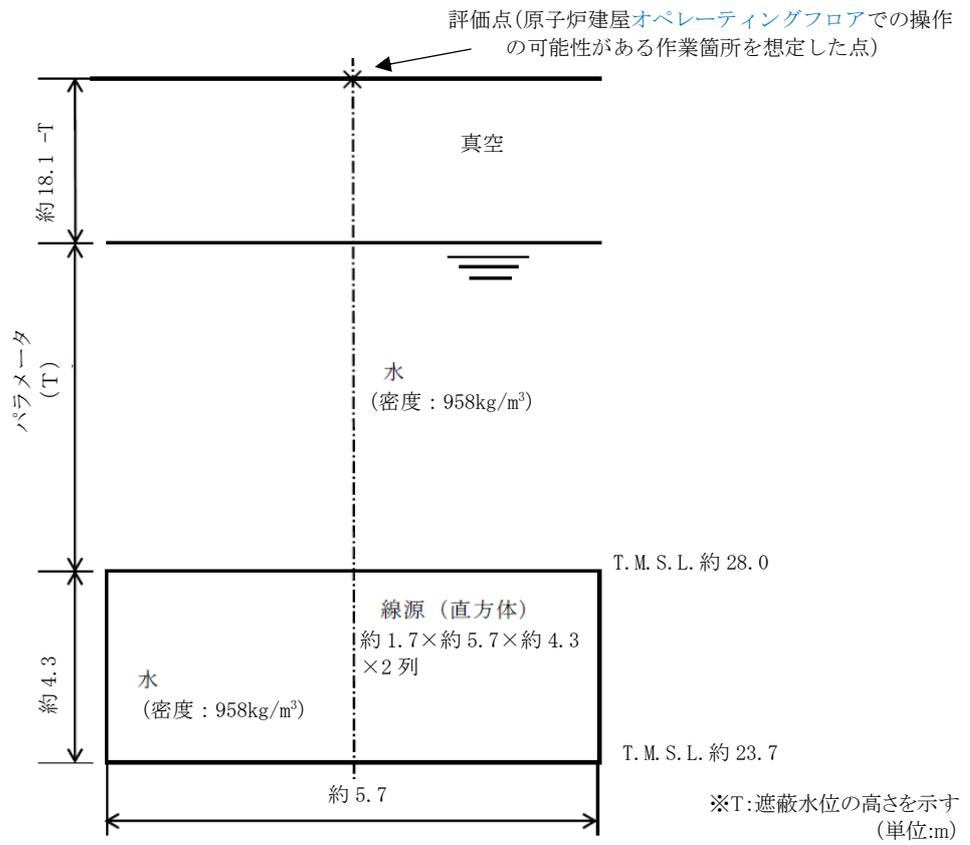
図 2 使用済制御棒の線量率評価モデル
