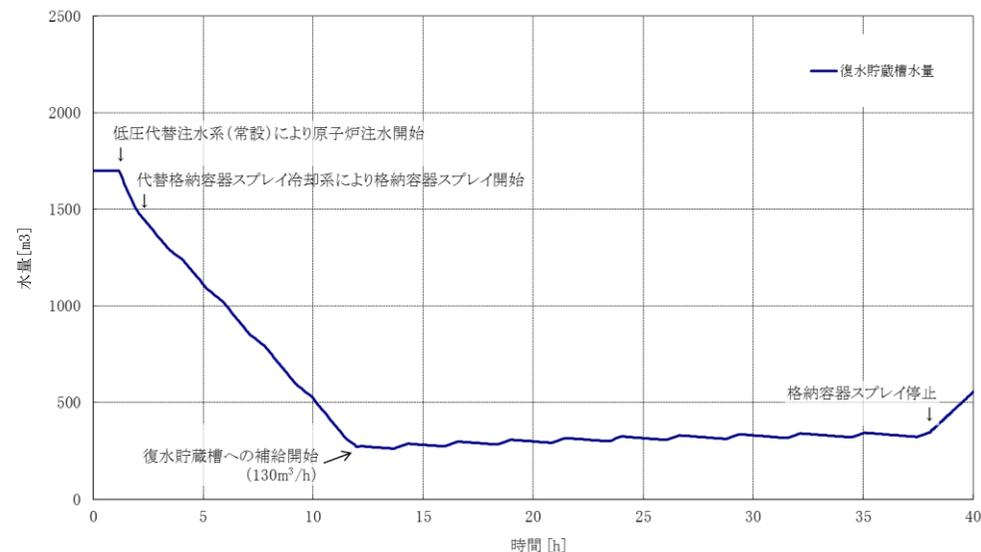
7日間における燃料の対応について（雰囲気圧力・温度による静的負荷（格納容器過圧・過温破損）：代替循環冷却系を使用しない場合）
