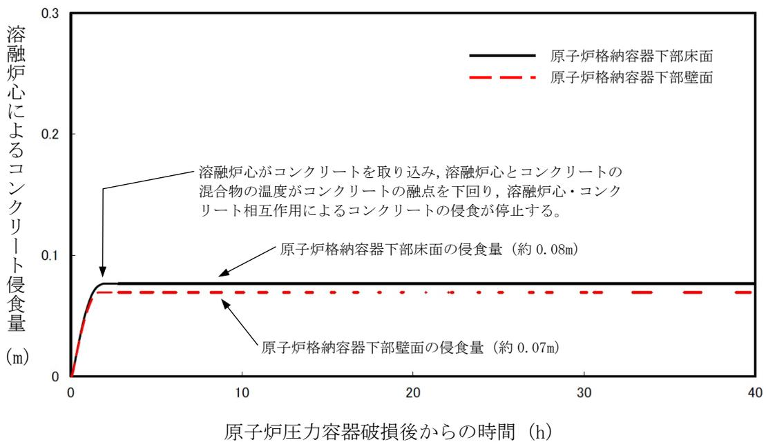
図2 原子炉格納容器下部床面及び壁面のコンクリート侵食量の推移
