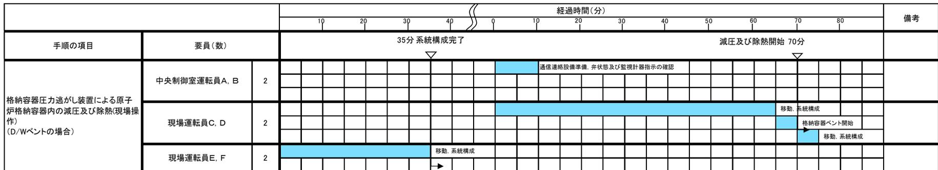
第 1.5.28 図 格納容器圧力逃がし装置による原子炉格納容器内の減圧及び除熱（現場操作） タイムチャート
