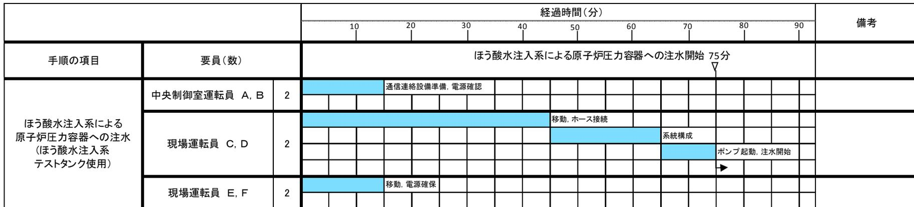
第 1.2.11 図 ほう酸水注入系による原子炉圧力容器へのほう酸水注入及び注水 タイムチャート
