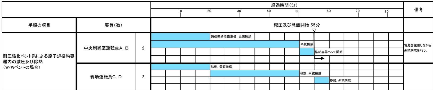
第 1.5.24 図 耐圧強化ベント系による原子炉格納容器内の減圧及び除熱 タイムチャート
