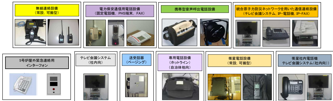
第 11 図 5 号炉原子炉建屋内緊急時対策所の 通信連絡設備に関わる耐震措置の概要
