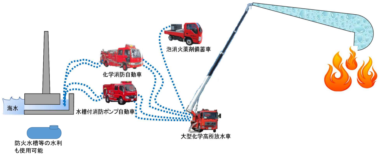
大型化学高所放水車による泡消火の例
