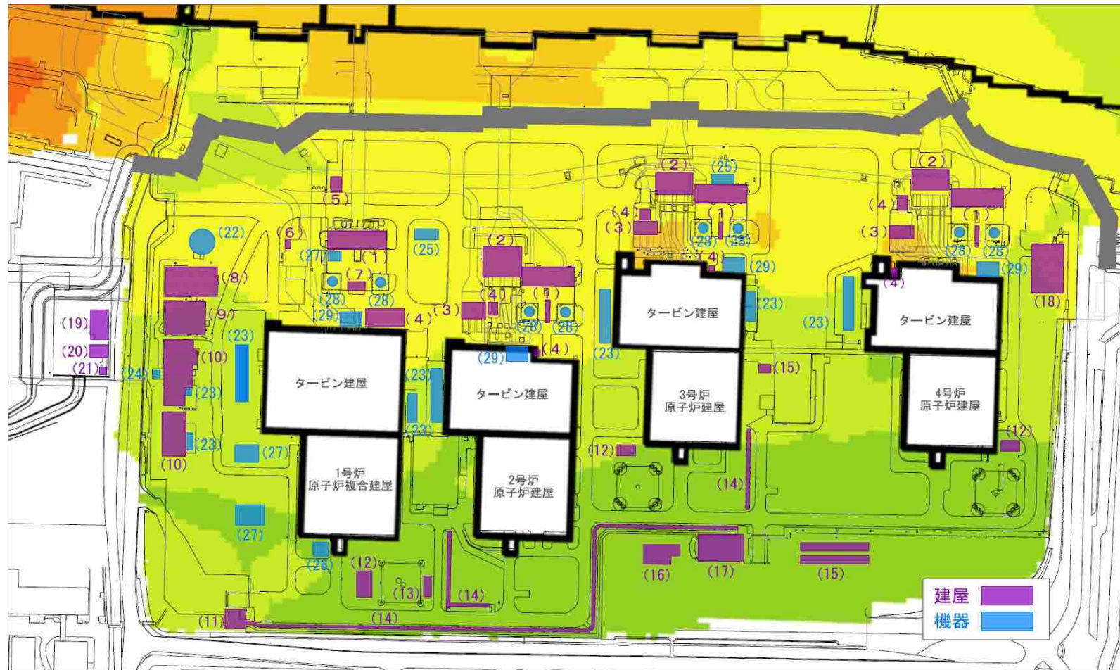
第 2.5-14-4-2 図 漂流物調査結果（発電所構内荒浜側防潮堤内敷地詳細）
