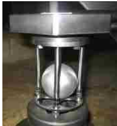
第 4.2-17 図 フロート式止水治具の外観及び構造例
