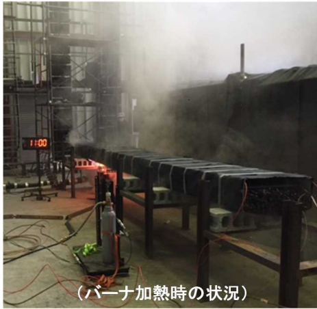
第 14 図：加熱時及び消火後の状態
