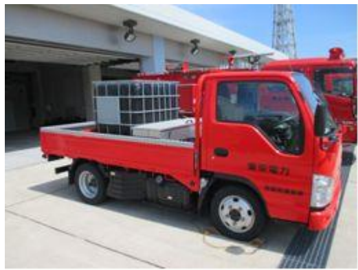
泡消火薬剤備蓄車
