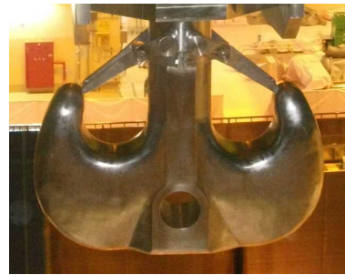
第 5.2.27 図 ワイヤロープ2重化構造及び主巻フック構造（6号炉）
