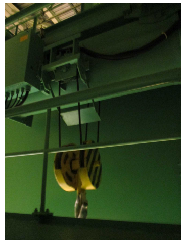
第 5.2.32 図 過巻防止用リミットスイッチ (補助ホイスト巻上装置) (7号炉)
