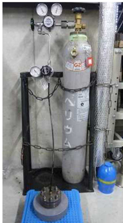
図 12 He 気密確認試験状況
