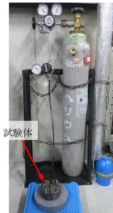
図5 He 気密確認試験状況
