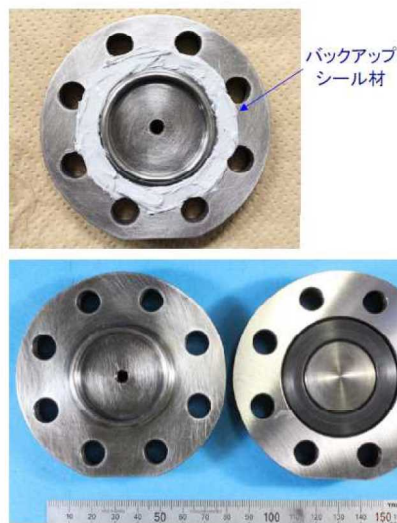
図4 - 19 「改良EPDM+バックアップシール材」 組合せ試験装置
