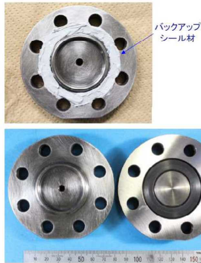
図3-13 「改良EPDM+バックアップシール材」組合せ試験装置
