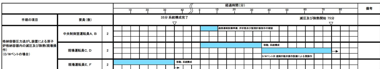
図 3.7-3 格納容器圧力逃がし装置による原子炉格納容器内の減圧及び除熱タイムチャート (ドライウェルベントの場合) *
