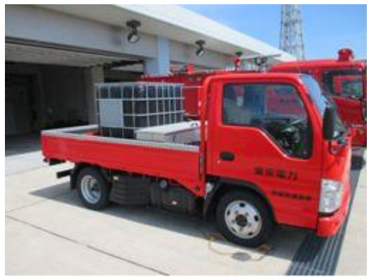
泡消火薬剤備蓄車
