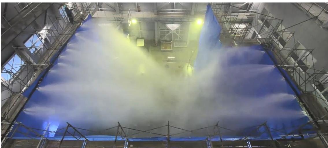
図 13 スプレー状態の試験状況（スプレー量：132m<sup>3</sup>/h）
