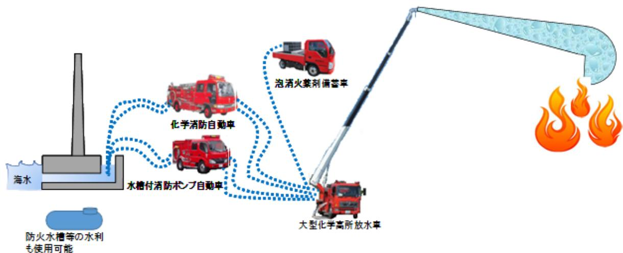
図 8-1 大型化学高所放水車による泡消火
