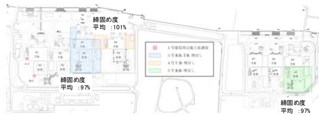
埋戻土の締固め度 (建屋周辺)
