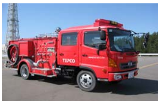
③可搬型代替注水ポンプ（A-1 級消防車）
