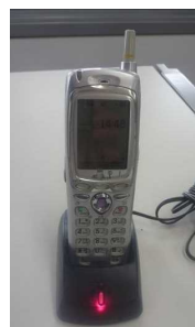
電力保安通信用電話設備 （PHS端末）
