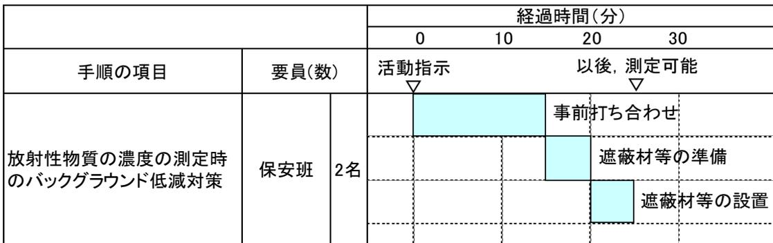
第 1.17.14 図 放射性物質の濃度の測定時のバックグラウンド低減対策の
