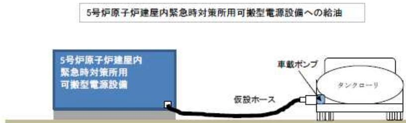
第 1.18.29 図 5号炉原子炉建屋内緊急時対策所用可搬型電源設備
