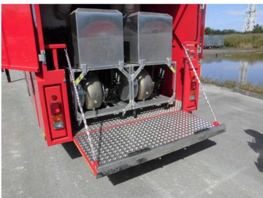
大容量送水車（原子炉建屋放水設備用）取水ポンプ
