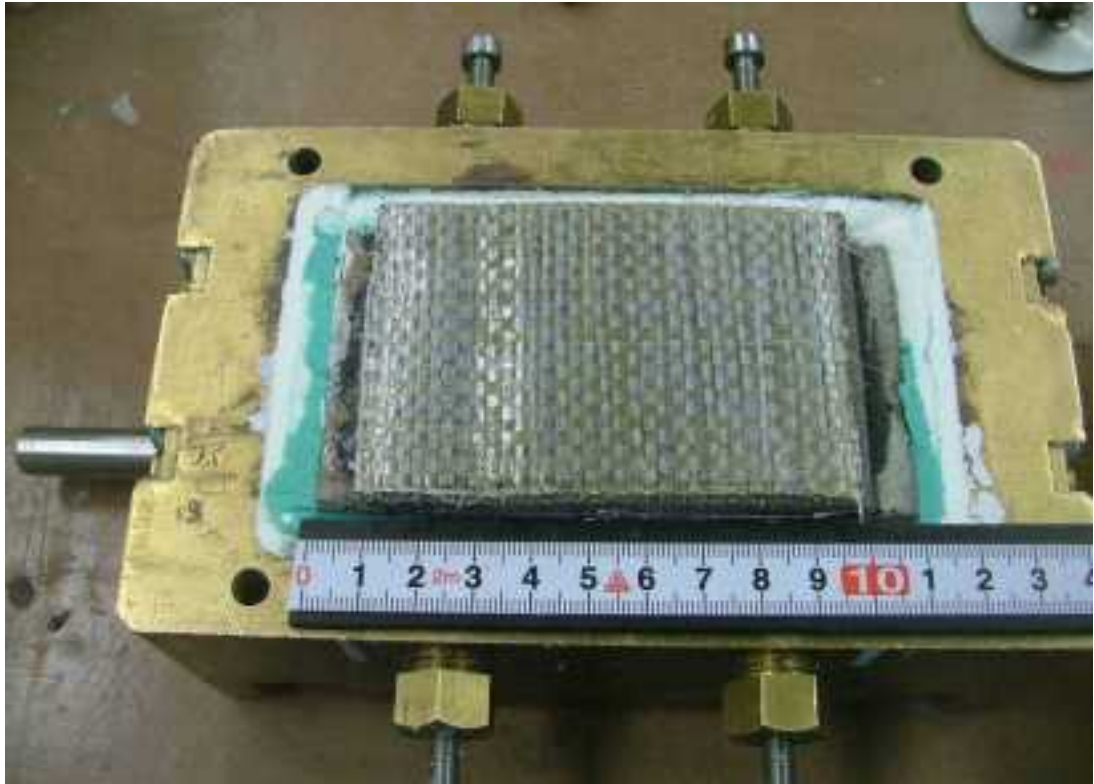
第 3.3.15 図 繰返し载荷試験後の供試体状況 ケース 1-6 (保護層表面)
