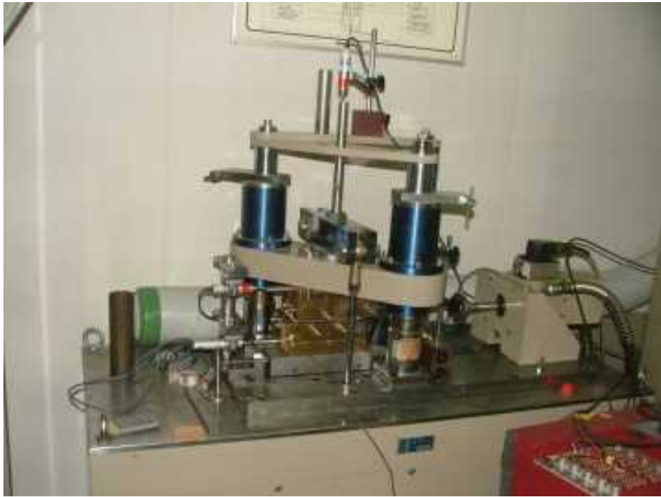
第 3.2.6 図 一面せん断試験装置全景
