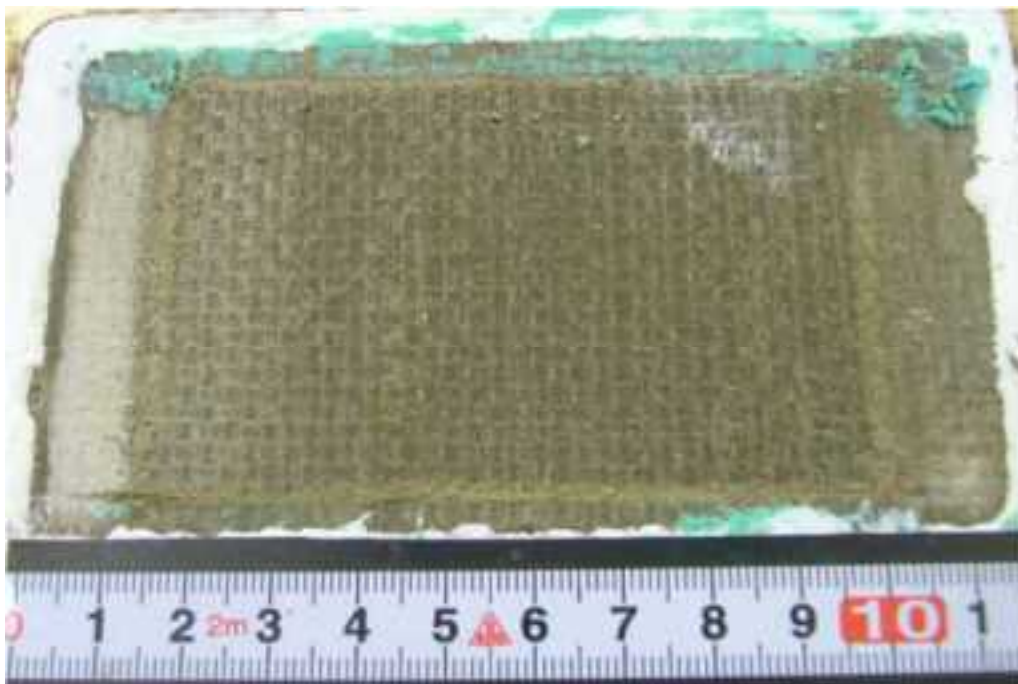
第 3.3.8 図 一方向載荷試験後の供試体状況 ケース 1-3 (西山モルタル表面)
