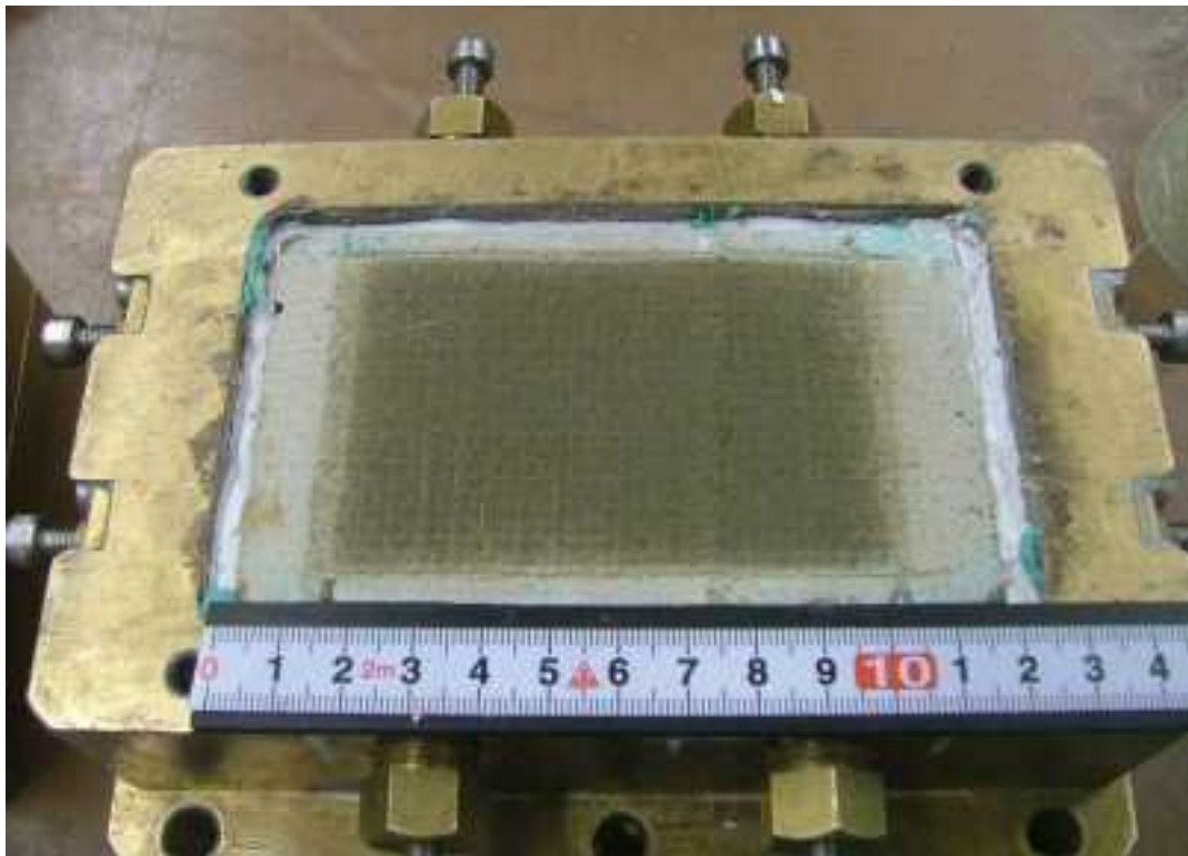
第 3.3.14 図 繰返し載荷試験後の供試体状況 ケース 1-5 (西山モルタル表面)
