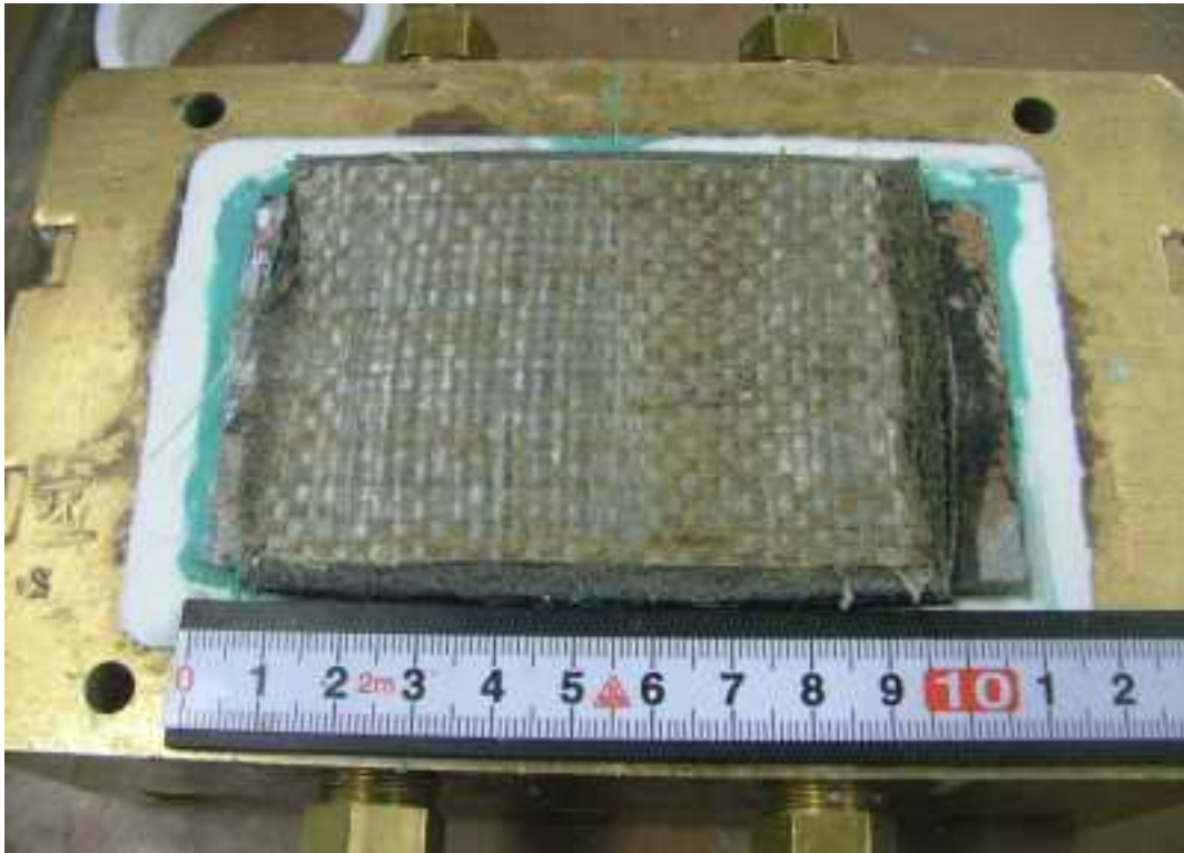
第 3.3.17 図 繰返し載荷試験後の供試体状況 ケース 1-7 (保護層表面)
