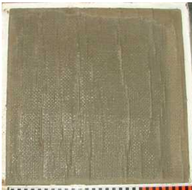
第 3.4.14 図 スケール影響試験後の供試体状況 ケース 2-6 (西山モルタル表面)
