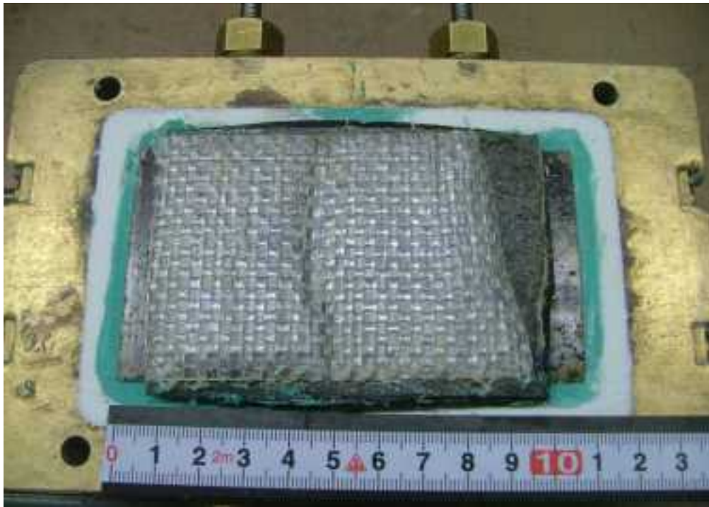
第 3.3.9 図 一方向載荷試験後の供試体状況 ケース 1-4 (保護層表面)
