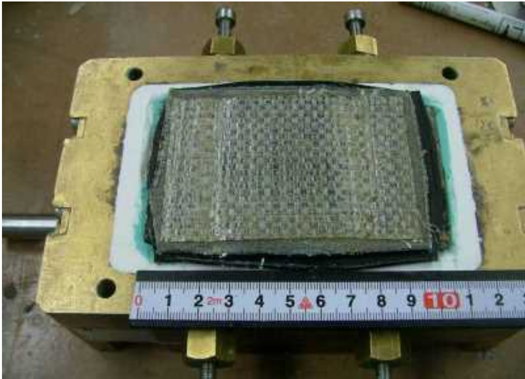
第 3.3.19 図 繰返し載荷試験後の供試体状況 ケース 1-8 (保護層表面)
