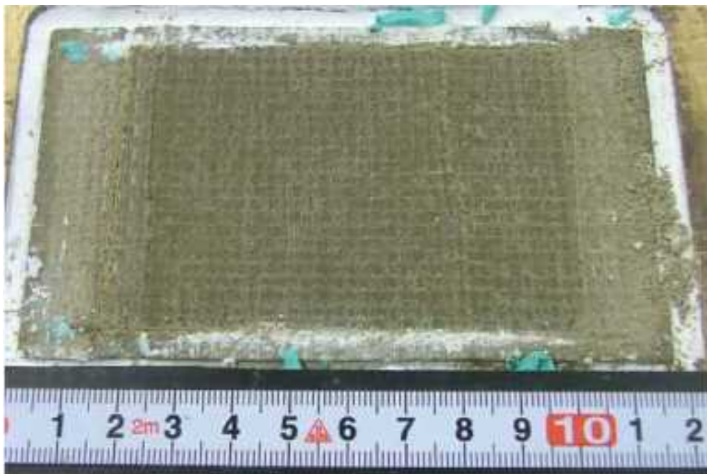
第 3.3.6 図 一方向載荷試験後の供試体状況 ケース 1-2 (西山モルタル表面)
