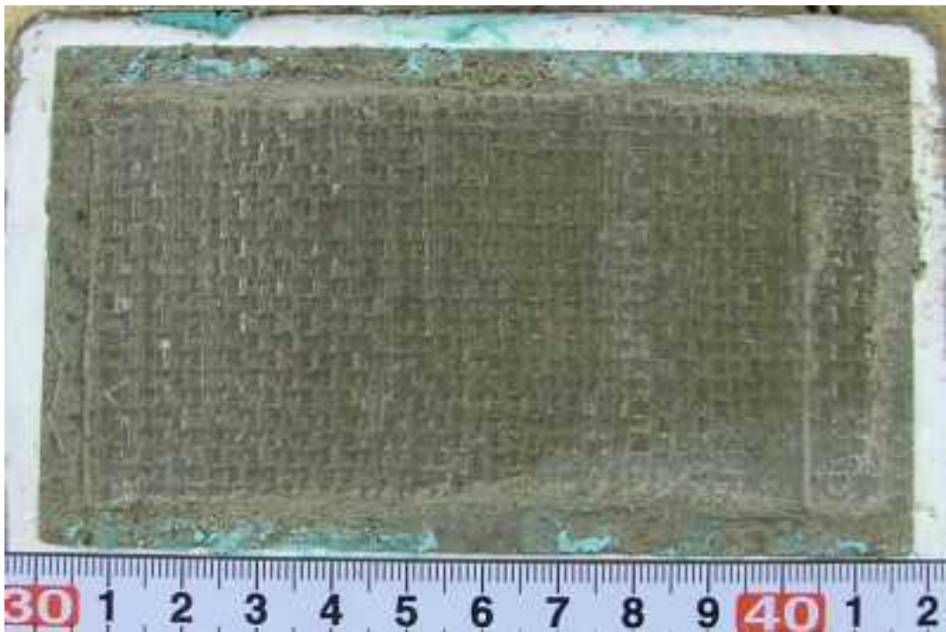
第 3.4.6 図 スケール影響試験後の供試体状況 ケース 2-2 (西山モルタル表面)
