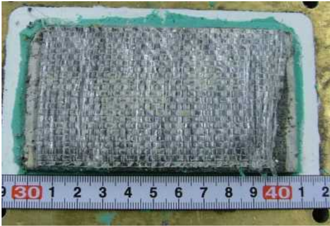
第 3.4.3 図 スケール影響試験後の供試体状況 ケース 2-1 (保護層表面)
