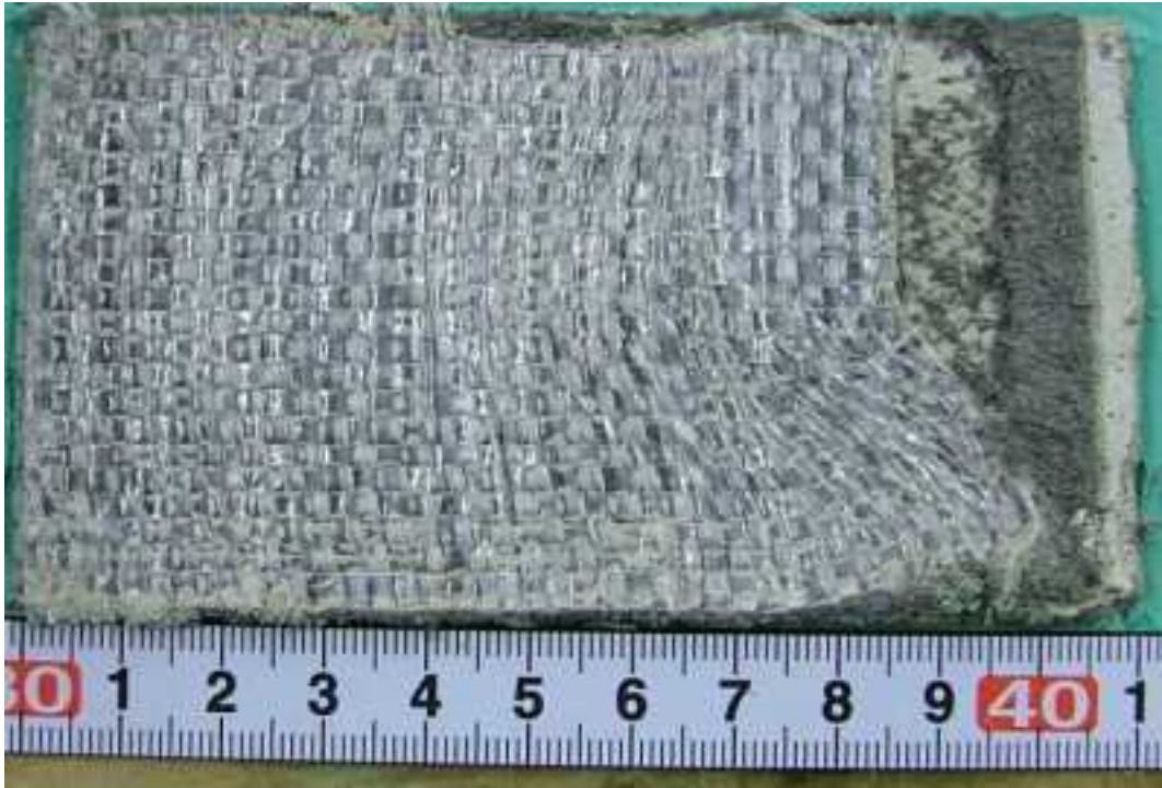
第 3.4.5 図 スケール影響試験後の供試体状況 ケース 2-2 (保護層表面)
