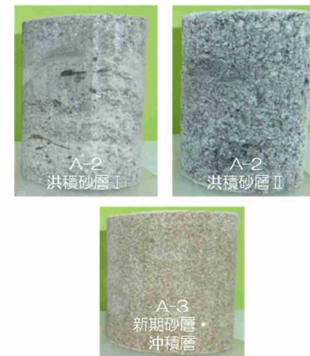
試験供試体例 (左上：洪積砂層 I 右上：洪積砂層 II 下：新期砂層・沖積層 )
