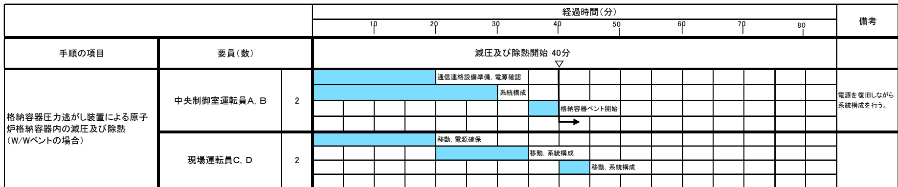
第 1.5.5 図 格納容器圧力逃がし装置による原子炉格納容器内の減圧及び除熱 タイムチャート (W/W ベントの場合)
