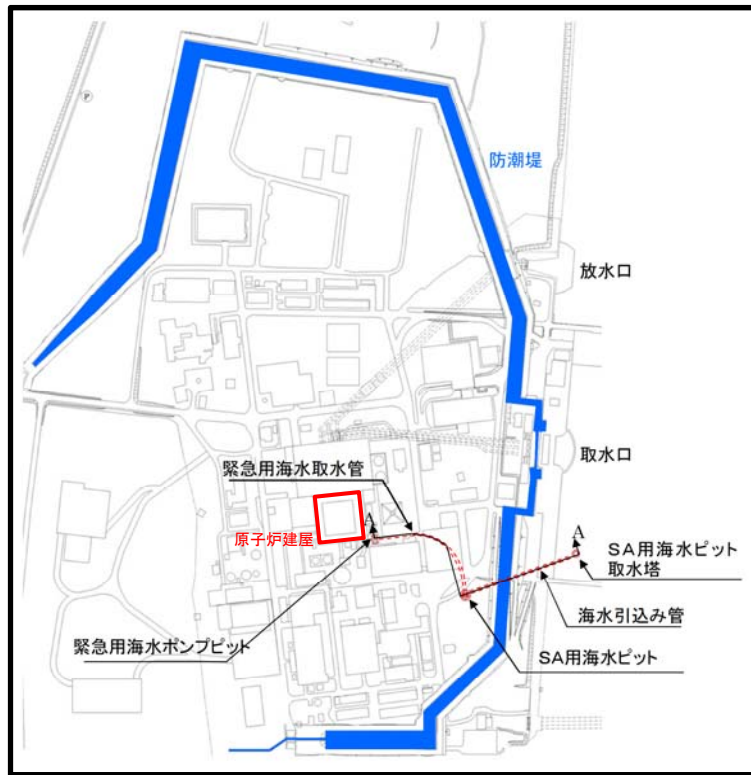
【緊急用海水ポンプピット配置図】
